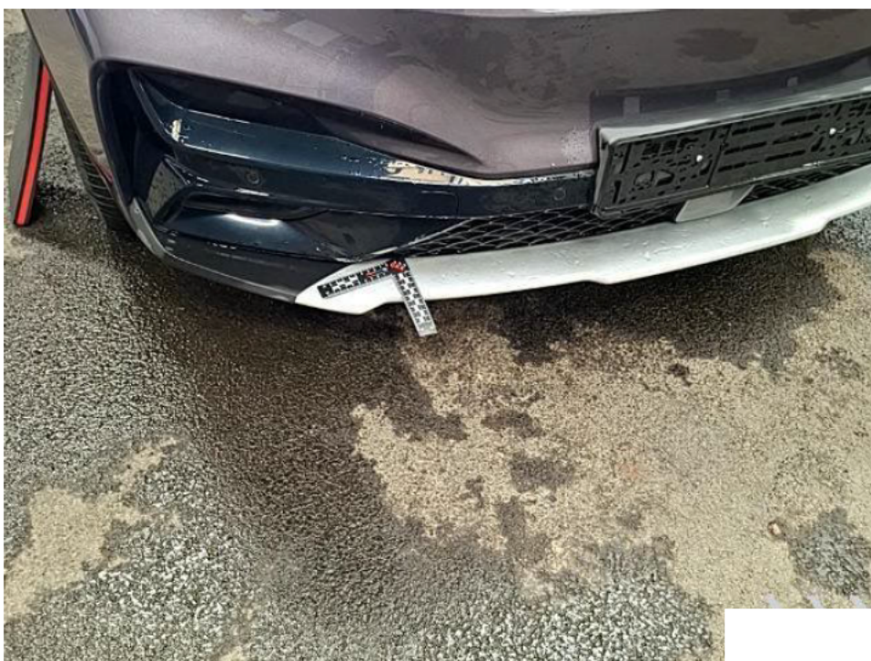
Bild 20 Minderwert: 60,00 EUR Stoßfänger vorne, Unterfahrschutz, Steinschlag, auslegen, schleifen, polieren
