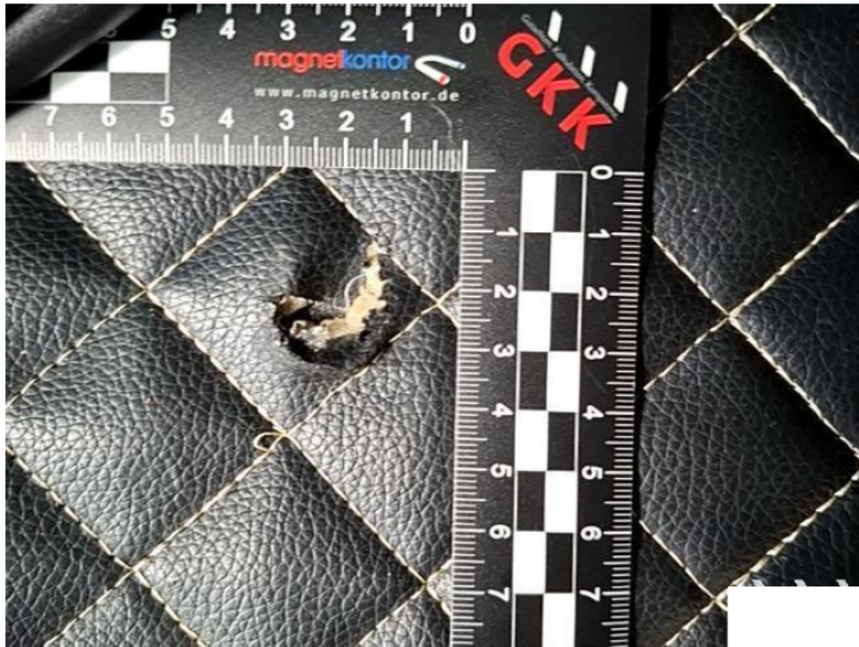
Bild 25 Minderwert: 28,68 EUR Laderaum, Schutzmatte, beschädigt, ersetzen
