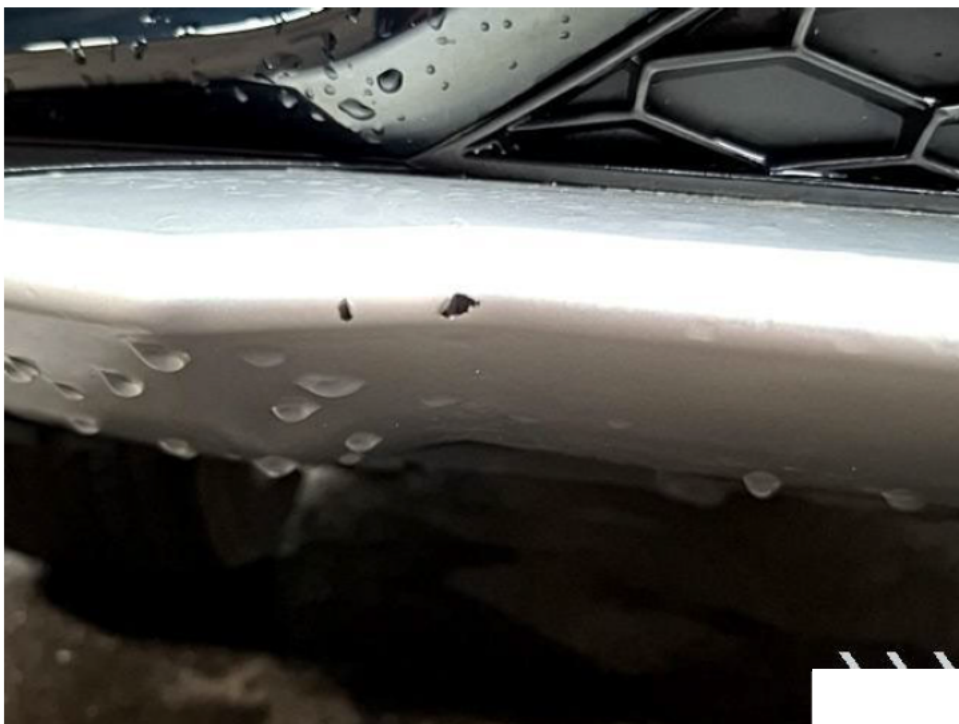
Bild 22 Minderwert: 60,00 EUR Stoßfänger vorne, Unterfahrschutz, Steinschlag, schleifen, polieren
