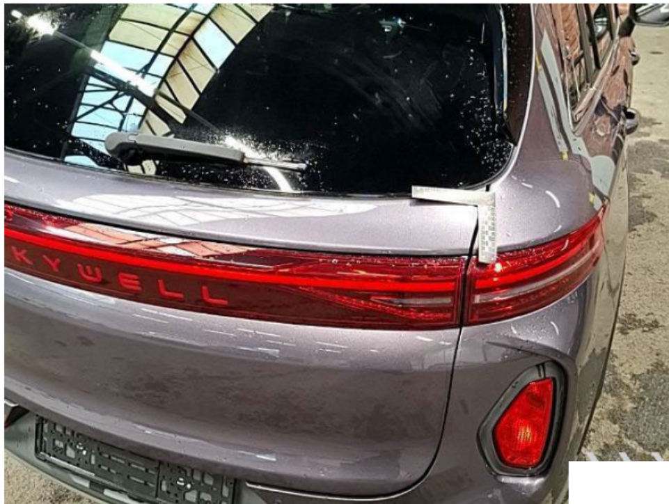
Bild 26 Minderwert: 80,00 EUR Heckklappe, bis 3 Dellen / Bauteil, kalt drücken
