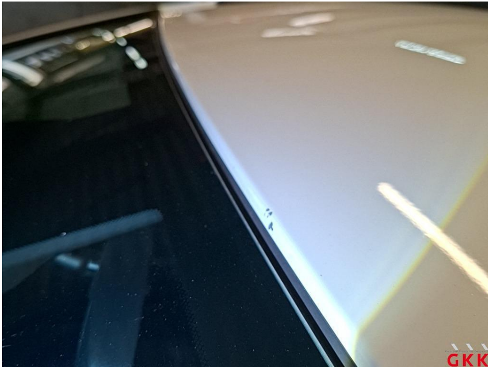
Bild 25 Dach, vorne, Steinschlag, Smartrepair
