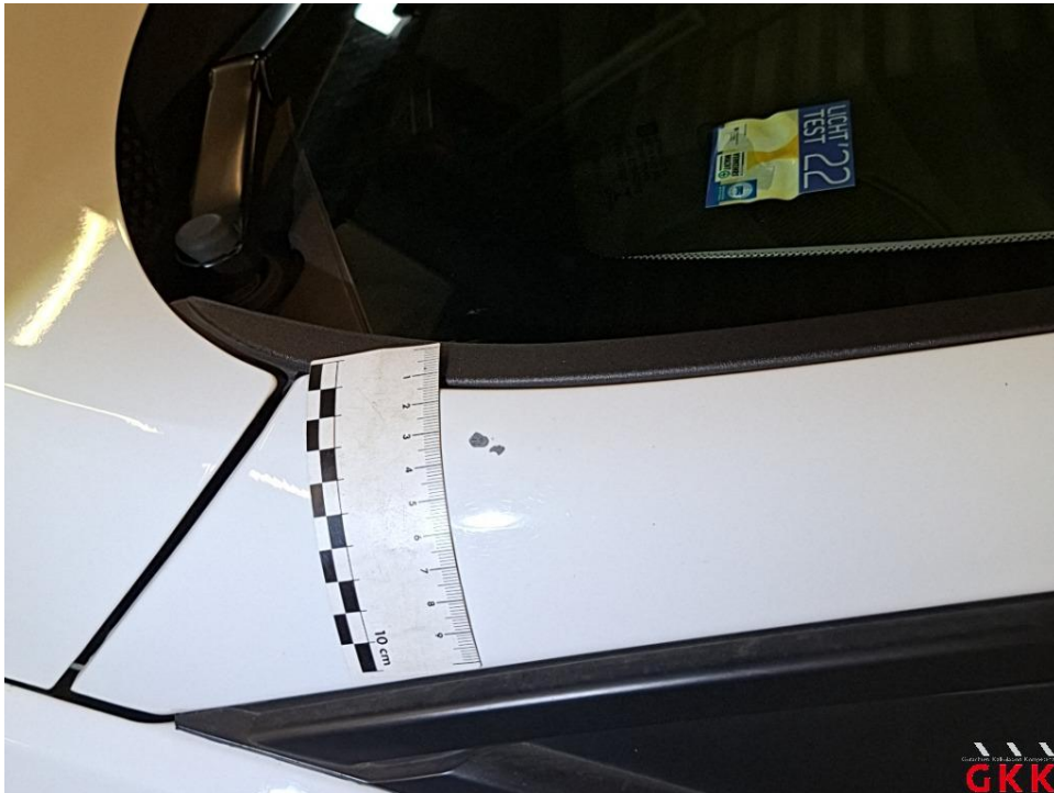
Bild 23 A- Säule links, Lackierung abgeplatzt, lackieren
