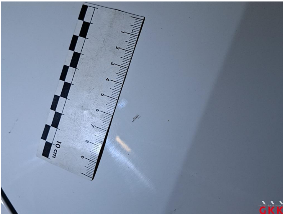
Bild 22 Motorhaube, Steinschlag und Kratzer, lackieren
