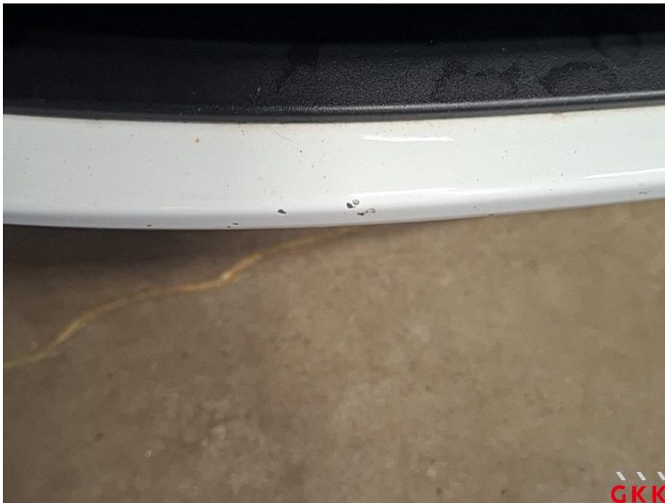
Bild 20 Stoßfänger vorne, Verkleidung -lackiert-, Steinschlag, lackieren
