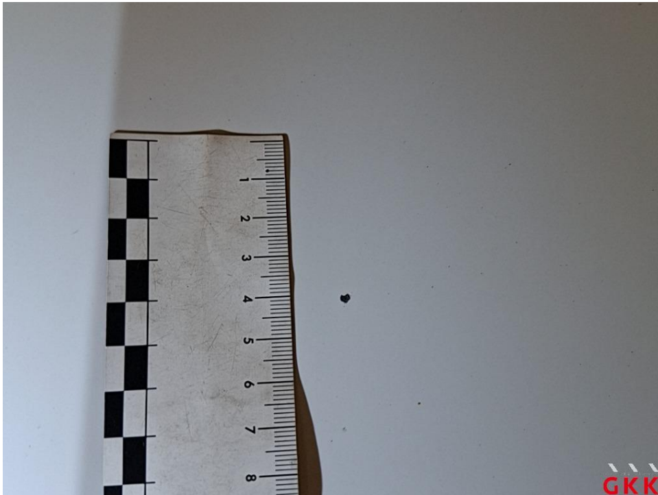
Bild 21 Motorhaube, Steinschlag und Kratzer, lackieren
