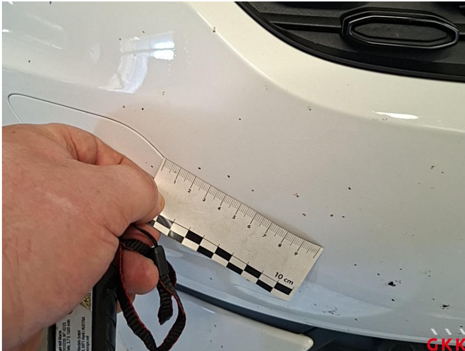
Bild 19 Stoßfänger vorne, Verkleidung -lackiert-, Steinschlag, lackieren
