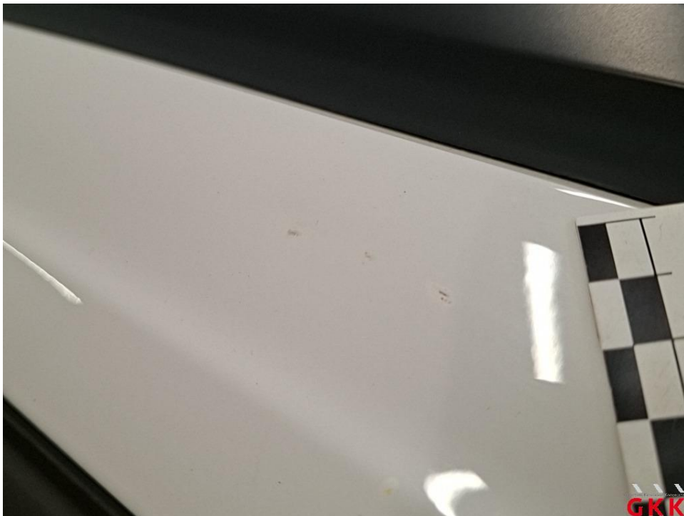
Bild 34 Dach, Holm links, beschädigt, instand setzen - lackieren
