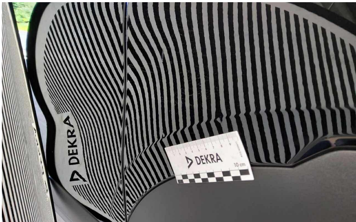
Bild 2 : Kotflügel vorne rechts, eingedellt, drücken
