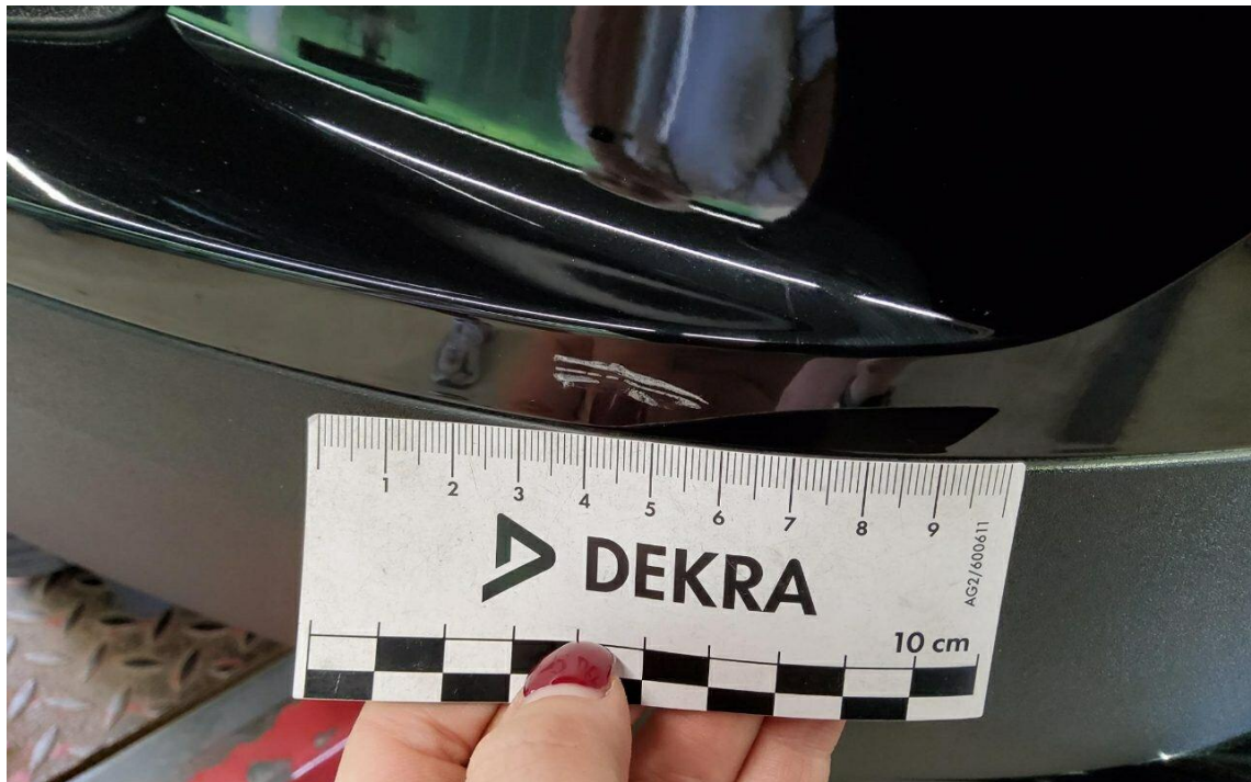
Bild 1 : Stoßfänger vorne Lackierung, zerkratzt, lackieren
