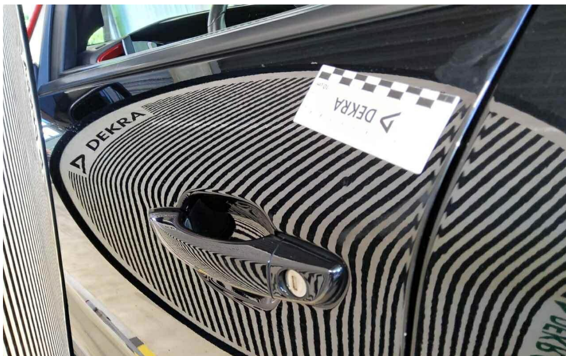
Bild 6 : Tür vorne links, eingedellt, drücken
