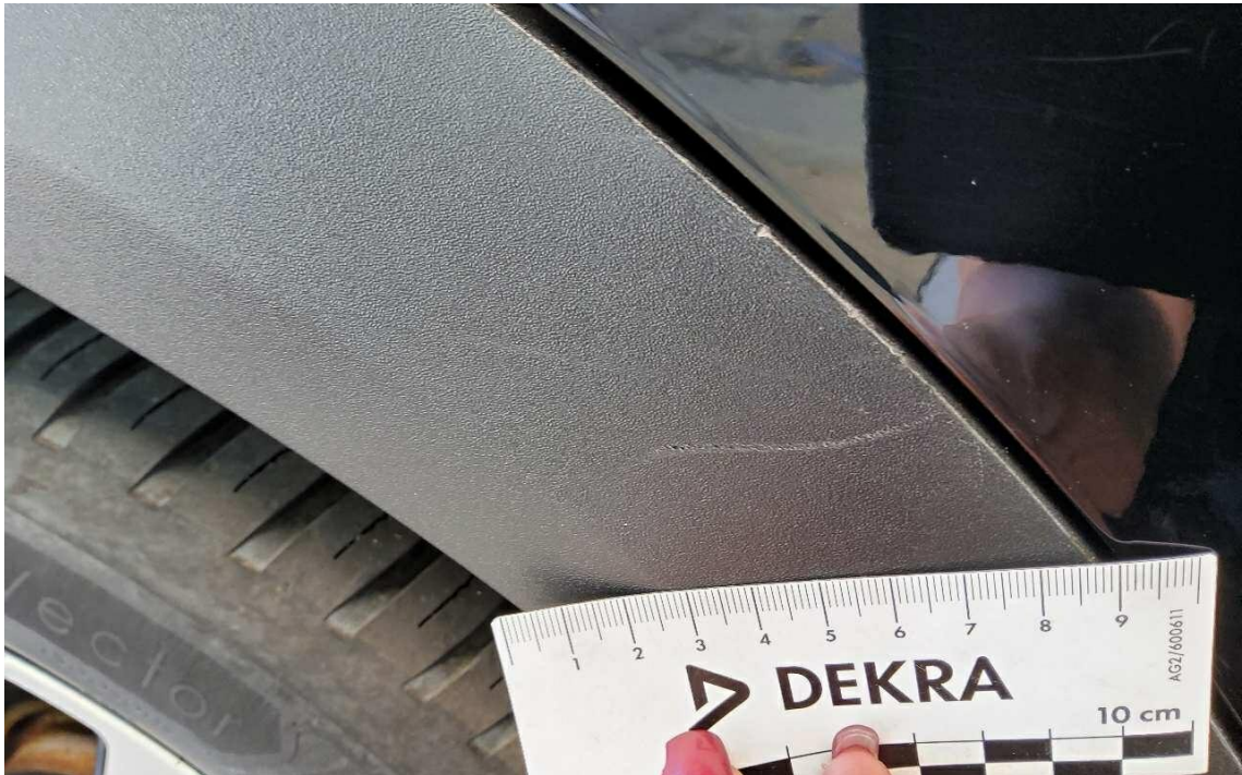
Bild 9 : radlaufblende hinten rechts zerkratzt
