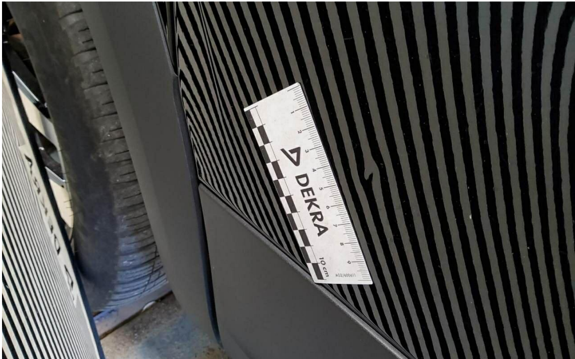
Bild 7 : Tür vorne links, eingedellt, drücken
