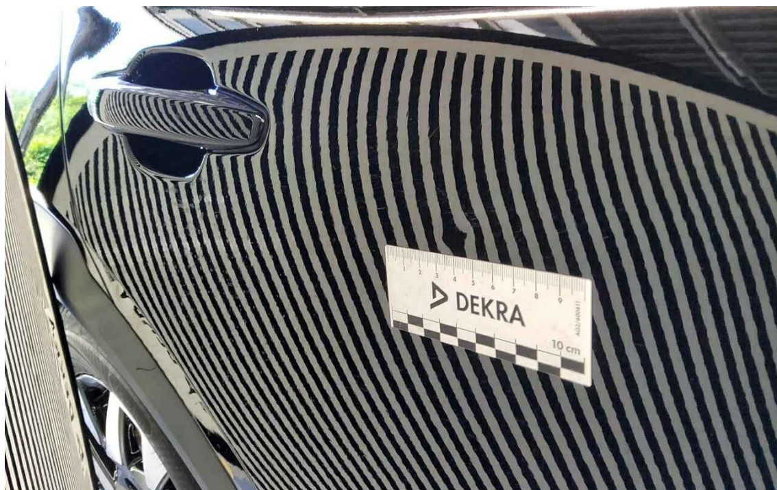
Bild 3 : Tür hinten rechts, eingedellt, drücken
