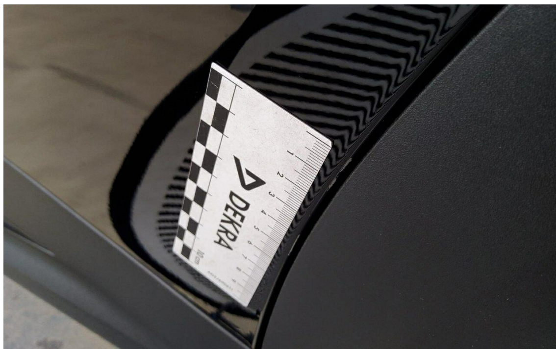
Bild 4 : Tür hinten links Türkante, zerkratzt, Gebrauchsspur
