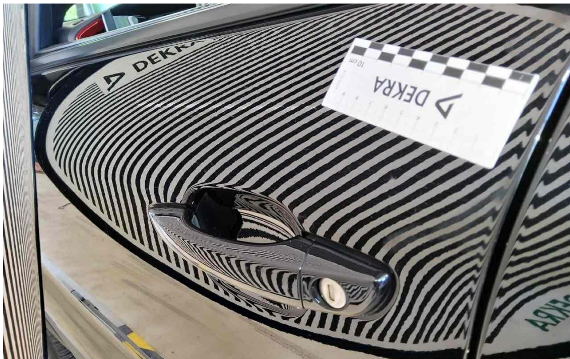
Bild 5 : Tür vorne links, eingedellt, drücken
