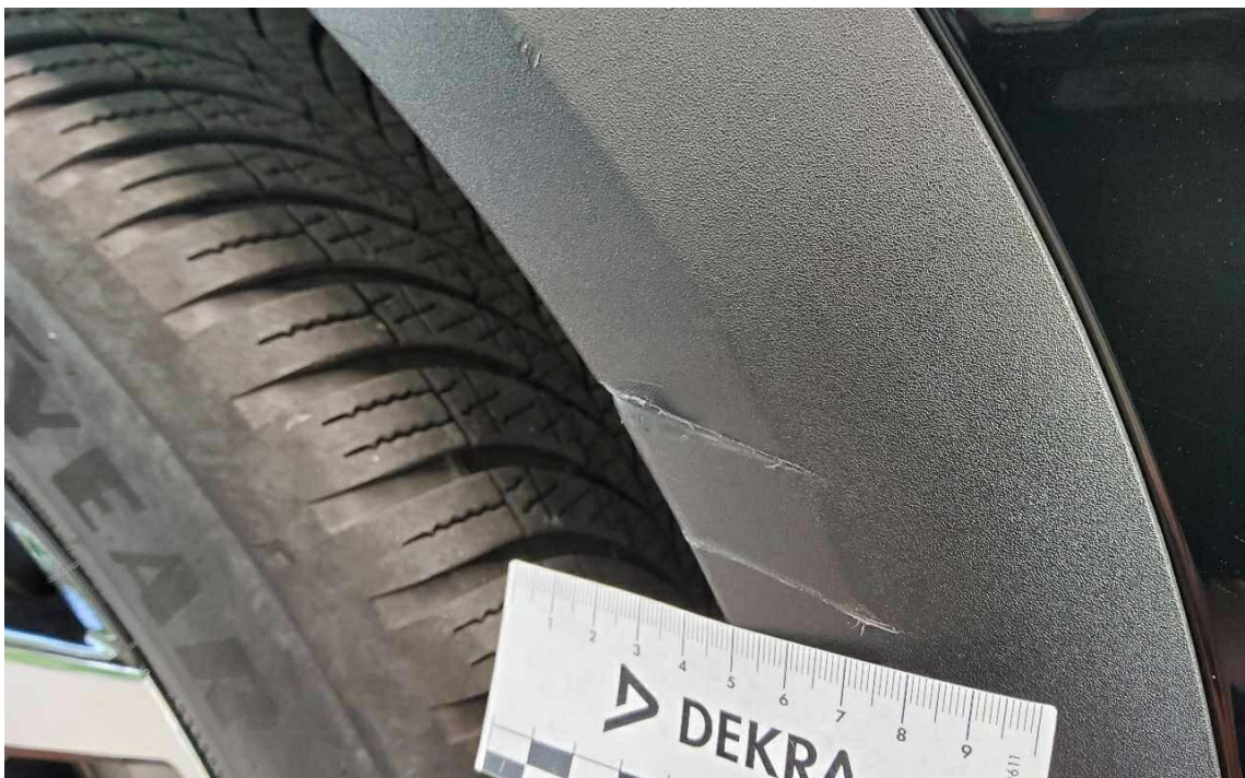
Bild 8 : Radlaufblende vorne rechts zerkratzt
