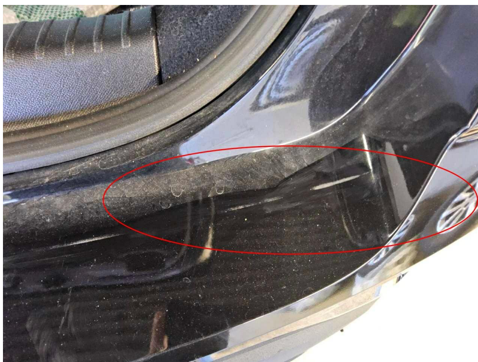
Bild 16 : Stoßfänger hinten Lackierung, verschrammt, lackieren mit Lackaufbau
