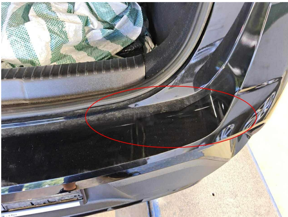
Bild 18 : Stoßfänger hinten Lackierung, verschrammt, lackieren mit Lackaufbau
