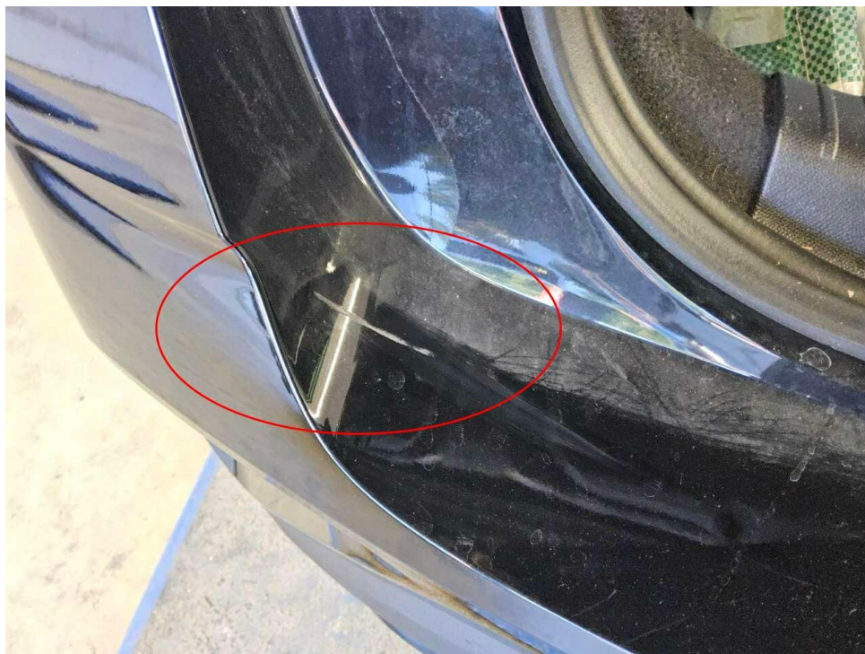
Bild 15 : Stoßfänger hinten Lackierung, verschrammt, lackieren mit Lackaufbau
