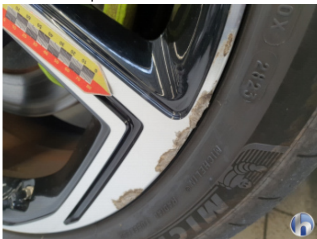
2. Felge Hinten - Rechts Beschädigt - Smart Repair
