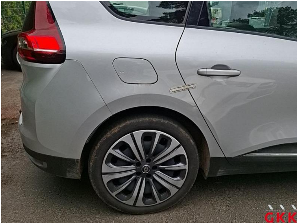
Bild 42. Seitenwand rechts, beschädigt, instand setzen - lackieren
