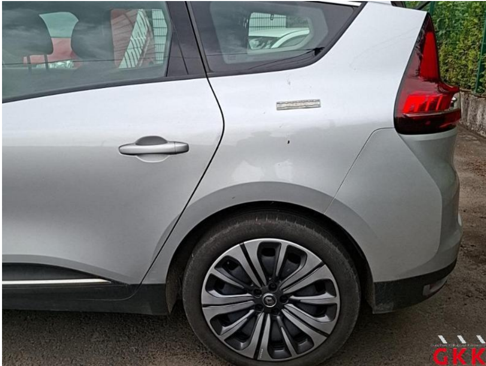
Bild 25. Seitenwand links, beschädigt, instand setzen - lackieren
