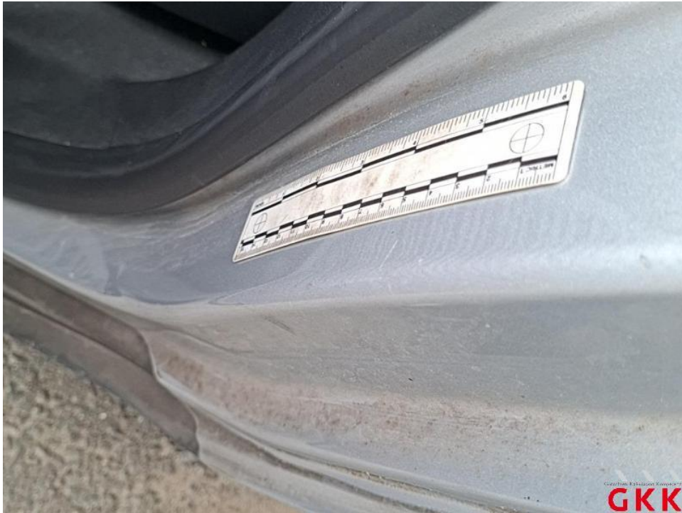
Bild 31. Tür hinten links, Einstieg, beschädigt, Smartrepair
