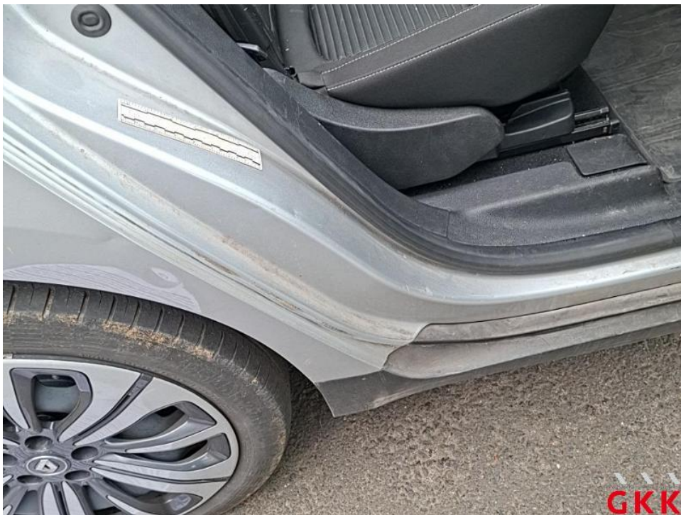
Bild 44. Tür hinten rechts, Einstieg, beschädigt, Smartrepair
