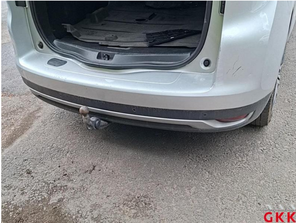
Bild 35. Stoßfänger hinten, Verkleidung oberhalb -lackiert-, beschädigt, ersetzen
