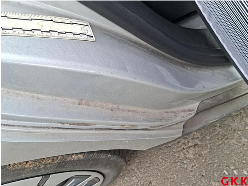
Bild 45. Tür hinten rechts, Einstieg, beschädigt, Smartrepair
