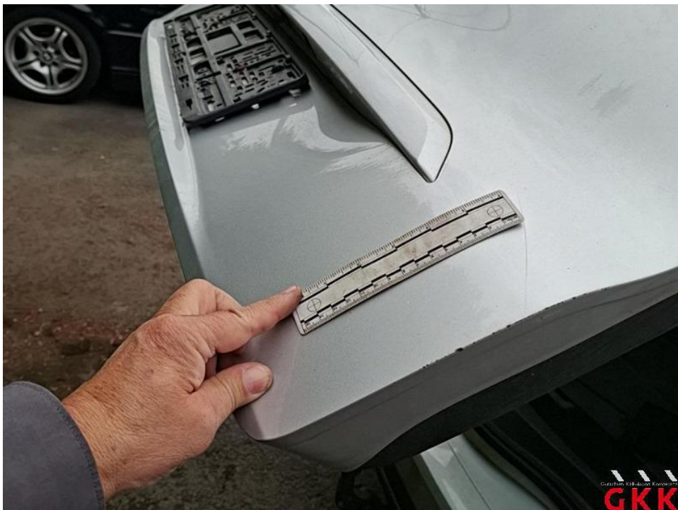
Bild 40. Heckklappe, Blende -lackiert-, verkratzt, lackieren
