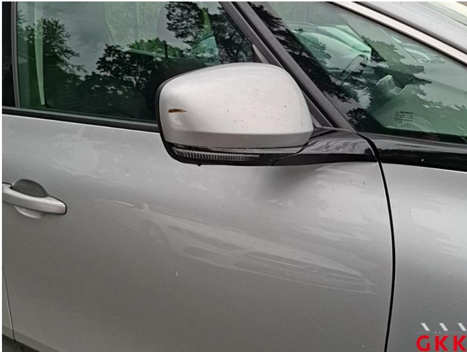
Bild 14. Spiegelgehäuse rechts, Blende -unlackiert-, verkratzt, Smartrepair
