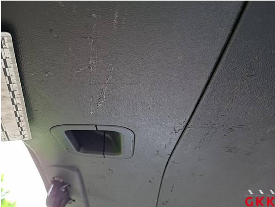
Bild 39. Heckklappe, Innenverkleidung, verkratzt, ersetzen
