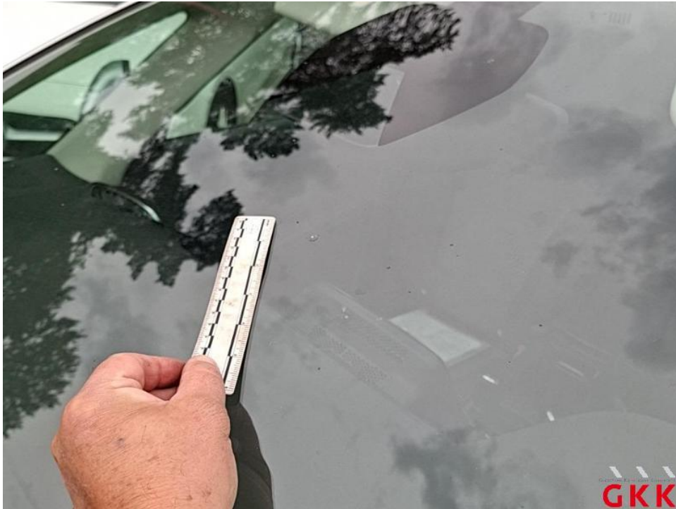
Bild 23. Frontscheibe, wärmedämmend mit Regensensor und Frontkamera, Steinschlag mit Rissbildung, ersetzen
