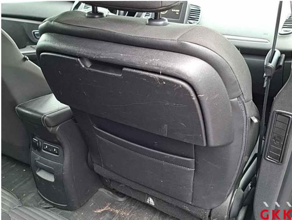
Bild 46. Sitz vorne rechts, Ablagefach, beschädigt, ersetzen
