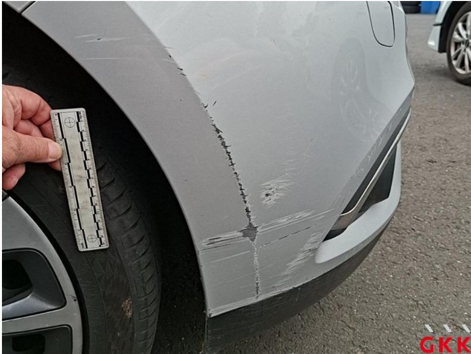
Bild 19. Stoßfänger vorne, Verkleidung -lackiert-, beschädigt, ersetzen
