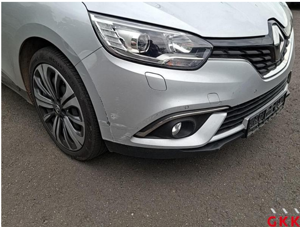
Bild 18. Stoßfänger vorne, Verkleidung -lackiert-, beschädigt, ersetzen
