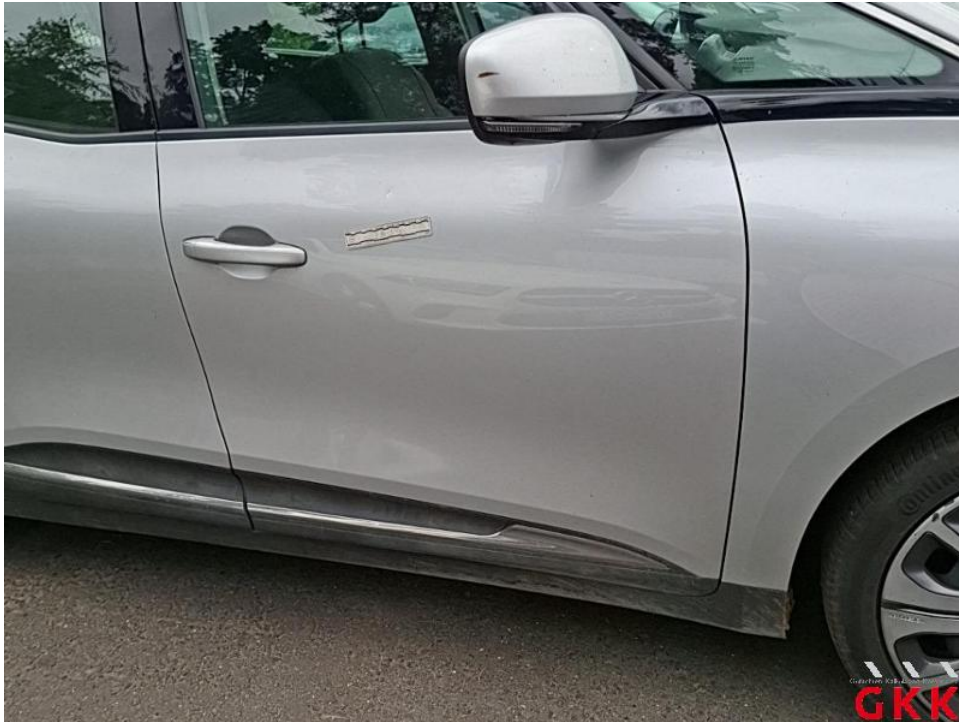
Bild 51. Tür vorne rechts, beschädigt, instand setzen - lackieren
