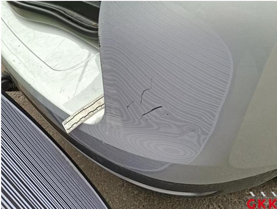
Bild 36. Stoßfänger hinten, Verkleidung oberhalb -lackiert-, beschädigt, ersetzen
