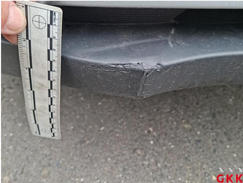
Bild 22. Stoßfänger vorne, Spoiler -unlackiert-, gerissen, ersetzen
