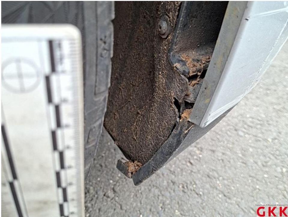
Bild 20. Stoßfänger vorne, Verkleidung -lackiert-, beschädigt, ersetzen
