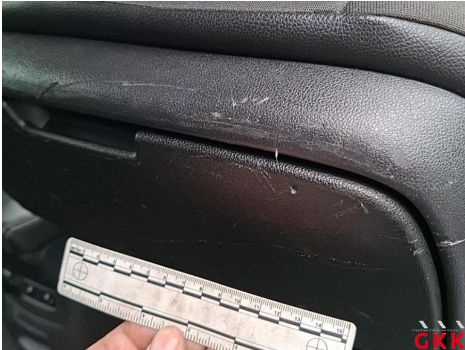
Bild 47. Sitz vorne rechts, Ablagefach, beschädigt, ersetzen
