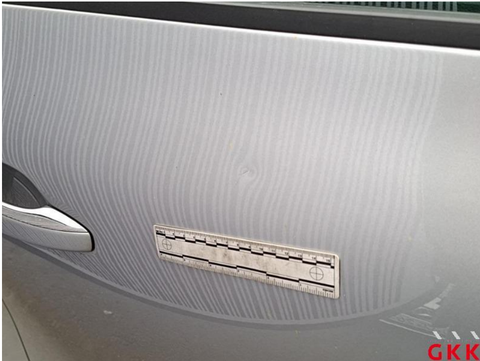
Bild 52. Tür vorne rechts, beschädigt, instand setzen - lackieren
