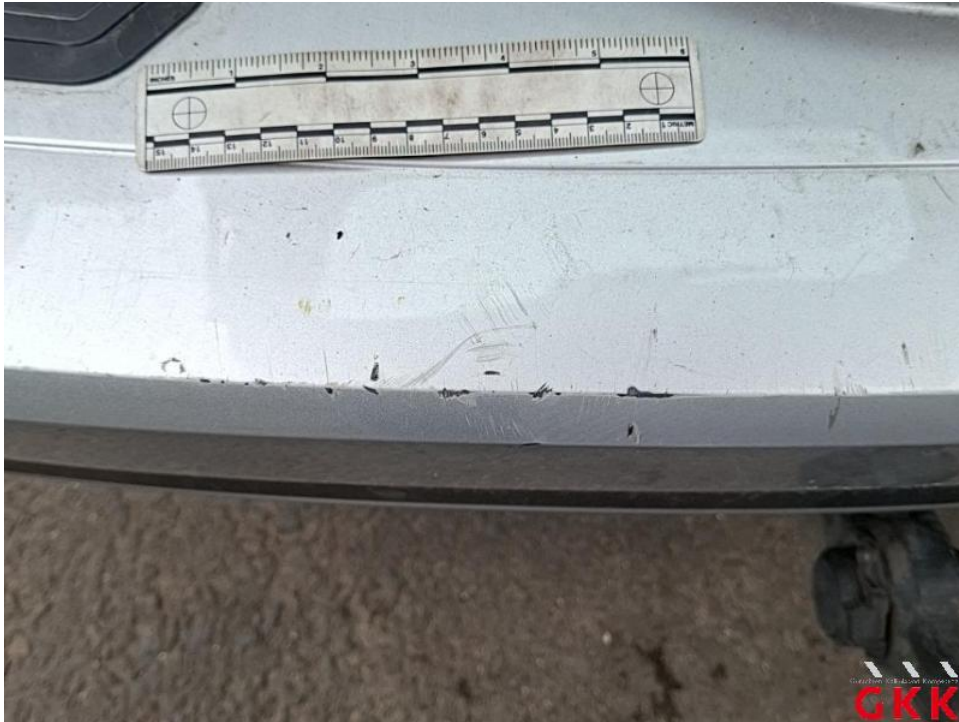
Bild 37. Stoßfänger hinten, Verkleidung oberhalb -lackiert-, beschädigt, ersetzen
