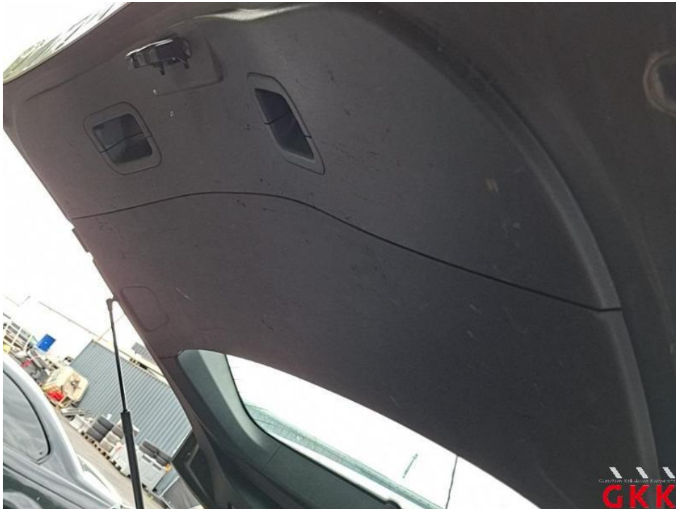
Bild 38. Heckklappe, Innenverkleidung, verkratzt, ersetzen
