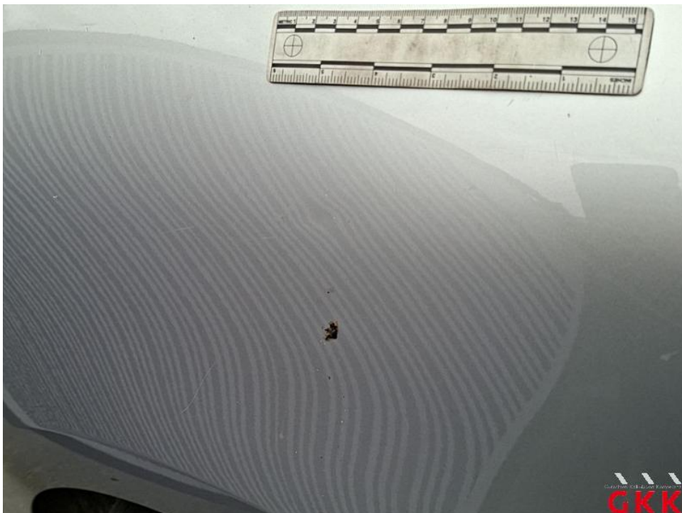
Bild 26. Seitenwand links, beschädigt, instand setzen - lackieren
