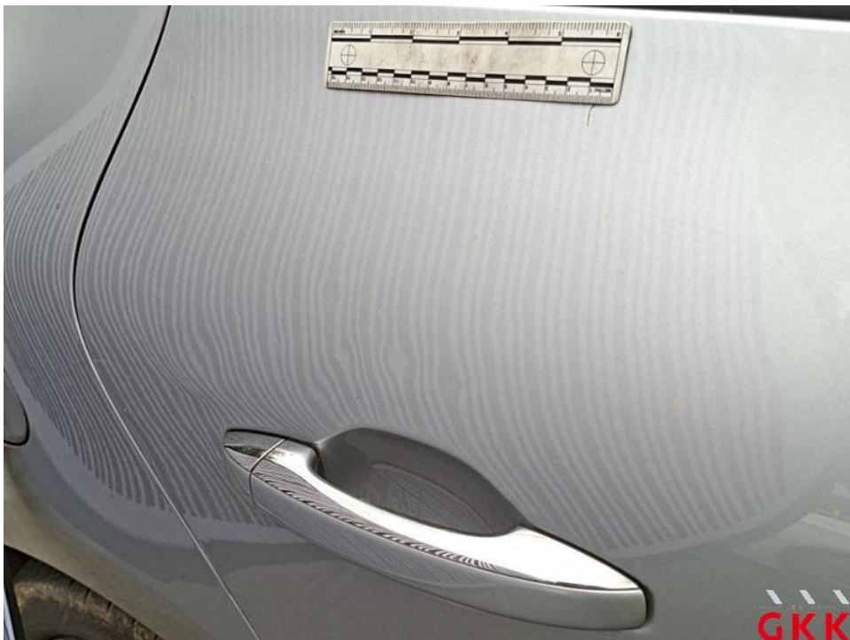
Bild 50. Tür hinten rechts, beschädigt, instand setzen - lackieren
