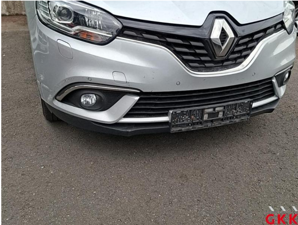
Bild 21. Stoßfänger vorne, Spoiler -unlackiert-, gerissen, ersetzen
