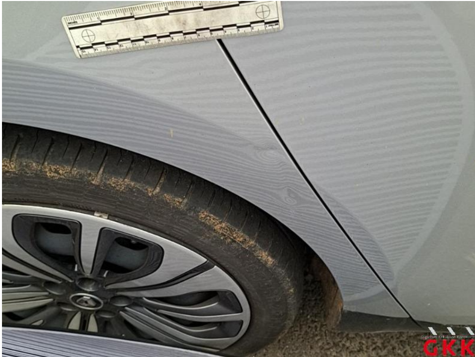
Bild 43. Seitenwand rechts, beschädigt, instand setzen - lackieren
