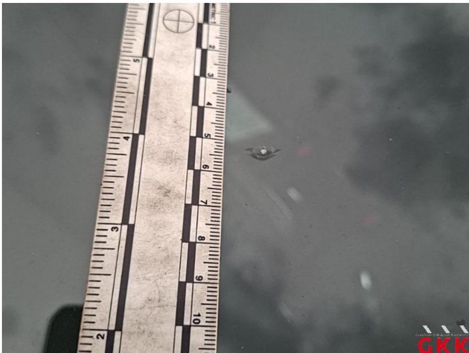
Bild 24. Frontscheibe, wärmedämmend mit Regensensor und Frontkamera, Steinschlag mit Rissbildung, ersetzen
