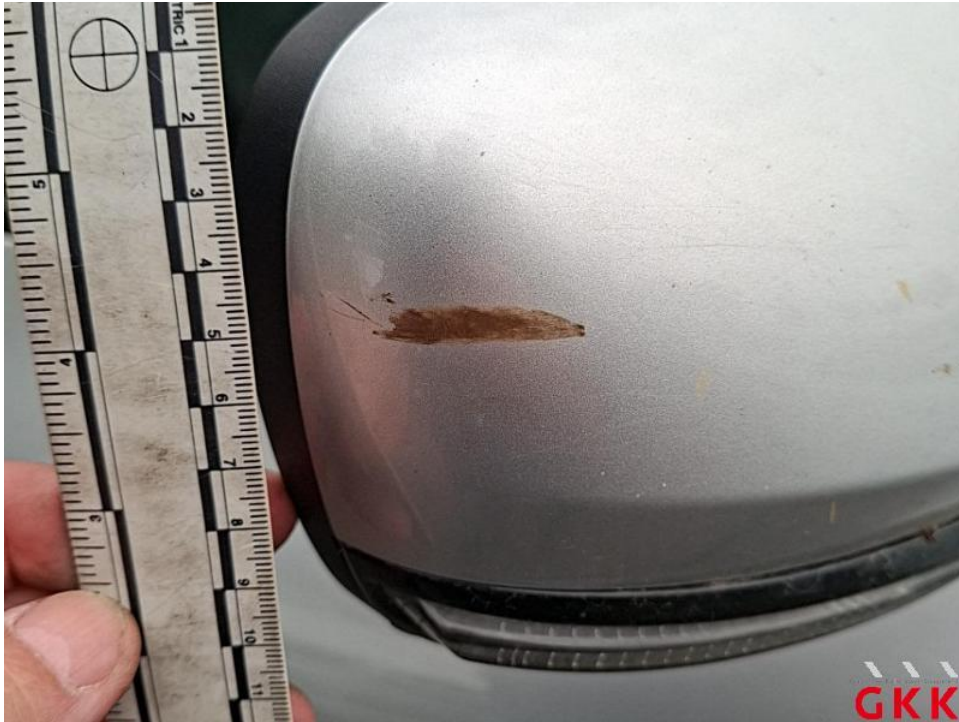
Bild 15. Spiegelgehäuse rechts, Blende -unlackiert-, verkratzt, Smartrepair
