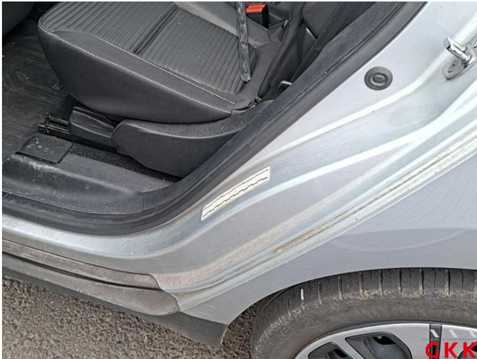
Bild 30. Tür hinten links, Einstieg, beschädigt, Smartrepair
