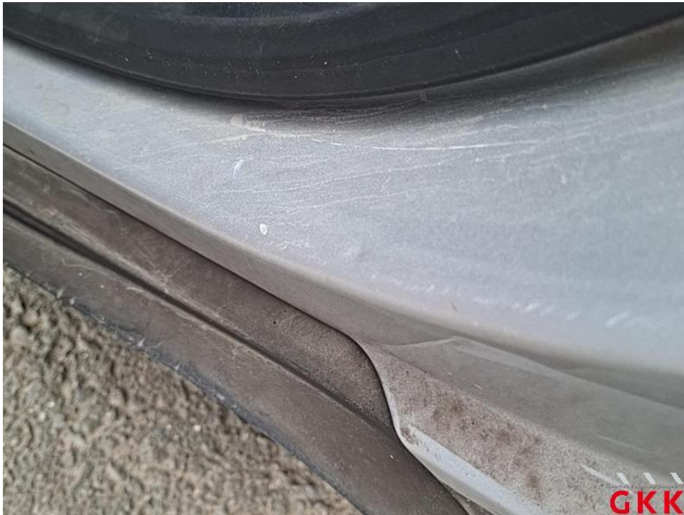
Bild 32. Tür hinten links, Einstieg, beschädigt, Smartrepair
