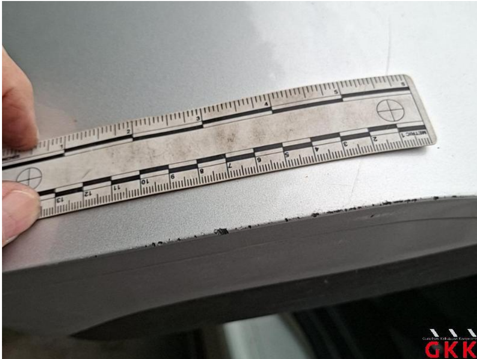
Bild 41. Heckklappe, Blende -lackiert-, verkratzt, lackieren
