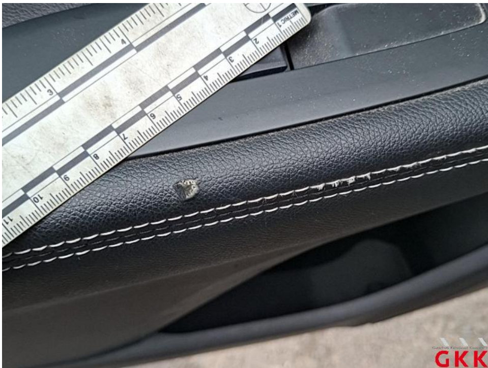
Bild 34. Tür hinten links, Innenverkleidung -Standard-, beschädigt, Smartrepair
