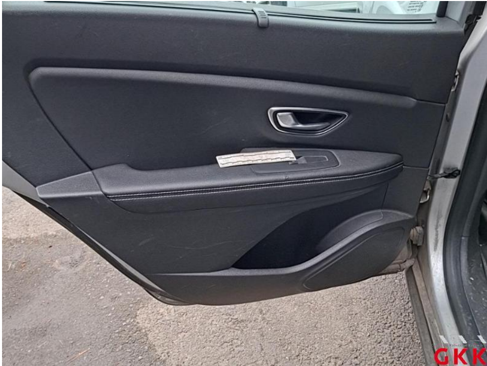
Bild 33. Tür hinten links, Innenverkleidung -Standard-, beschädigt, Smartrepair
