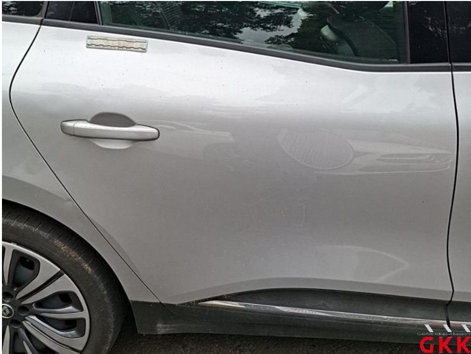
Bild 49. Tür hinten rechts, beschädigt, instand setzen - lackieren
