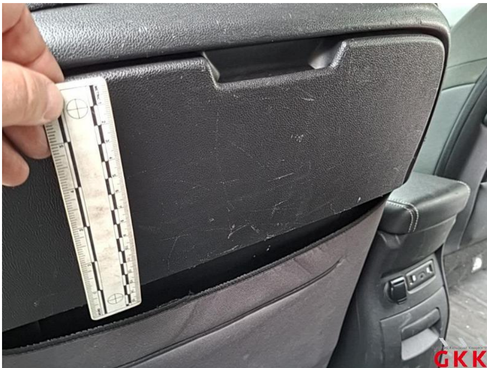
Bild 48. Sitz vorne links, Ablagefach, beschädigt, ersetzen
