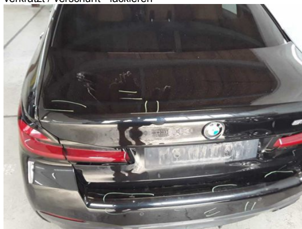
Beschädigung #9: Heckklappe/-tür: Heckklappe - verkratzt / verschürft - lackieren
