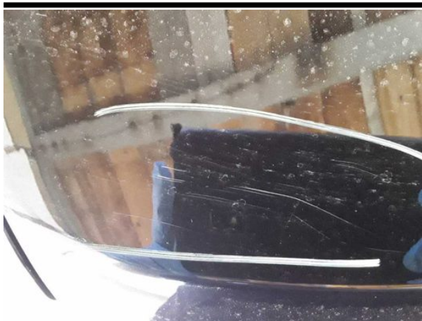
Beschädigung #9: Heckklappe/-tür: Heckklappe - verkratzt / verschürft - lackieren
