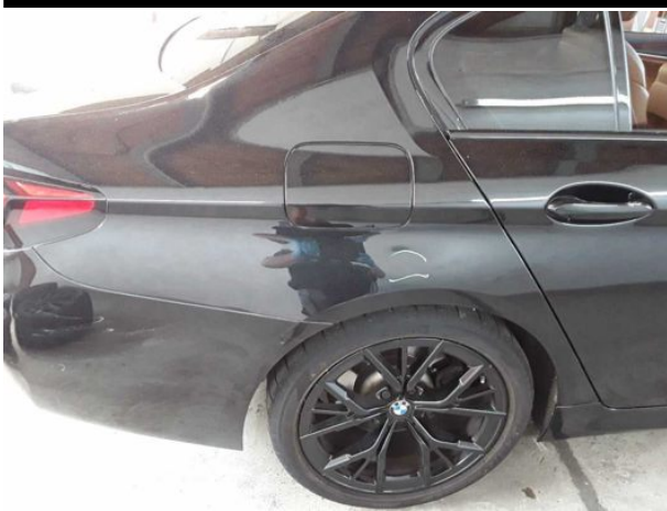
Beschädigung #12: Seitenwand rechts: Seitenwand - Delle / Lackschaden - instandsetzen und lackieren
