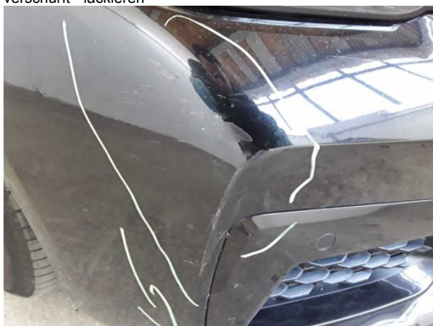
Beschädigung #10: Stossfänger vorn: Stossfänger vorn - verformt - instandsetzen und lackieren
