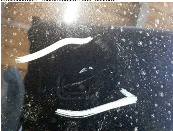
Beschädigung #13: Motorhaube: Motorhaube - verkratzt / verschürft - lackieren
