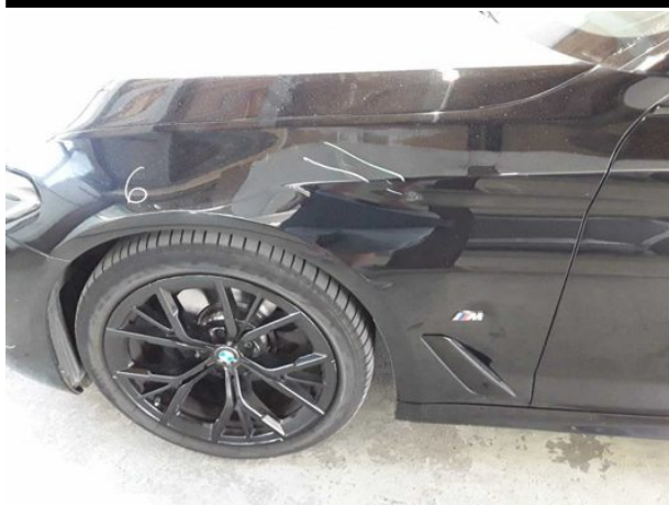
Beschädigung #6: Kotflügel links: Kotflügel links - verkratzt / verschürft - lackieren
