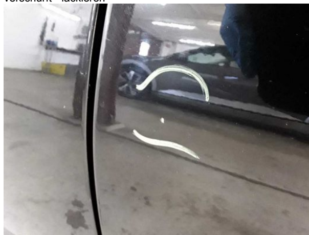
Beschädigung #7: Tür hinten links: Tür - verkratzt / verschürft... lackieren
