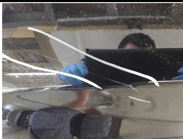
Beschädigung #6: Kotflügel links: Kotflügel links - verkratzt / verschürft - lackieren
