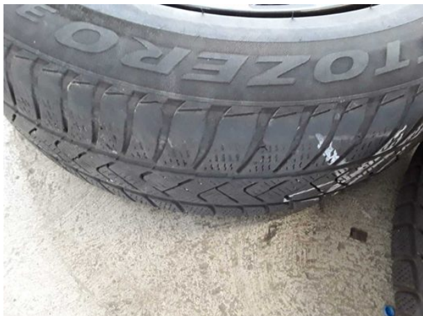
Beschädigung #2: Vermessung: Fahrwerk (Reifen außen abgefahren) - beschädigt - einstellen/justieren
