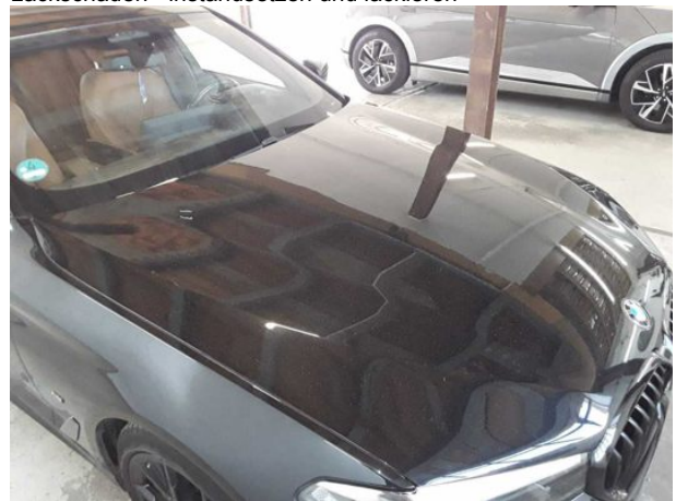
Beschädigung #13: Motorhaube: Motorhaube - verkratzt / verschürft - lackieren
