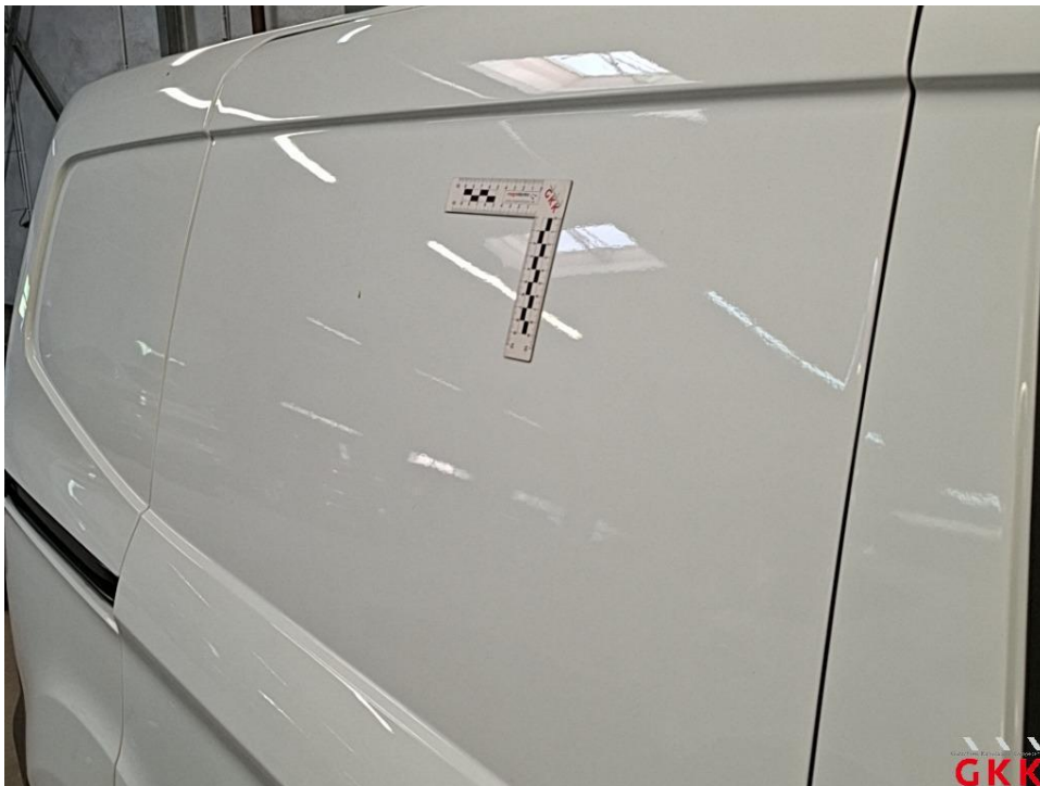
Bild 18 Schiebetür rechts, beschädigt, Smartrepair
