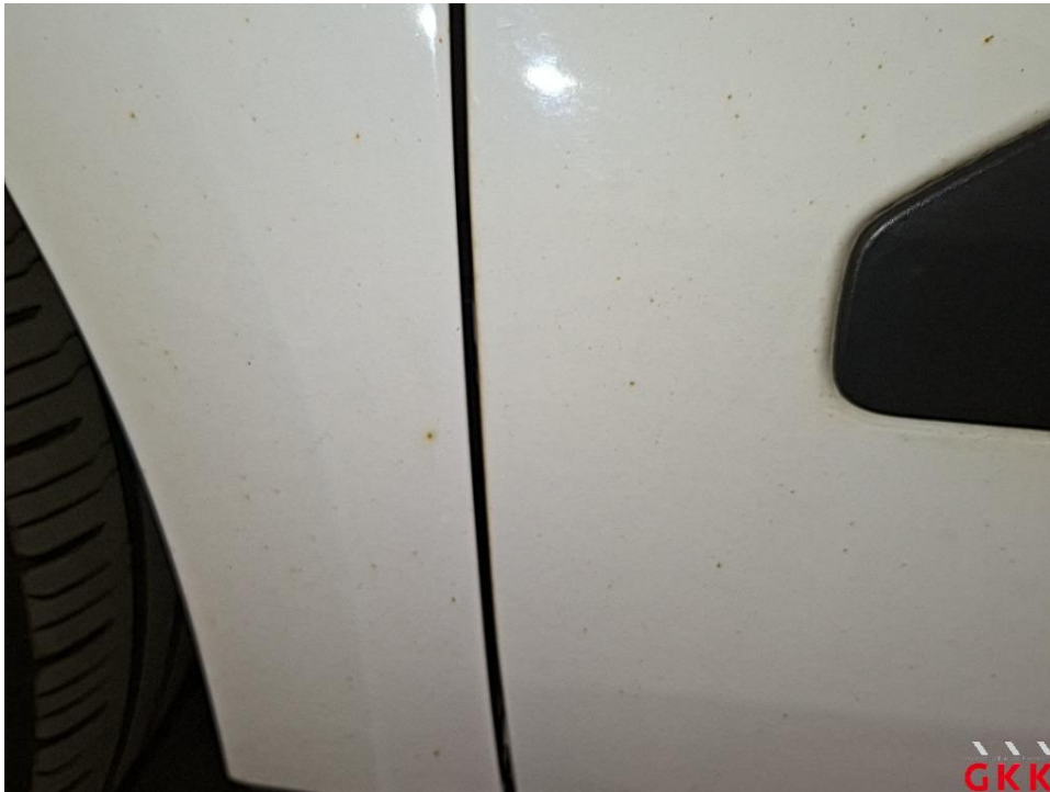
Bild 17 Fahrzeug, außen, Lackierung verwittert / matt, aufbereiten
