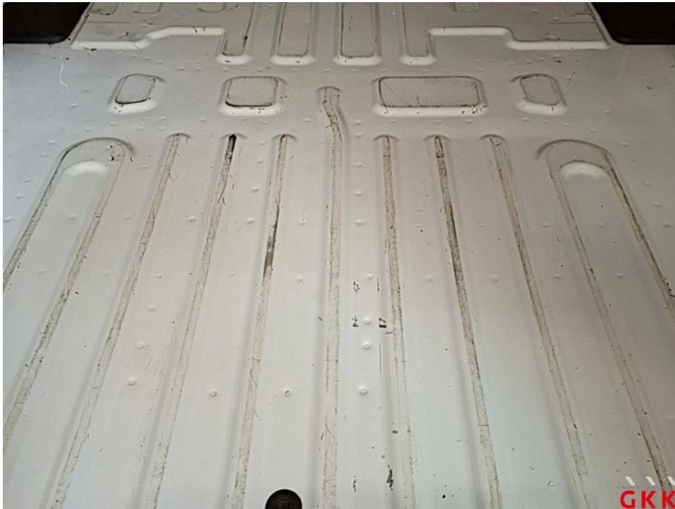
Bild 21 Laderaum, eingedellt und verkratzt (I), Smartrepair
