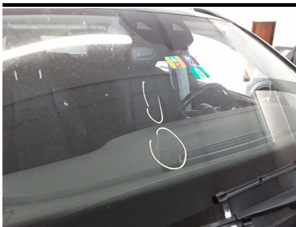
Beschädigung #11: Verglasung: Frontscheibe (Rissbildung) - Steinschlag - erneuern
