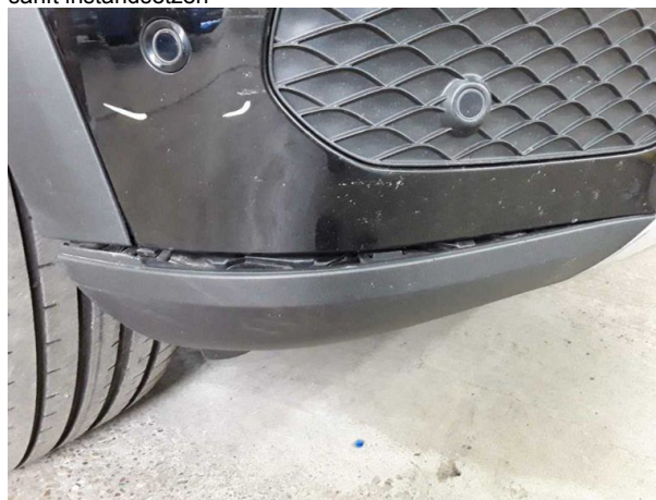
Beschädigung #6: Stossfänger vorn: Spoiler - lose - befunden ggf. instandsetzen
