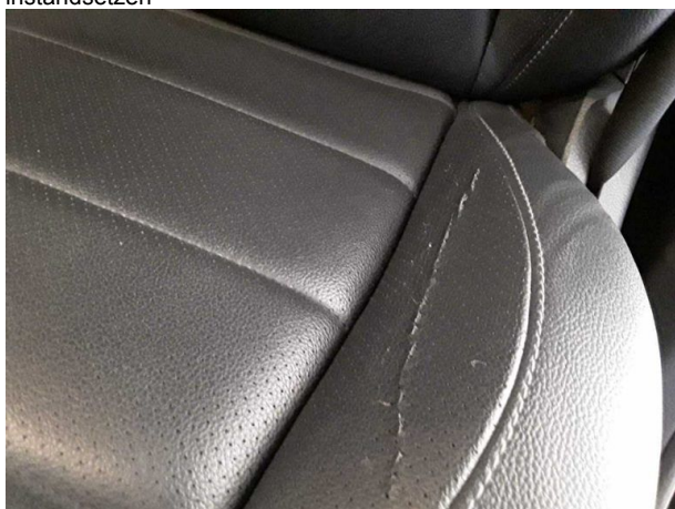
Beschädigung #7: Sitz vorn: Sitzbezug links - gebrochen / gerissen - erneuern
