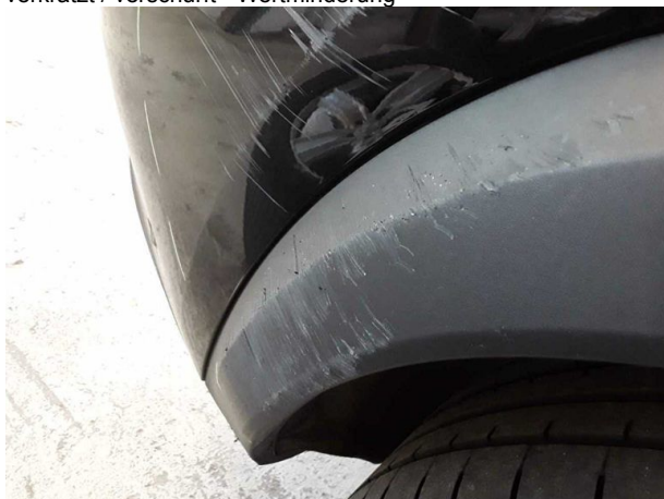
Beschädigung #3: Seitenwand rechts: Radhausverbreiterung - verkratzt / verschürft - erneuern
