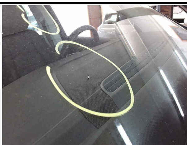
Beschädigung #11: Verglasung: Frontscheibe (Rissbildung) - Steinschlag - erneuern
