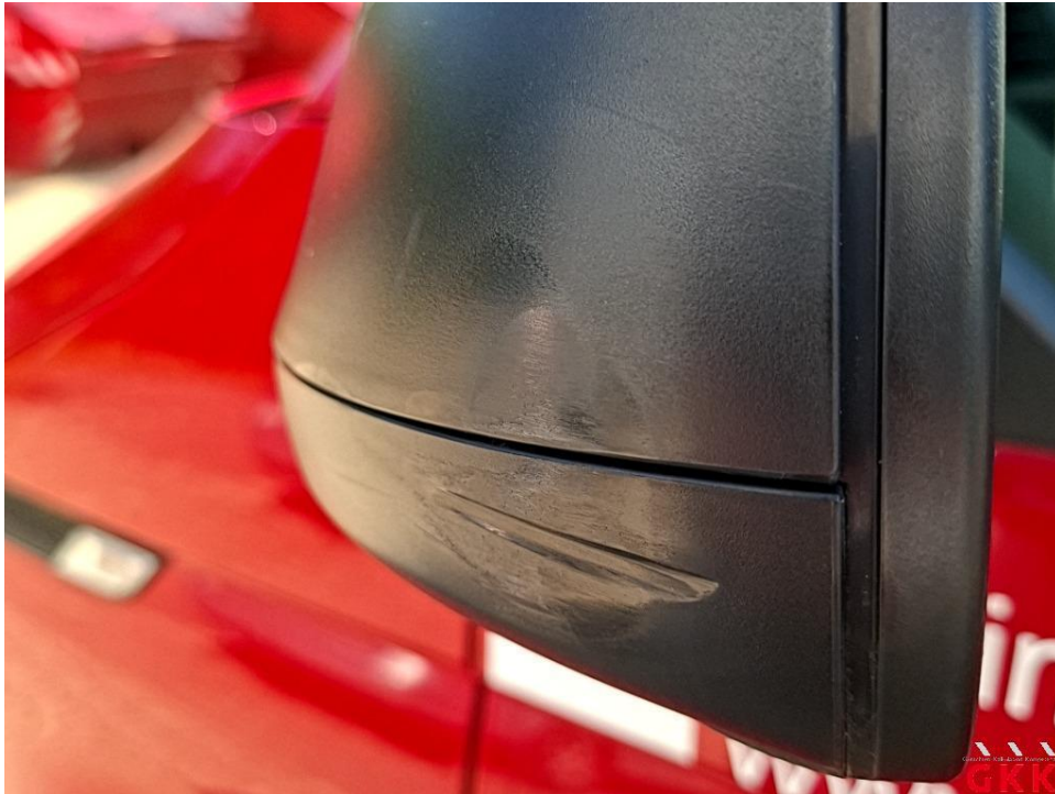
Bild 23. Spiegelgehäuse links, Kappe -unlackiert-, verkratzt, ersetzen
