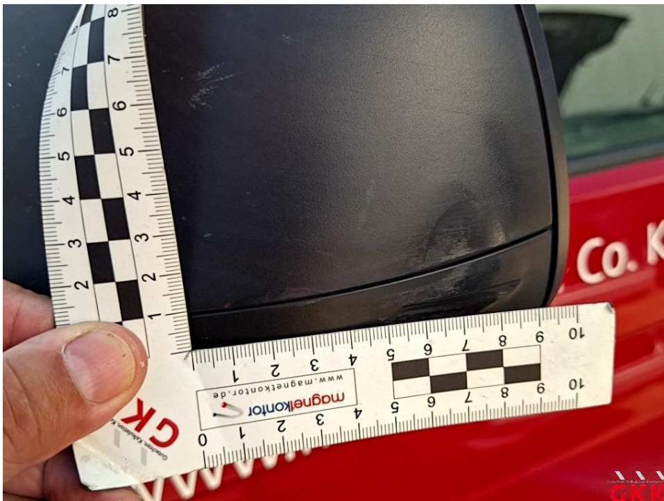
Bild 22. Spiegelgehäuse links, Kappe -unlackiert-, verkratzt, ersetzen
