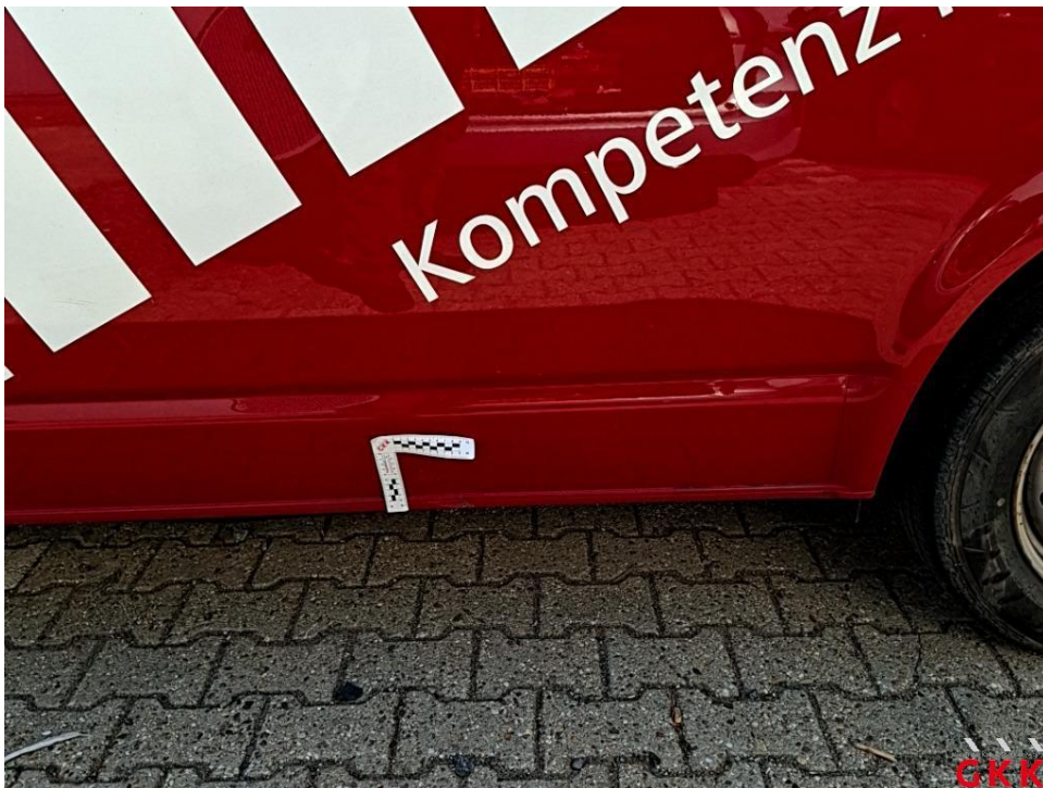
Bild 34. Seitenwand links, unterhalb, beschädigt, instand setzen - lackieren
