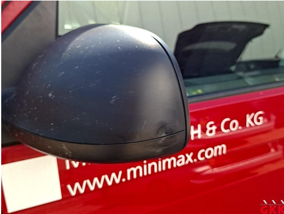
Bild 21. Spiegelgehäuse links, Kappe -unlackiert-, verkratzt, ersetzen
