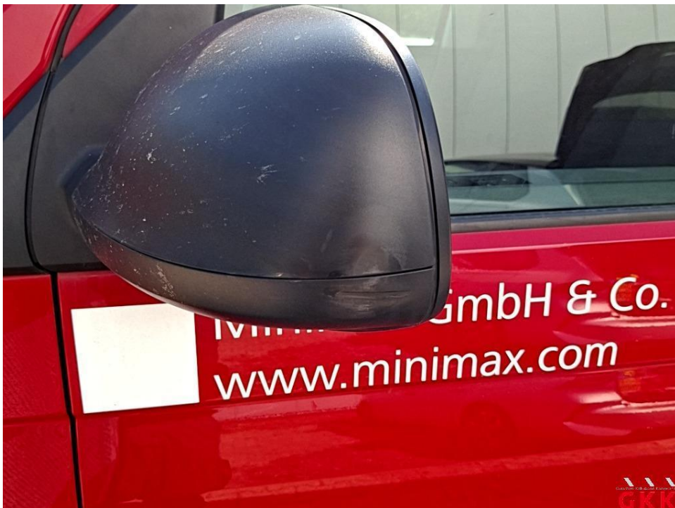
Bild 18. Spiegelgehäuse links, Rahmen, beschädigt, ersetzen
