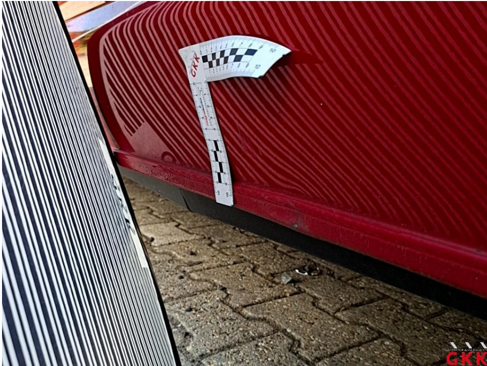
Bild 35. Seitenwand links, unterhalb, beschädigt, instand setzen - lackieren
