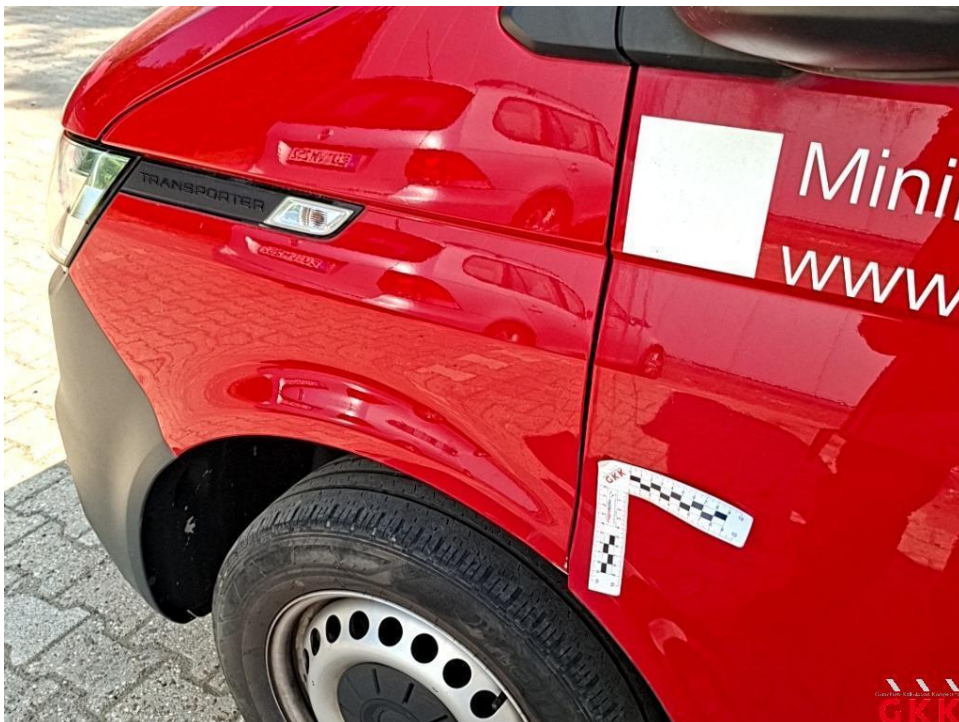
Bild 16. Kotflügel vorne links, beschädigt, instand setzen - lackieren
