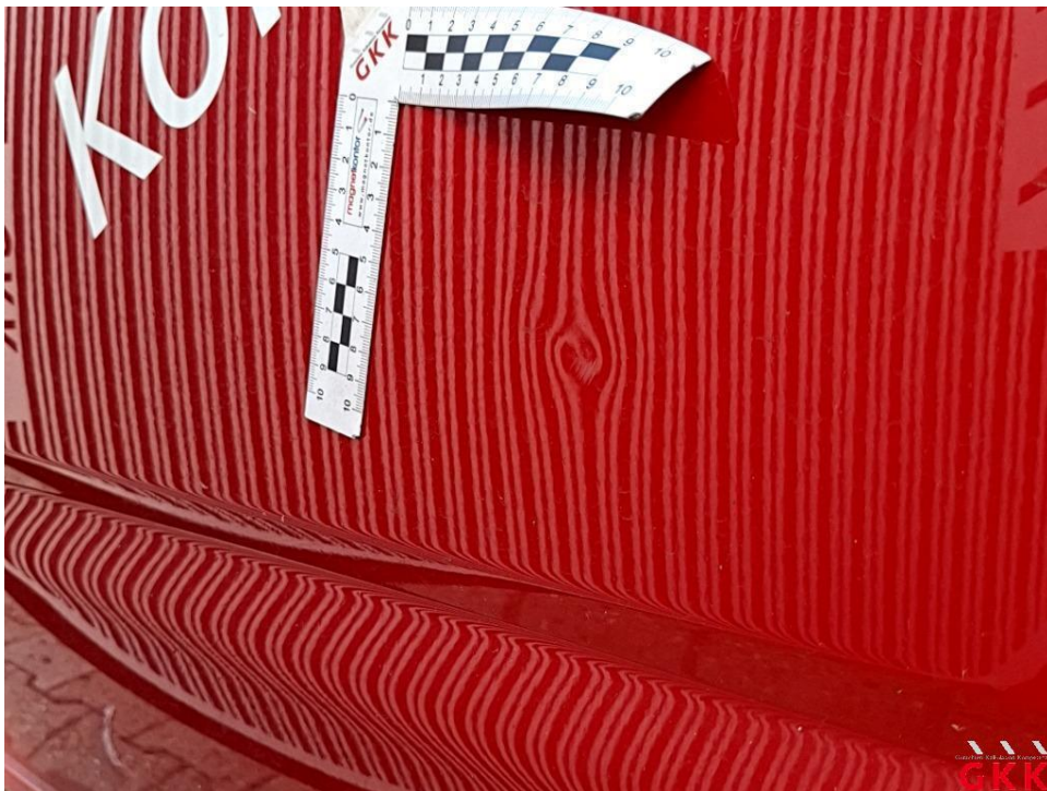
Bild 36. Seitenwand links, unterhalb, beschädigt, instand setzen - lackieren
