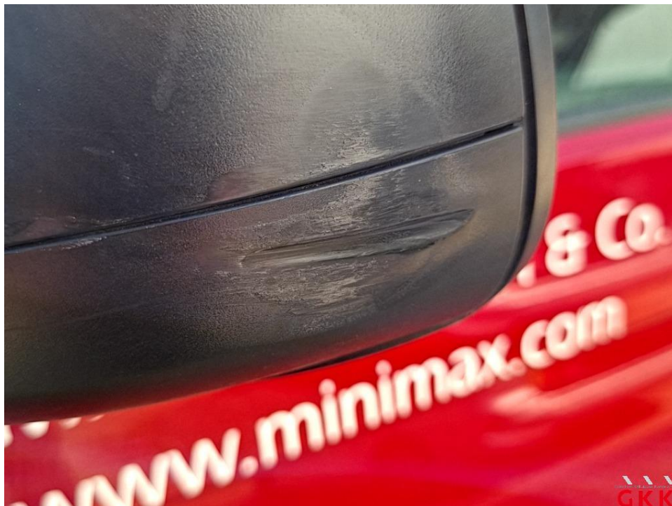
Bild 20. Spiegelgehäuse links, Rahmen, beschädigt, ersetzen
