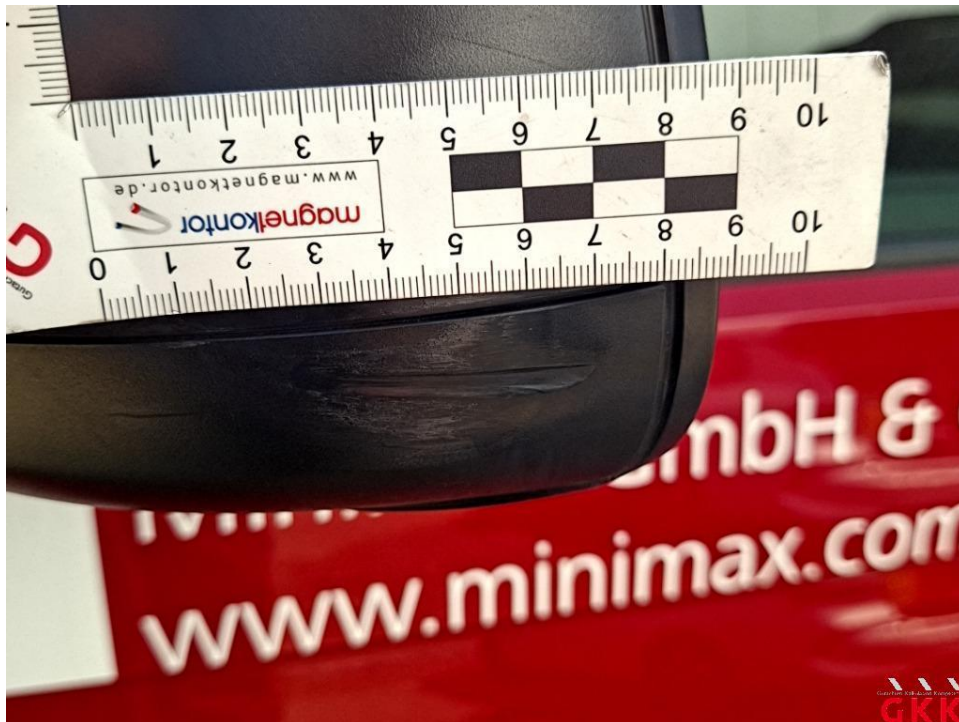
Bild 19. Spiegelgehäuse links, Rahmen, beschädigt, ersetzen
