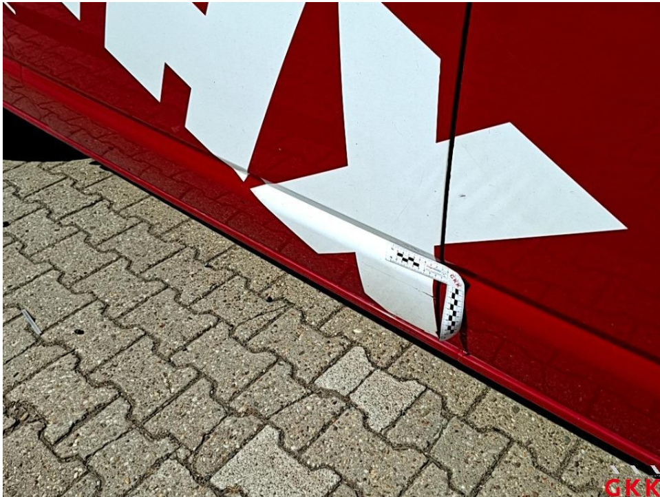
Bild 30. Schiebetür rechts, verkratzt, Spotlackieren
