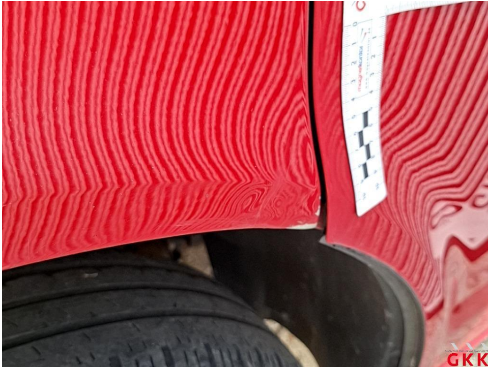
Bild 17. Kotflügel vorne links, beschädigt, instand setzen - lackieren
