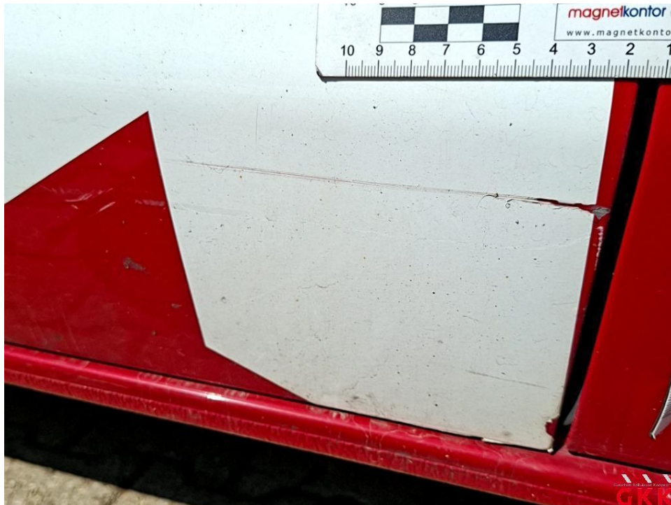
Bild 31. Schiebetür rechts, verkratzt, Spotlackieren
