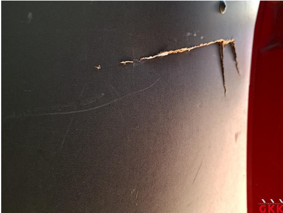
Bild 33. Schiebetür rechts, Innenverkleidung, beschädigt, ersetzen
