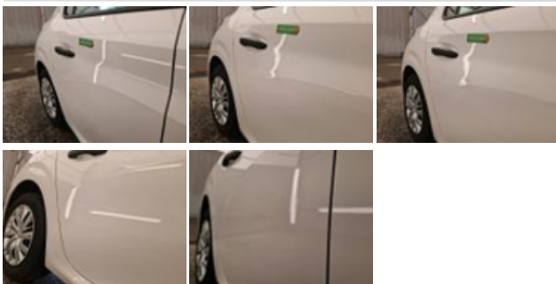
Porte AVD, Mauvaise réparation, Peindre
