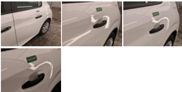
Aile ARD, Mauvaise réparation, Peindre
