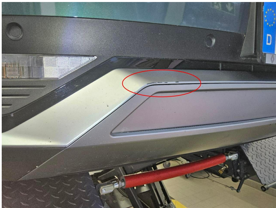
Bild 22 : Stoßfänger vorne verkratzt
