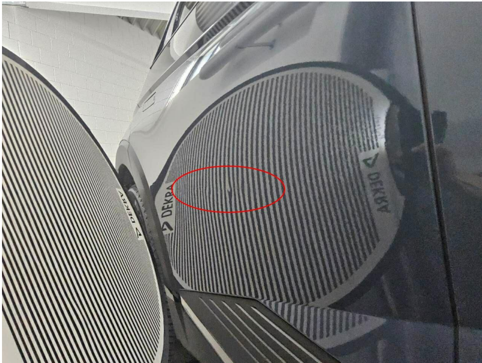
Bild 17 : Türe hinten rechts eingedellt und oberflächliche verkratzt
