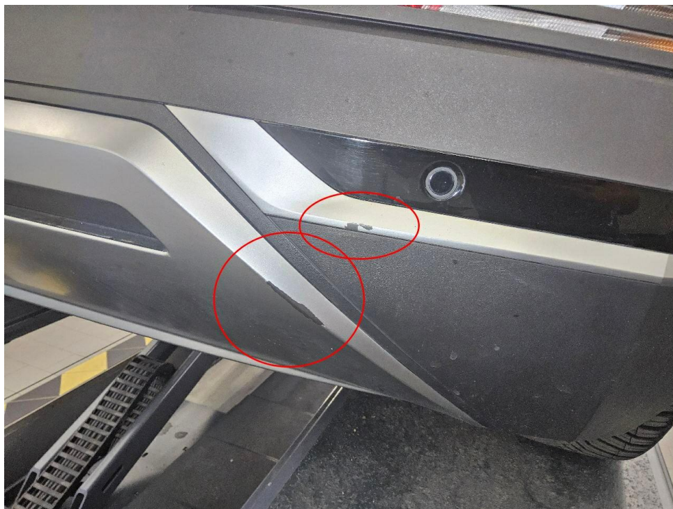
Bild 15 : Stoßfänger hinten unterteil verkratzt
