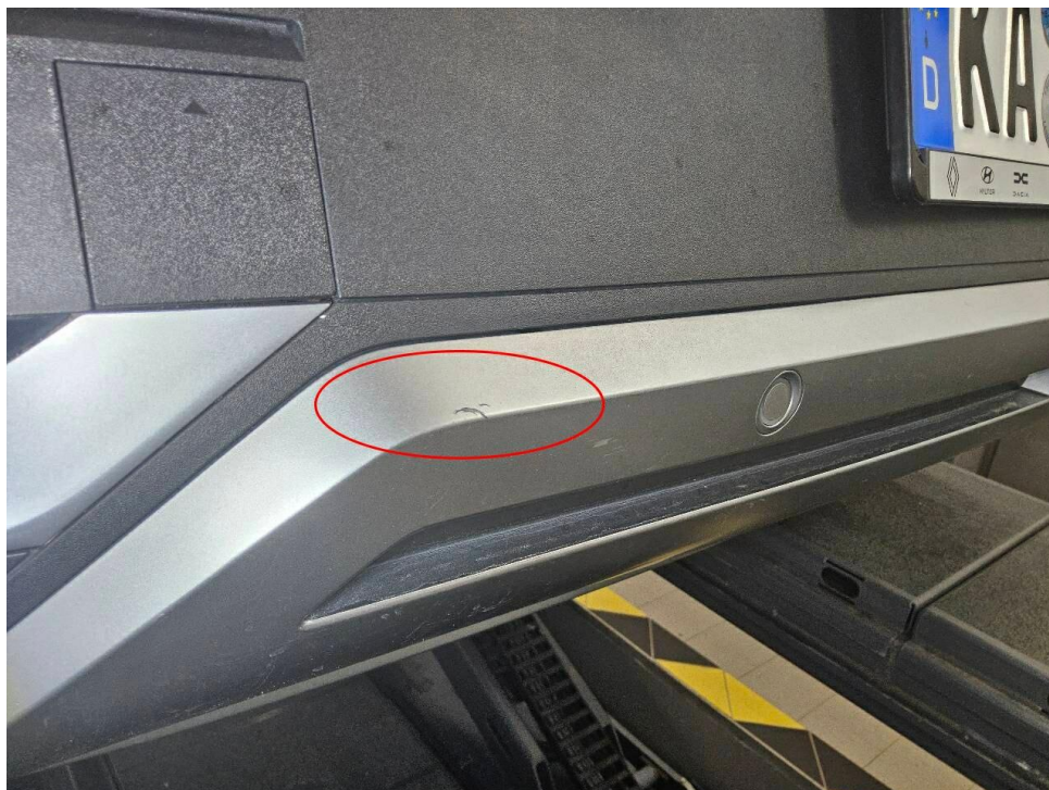
Bild 16 : Stoßfänger hinten unterteil verkratzt
