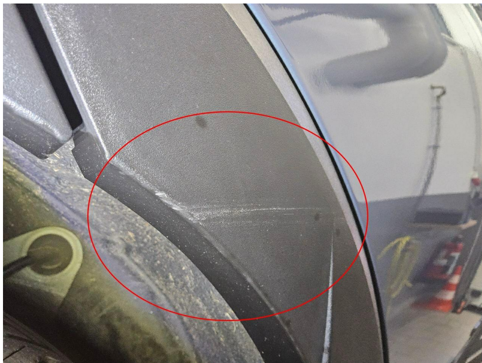
Bild 20 : Blende Türe hinten rechts verschrammt
