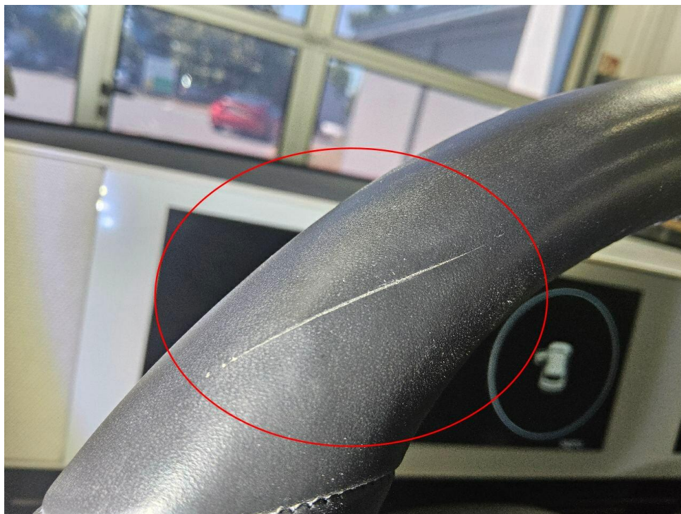
Bild 11 : Lenkradkrantz eingerissen (ingeschnitten)
