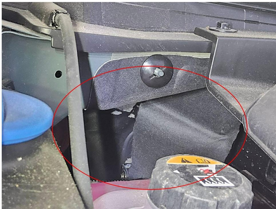
Bild 7 : Motorraum Dämmung Tierverbiss
