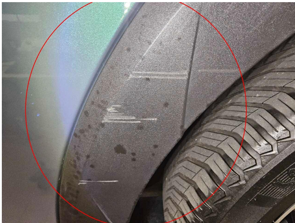
Bild 12 : Radlaufblende Türe hinten links verkratzt
