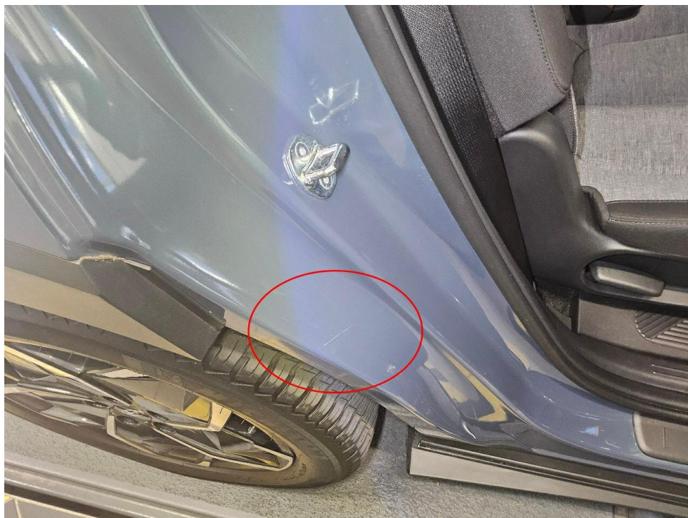
Bild 8 : Türeinstieg hinten rechts verkratzt
