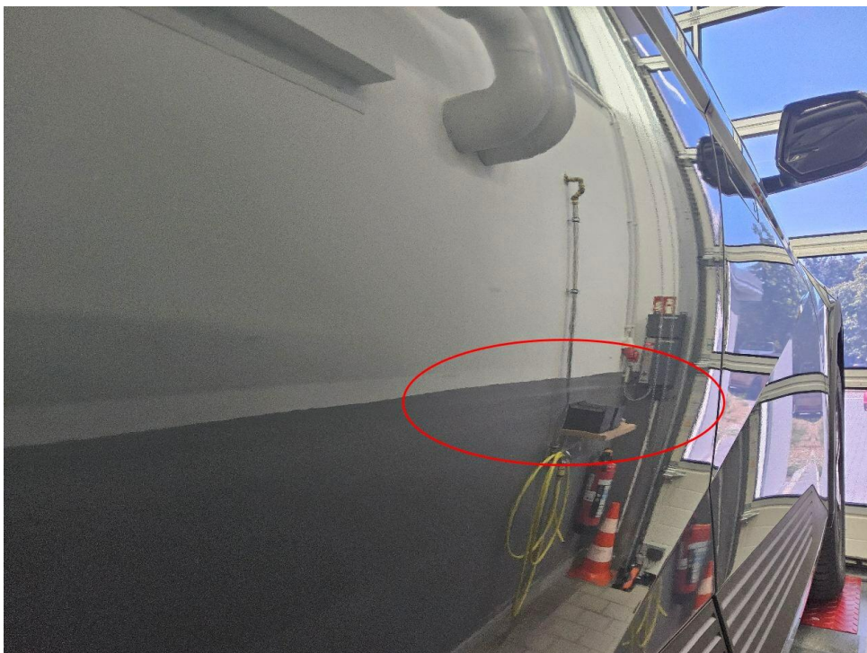
Bild 18 : Türe hinten rechts eingedellt und oberflächliche verkratzt
