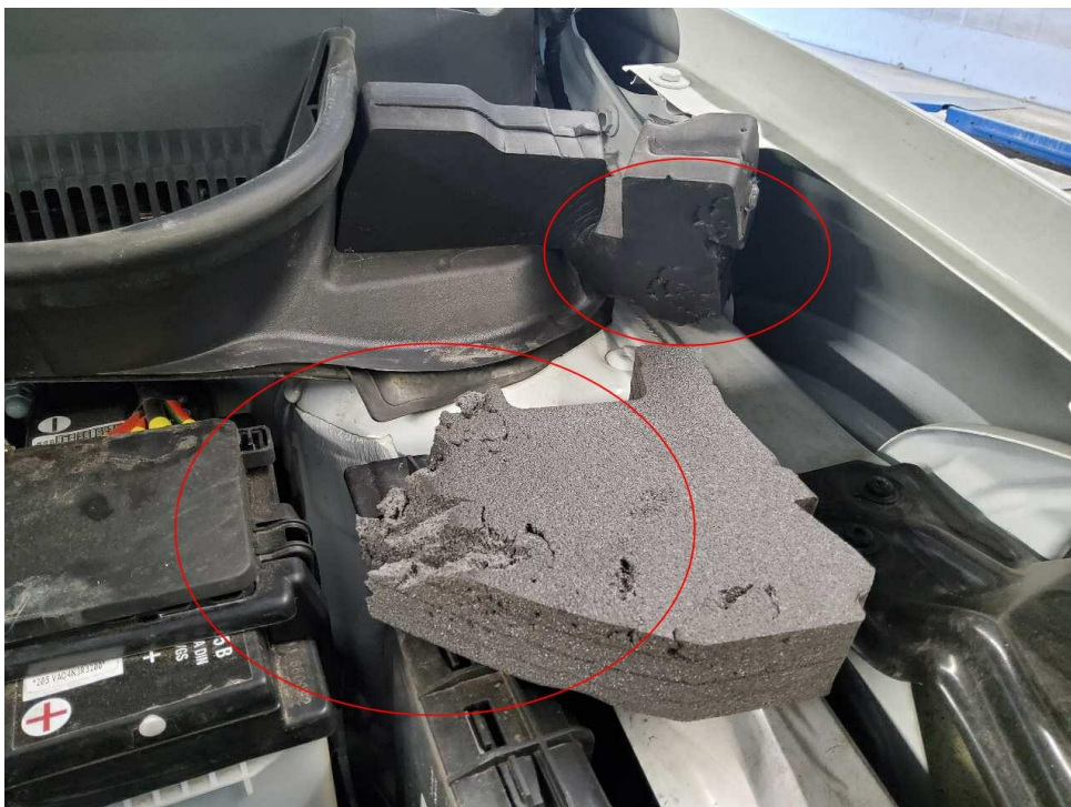
Bild 16 : Dämpfungen Motorraum links und rechts, Tierversbiss
