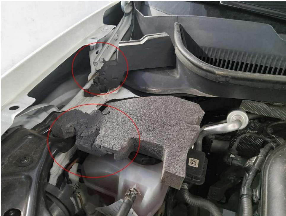
Bild 15 : Dämpfungen Motorraum links und rechts, Tierversbiss
