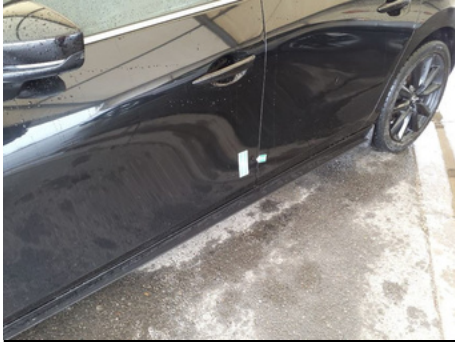
Porte / Avant Gauche / Enfoncement
