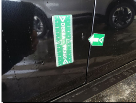
Porte / Avant Gauche / Enfoncement
