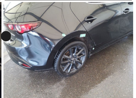
Aile / Arrière Droit / Enfoncement
