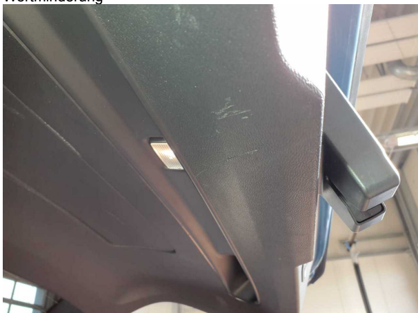
Beschädigung #4: Heckklappe/-tür: Verkleidung Standard unten - Kratzer - erneuern
