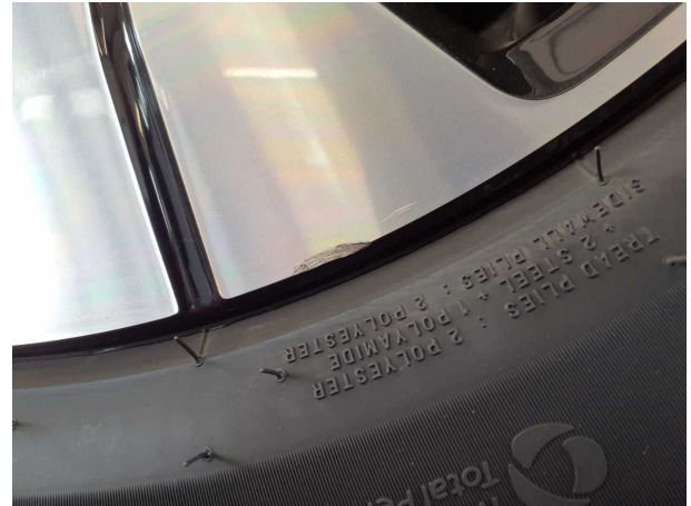
Beschädigung #3: Rad/Reifen: Leichtmetallfelge vorn rechts - Kratzer - Wertminderung
