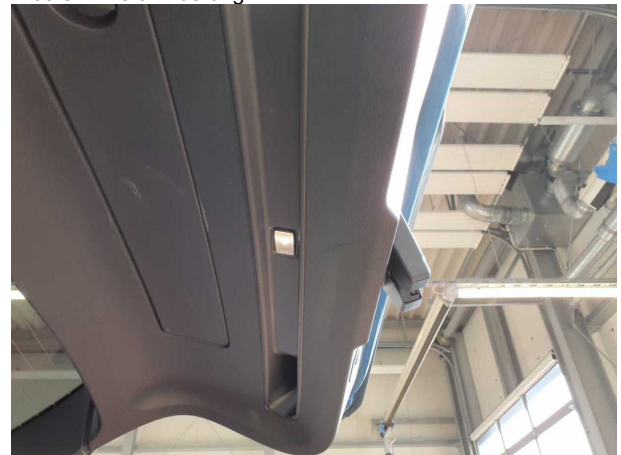
Beschädigung #4: Heckklappe/-tür: Verkleidung Standard unten - Kratzer - erneuern
