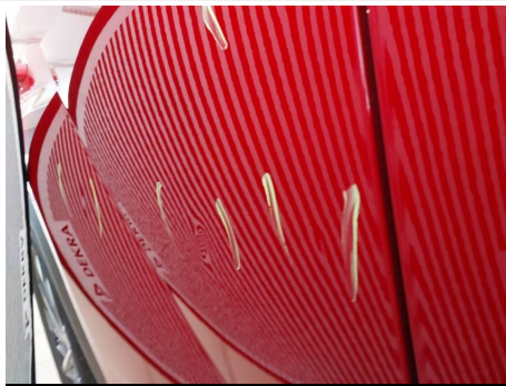
Tür / Hinten Rechts / Delle
