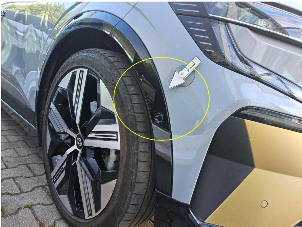
Bild 10 : Stoßfänger vorne Lackierung, verschrämmt, polieren
