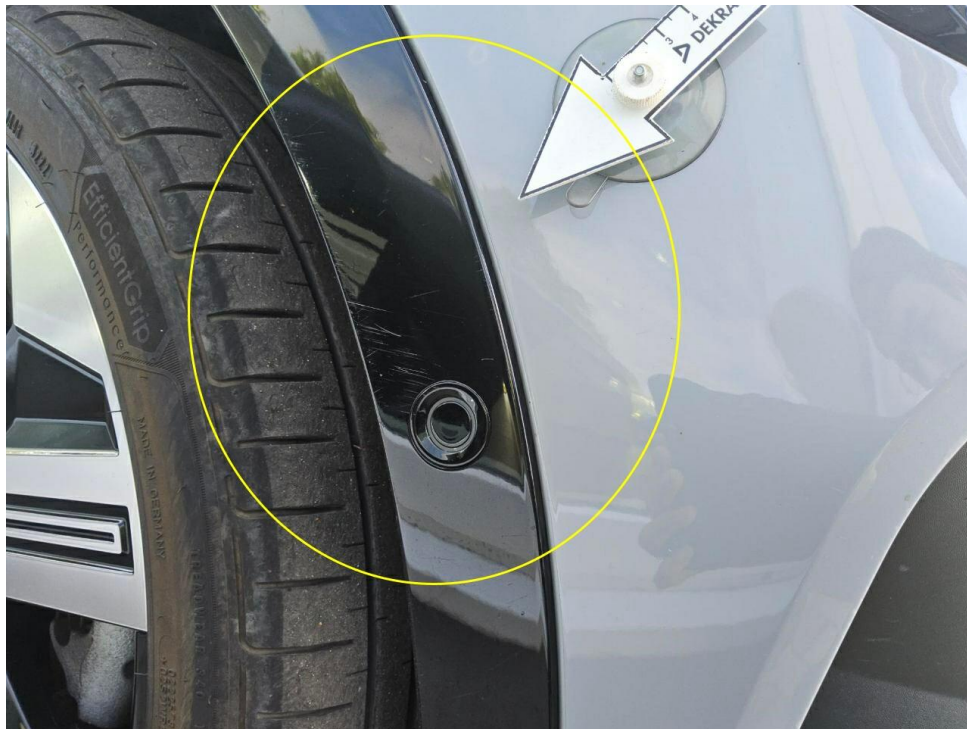
Bild 11 : Stoßfänger vorne Lackierung, verschrammt, polieren
