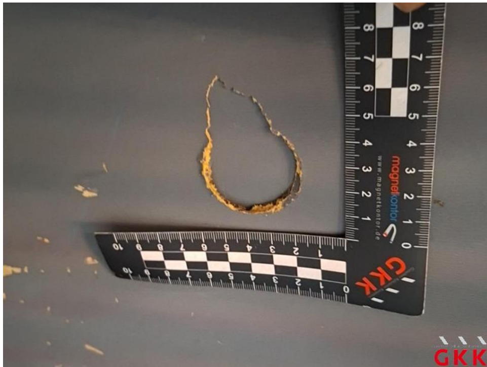
Bild 57. Schiebetür rechts, Innenverkleidung, beschädigt, ersetzen
