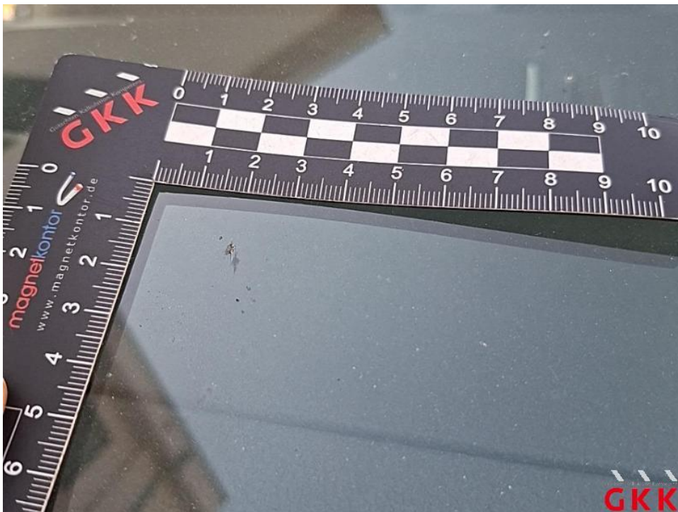
Bild 38. Frontscheibe, Steinschlag, ersetzen
