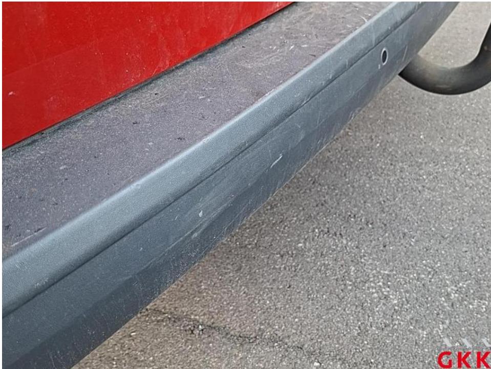
Bild 28. Stoßfänger hinten, Verkleidung -unlackiert-, beschädigt, ersetzen
