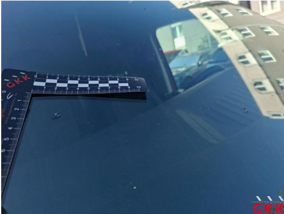
Bild 37. Frontscheibe, Steinschlag, ersetzen
