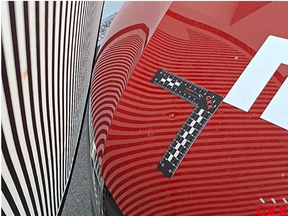
Bild 34. Motorhaube, beschädigt, instand setzen - lackieren
