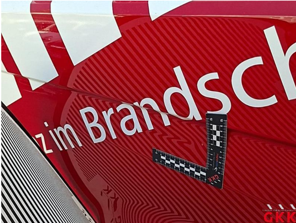
Bild 31. Seitenwand links, beschädigt, instand setzen - lackieren
