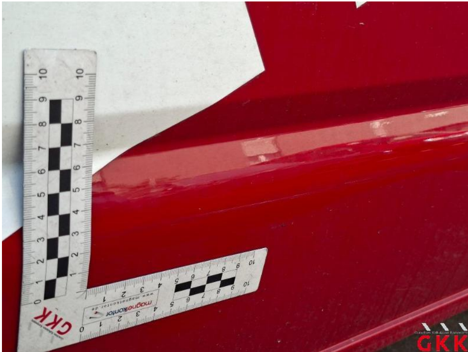
Bild 32. Seitenwand links, beschädigt, instand setzen - lackieren
