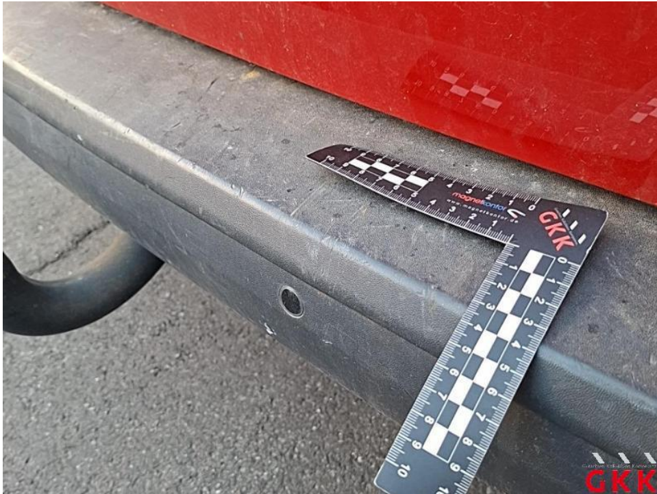
Bild 29. Stoßfänger hinten, Verkleidung -unlackiert-, beschädigt, ersetzen
