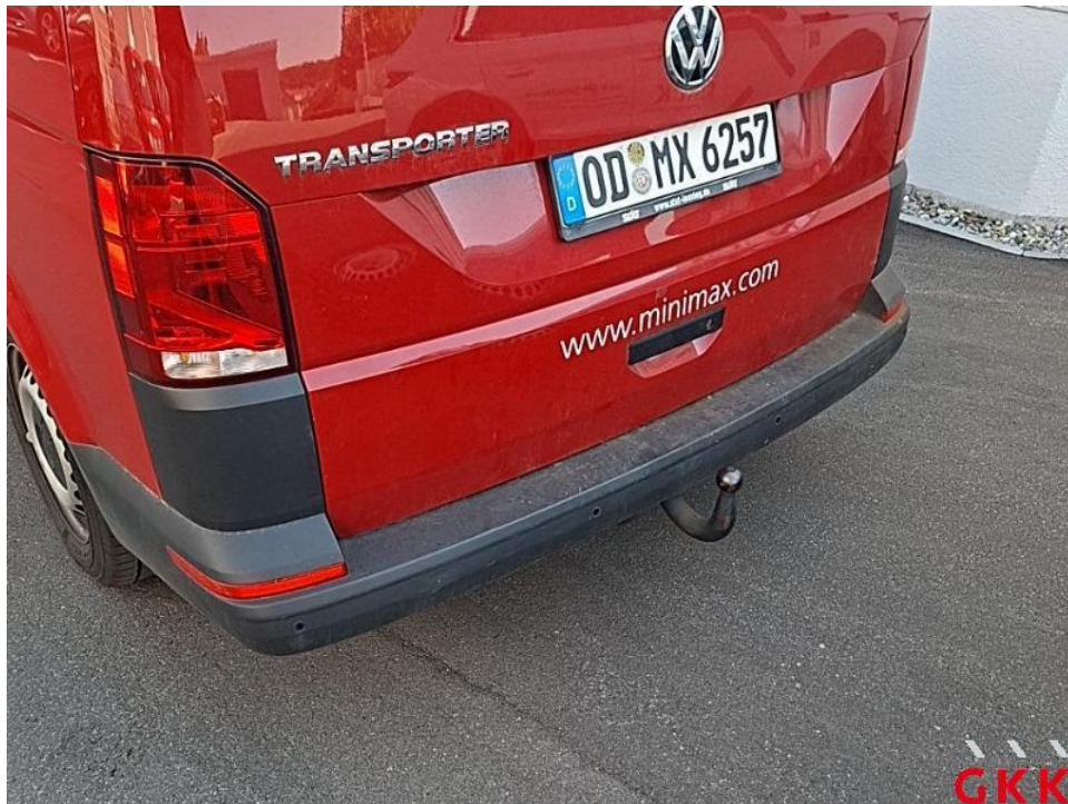
Bild 27. Stoßfänger hinten, Verkleidung -unlackiert-, beschädigt, ersetzen
