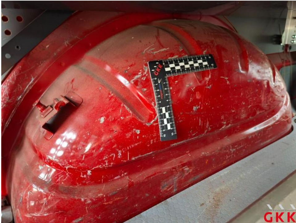
Bild 51. Radhaus hinten links, beschädigt, instand setzen - lackieren
