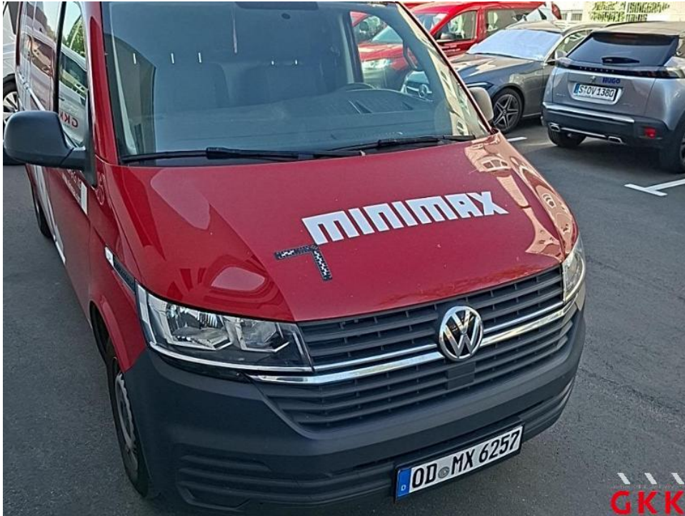
Bild 33. Motorhaube, beschädigt, instand setzen - lackieren
