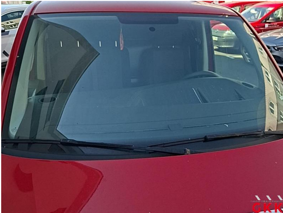
Bild 36. Frontscheibe, Steinschlag, ersetzen
