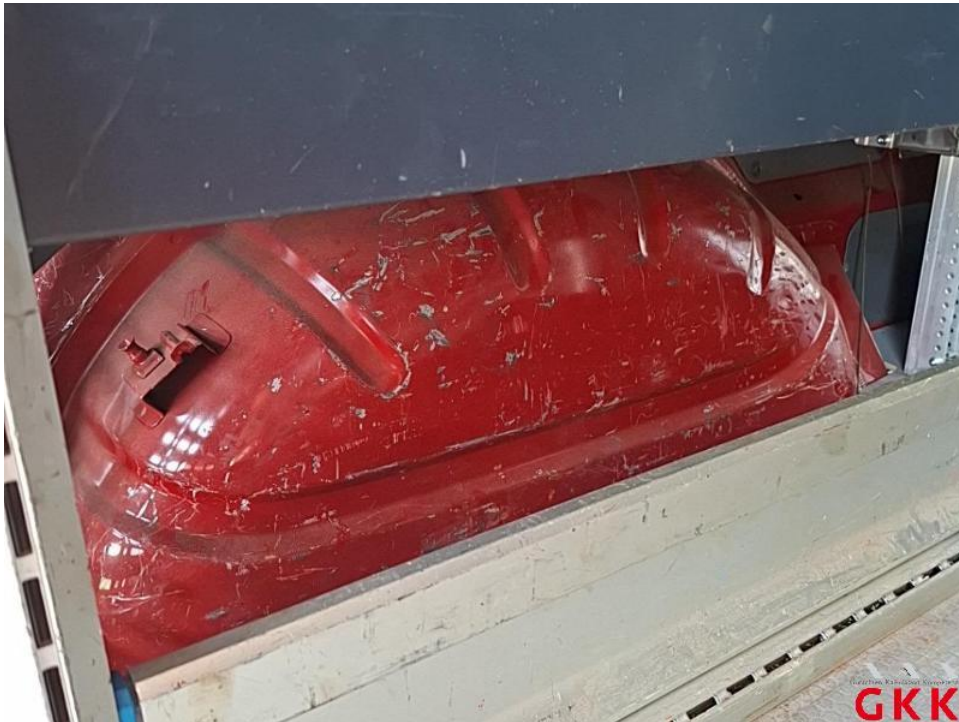
Bild 50. Radhaus hinten links, beschädigt, instand setzen - lackieren
