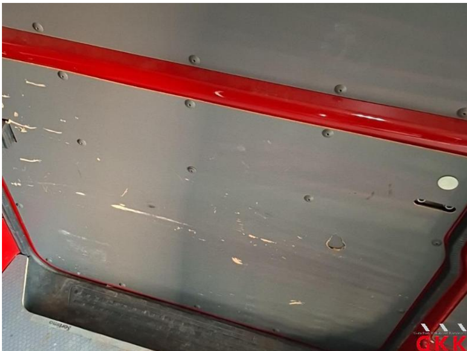
Bild 56. Schiebetür rechts, Innenverkleidung, beschädigt, ersetzen
