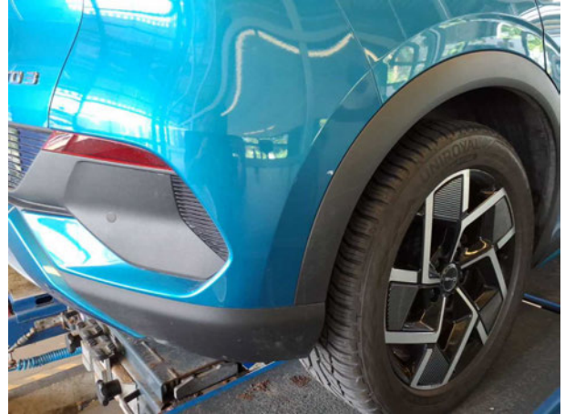
Beschädigung #5: Seitenwand rechts: Kotflügel hinten rechts - verkratzt / verschürft - erneuern
