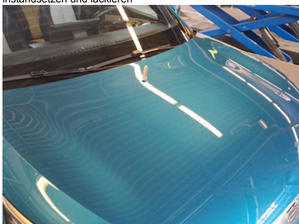
Beschädigung #13: Motorhaube: Motorhaube - Delle / Lackschaden - instandsetzen und lackieren
