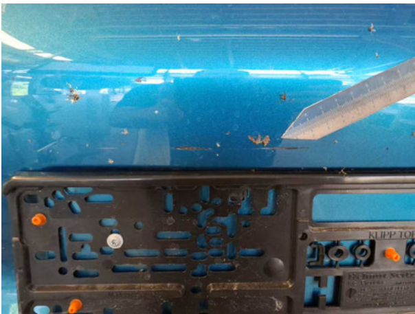
Beschädigung #9: Stossfänger vorn: Stossfänger vorn - verkratzt / verschürft - lackieren
