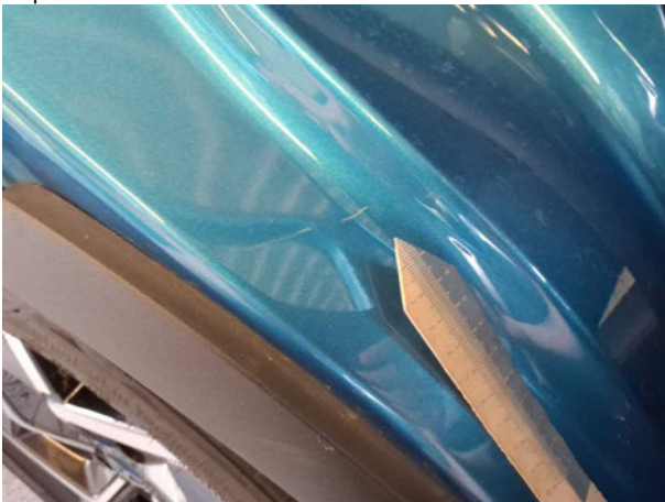
Beschädigung #8: Karosserie: C-Säule rechts - Kratzer - Smart Repair
