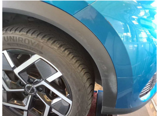
Beschädigung #6: Kotflügel rechts: Radhausverbreiterung - verkratzt / verschürft - erneuern
