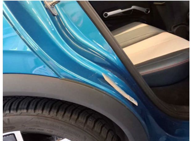
Beschädigung #8: Karosserie: C-Säule rechts - Kratzer - Smart Repair
