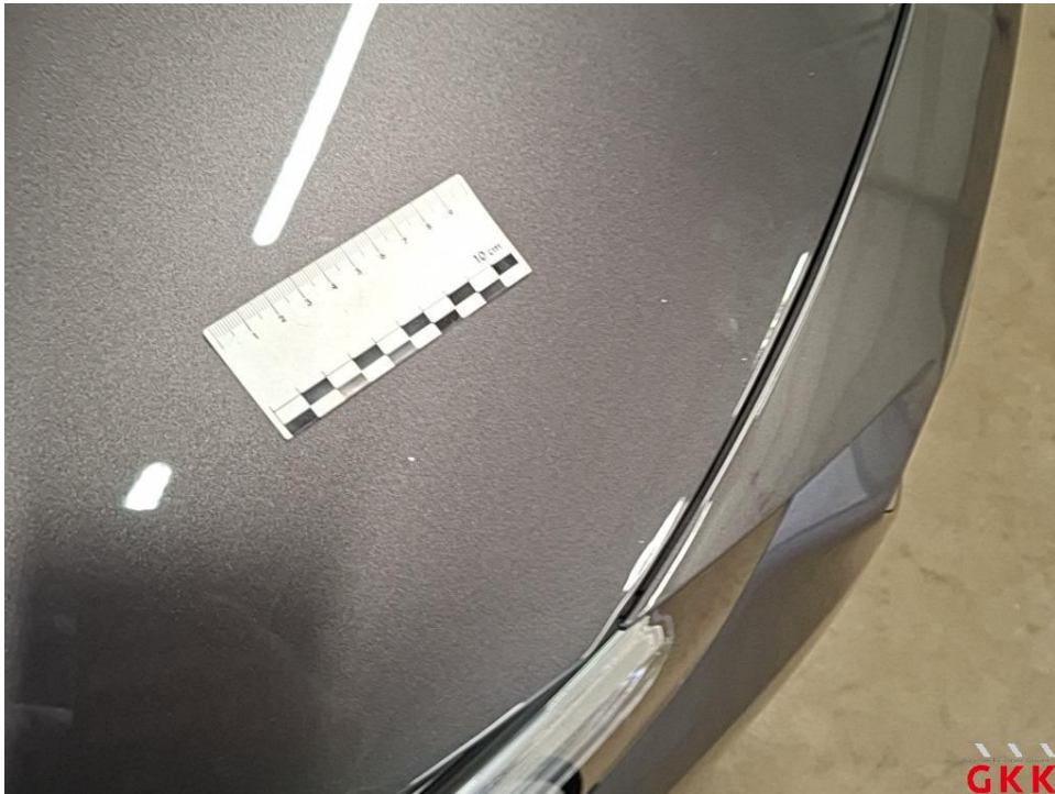
Bild 18 Motorhaube, Steinschlag, lackieren
