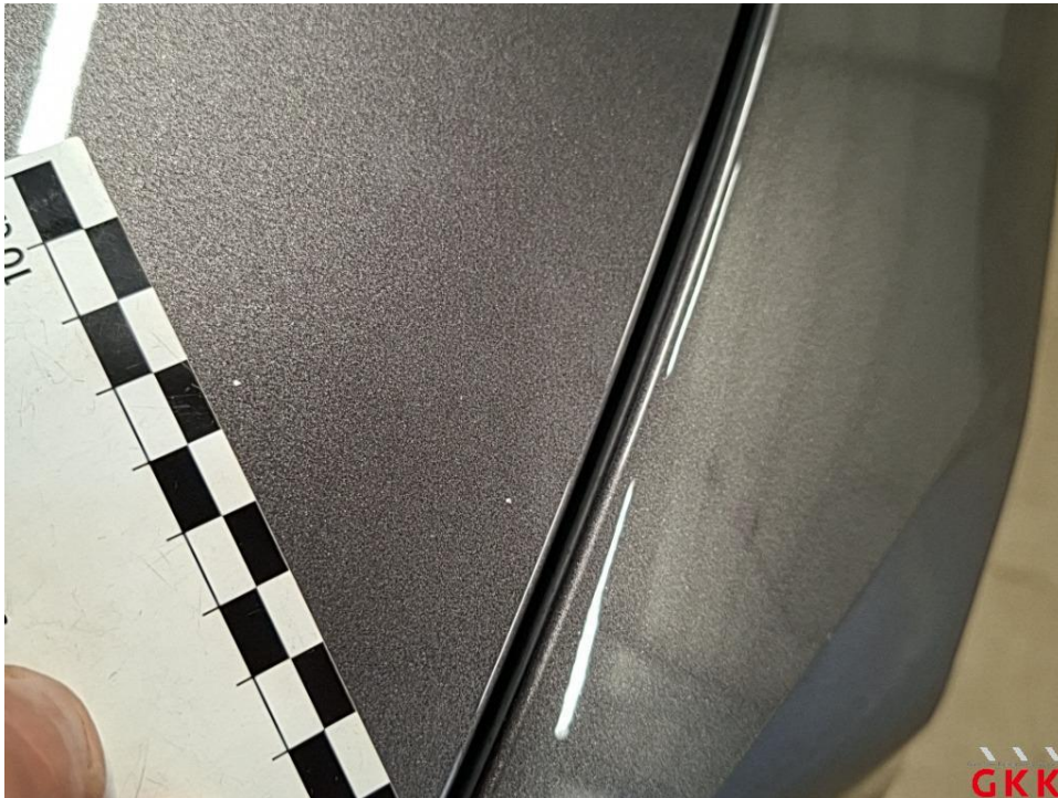
Bild 20 Motorhaube, Steinschlag, lackieren
