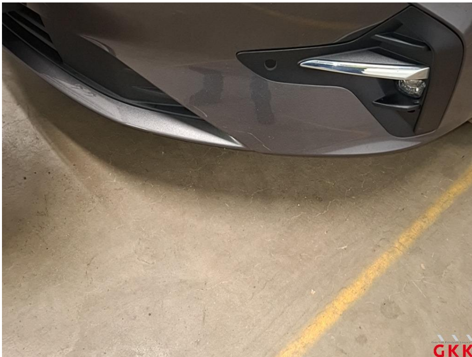
Bild 21 Stoßfänger vorne, Verkleidung -lackiert-, verkratzt, lackieren
