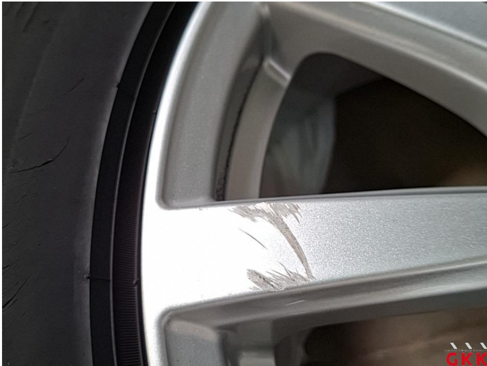
Bild 16 LM-Rad, 1 x beiliegend, beschädigt, ersetzen
