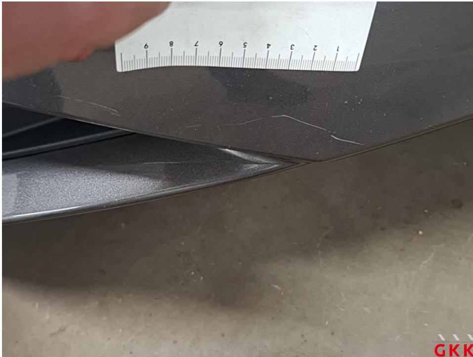
Bild 22 Stoßfänger vorne, Verkleidung -lackiert-, verkratzt, lackieren
