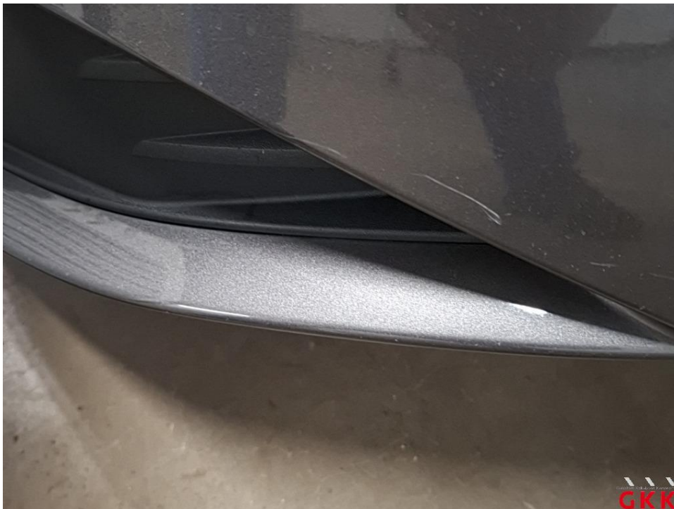
Bild 23 Stoßfänger vorne, Verkleidung -lackiert-, verkratzt, lackieren
