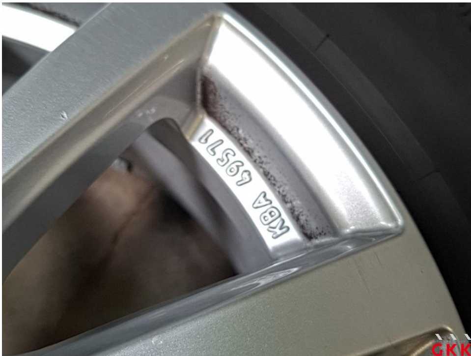
Bild 17 LM-Rad, 1 x beiliegend, beschädigt, ersetzen
