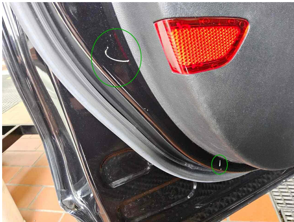
Bild 17 : Tür vorne links innen Dellen/Kratzer
