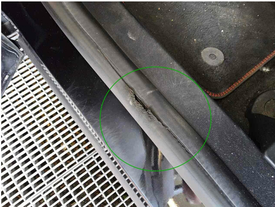
Bild 14 : Türdichtung vorne links beschädigt
