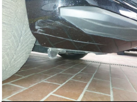
Stoßfänger Spoiler / Vorne / Kratzer
