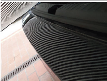
Stoßfänger / Hinten / Delle
