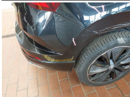
Stoßfänger / Hinten / Delle
