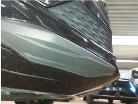
Stoßfängerleiste / Vorne Rechts / Kratzer
