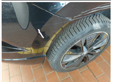
Stoßfänger / Hinten / Delle
