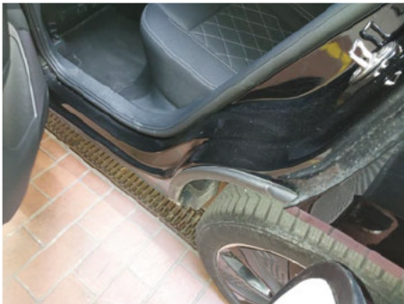
Türeinstieg / Hinten Links / Delle
