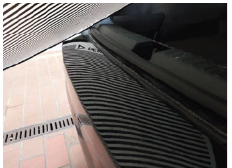
Stoßfänger / Hinten / Delle
