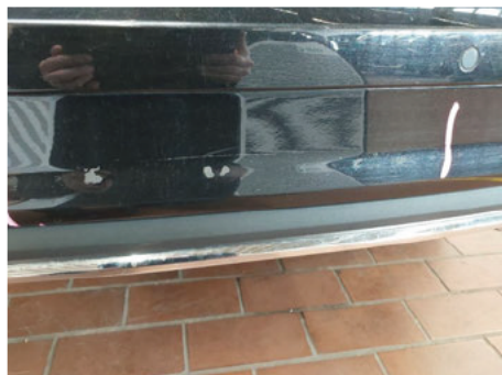
Stoßfänger / Hinten / Delle
