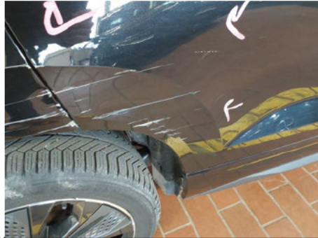
Tür / Hinten Rechts / Kratzer
