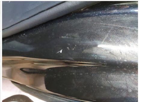
Türeinstieg / Hinten Links / Delle
