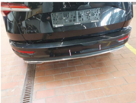
Stoßfänger / Hinten / Delle
