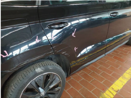
Tür / Hinten Rechts / Kratzer
