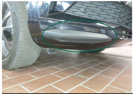
Stoßfängerleiste / Vorne Rechts / Kratzer
