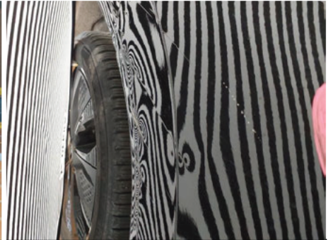
Tür / Hinten Rechts / Kratzer
