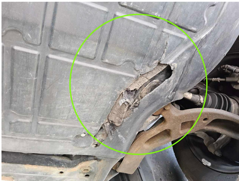
Bild 37 : Unterfahrschutz vorne gebrochen
