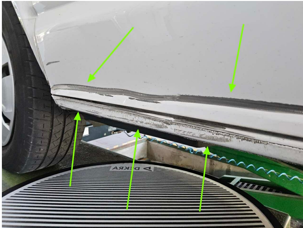
Bild 27 : Seitenschaden hinten rechts
