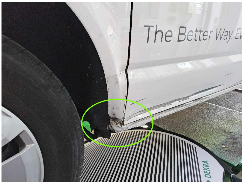
Bild 28 : Seitenschaden hinten rechts
