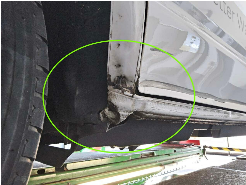
Bild 29 : Seitenschaden hinten rechts
