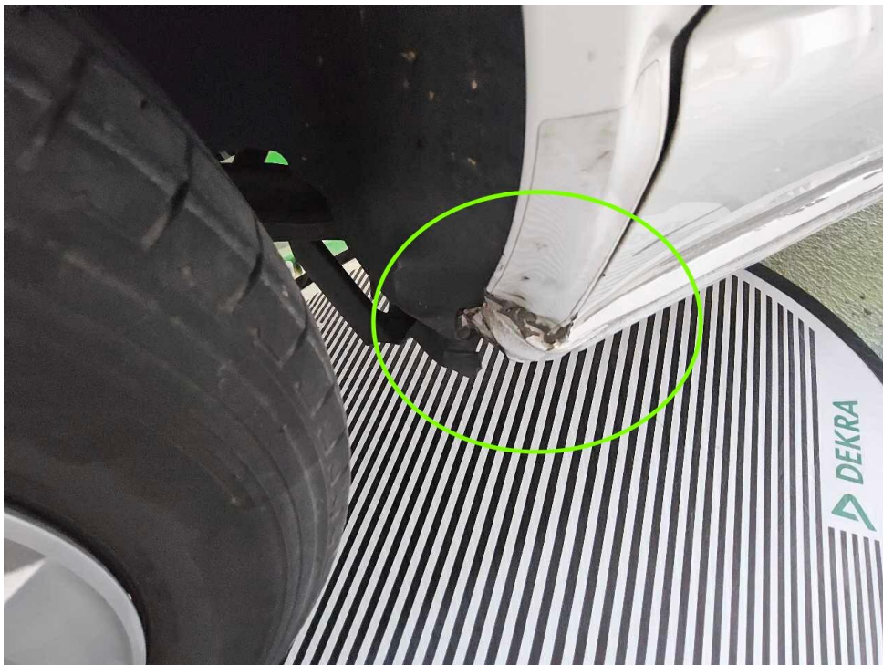
Bild 30 : Seitenschaden hinten rechts
