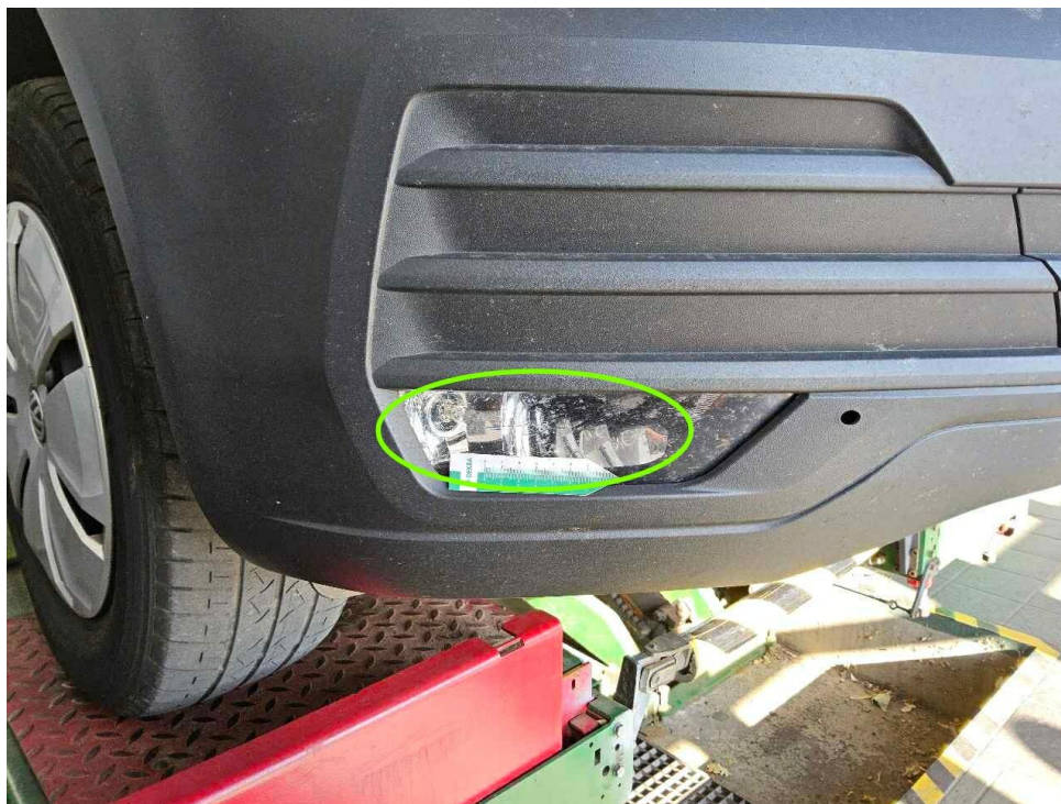
Bild 34 : Nebelscheinwerfer vorne rechts gerissen
