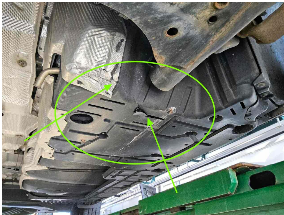
Bild 39 : Unterfahrschutz links mitte gebrochen
