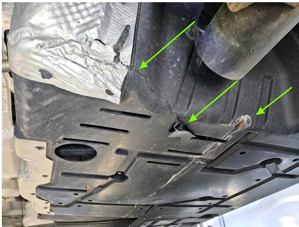
Bild 40 : Unterfahrschutz links mitte gebrochen
