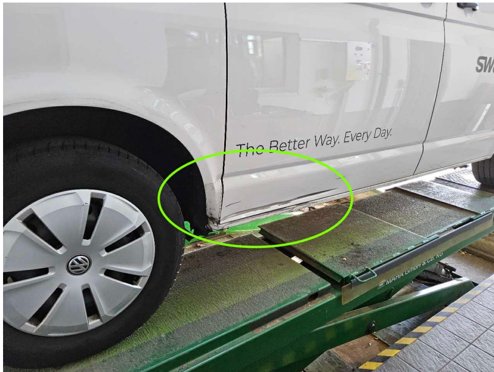
Bild 25 : Seitenschaden hinten rechts
