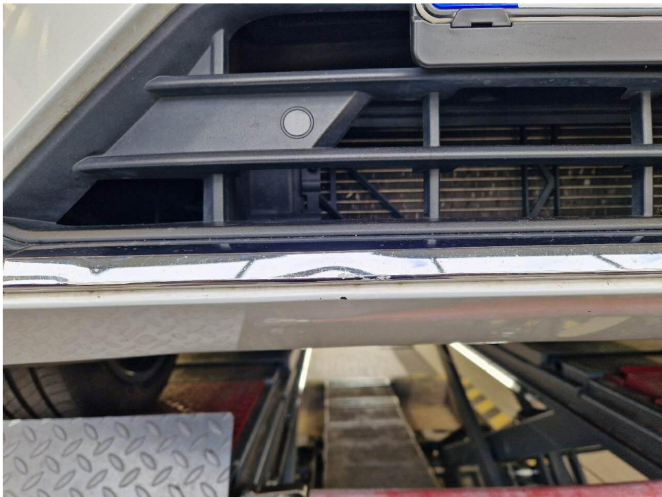
Bild 22 : Stoßfänger vorne rechts verschürt
