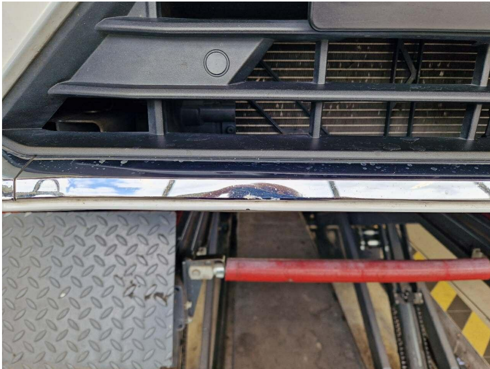
Bild 21 : Stoßfänger vorne rechts verschürt
