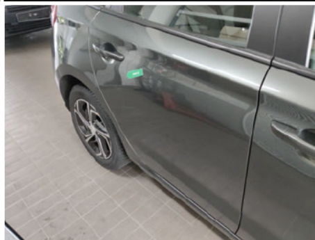
Tür / Hinten Rechts / Delle
