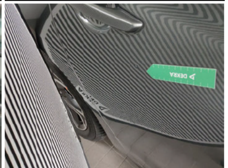
Tür / Hinten Rechts / Delle
