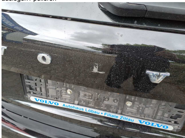
Beschädigung #5: Heckklappe/-tür: Heckklappe (Beschriftung VOLVO (L)) - fehlt - erneuern
