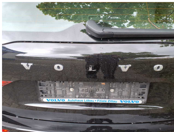
Beschädigung #5: Heckklappe/-tür: Heckklappe (Beschriftung VOLVO (L)) - fehlt - erneuern
