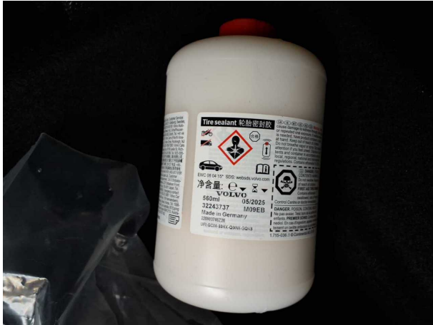
Beschädigung #1: Ausrüstung: Tirefit Füllmittel (05.2025) - abgelaufen - erneuern
