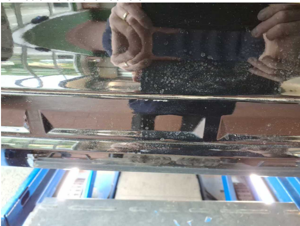
Beschädigung #13: Stossfänger hinten: Stossfänger hinten - verkratzt / verschürft - lackieren
