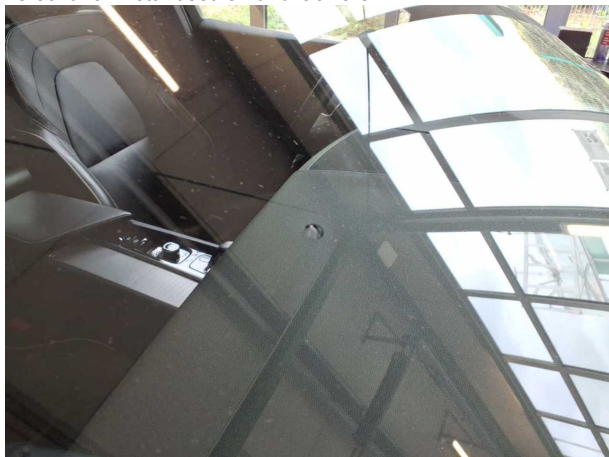
Beschädigung #16: Verglasung: Frontscheibe - Steinschlag - erneuern
