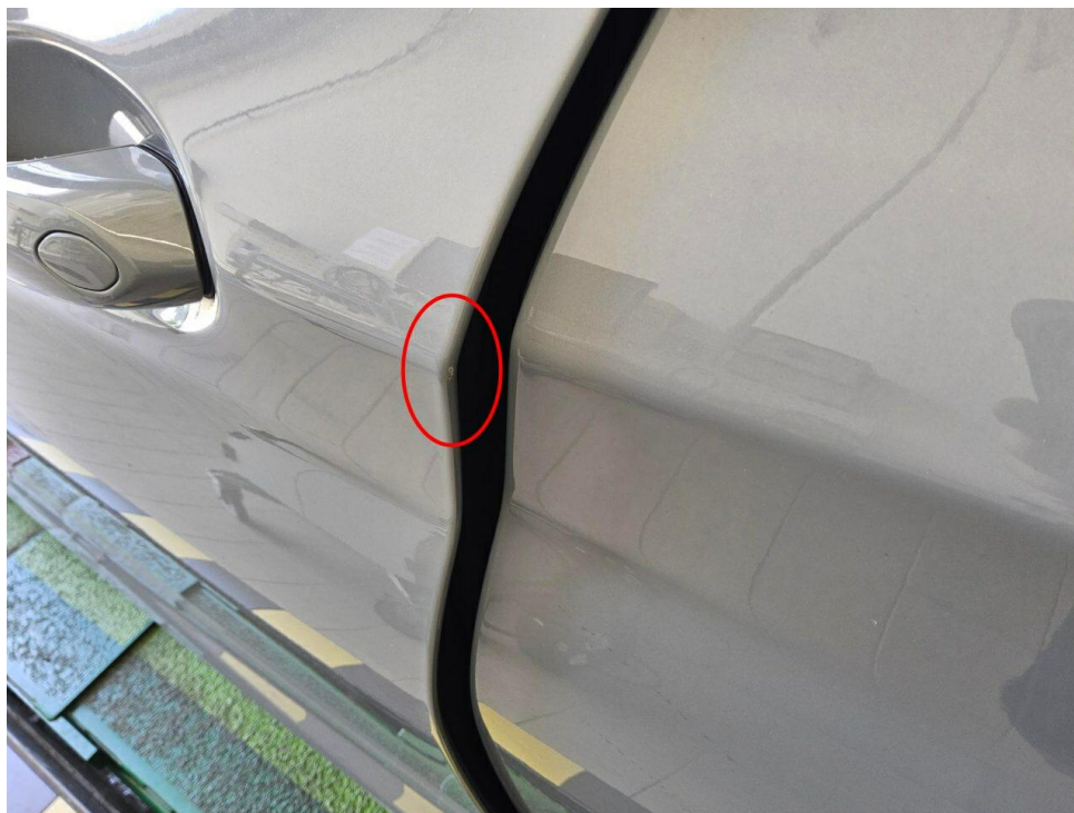
Bild 16 : Tür vorne links Türkante, Lackabplatzer, Gebrauchsspur
