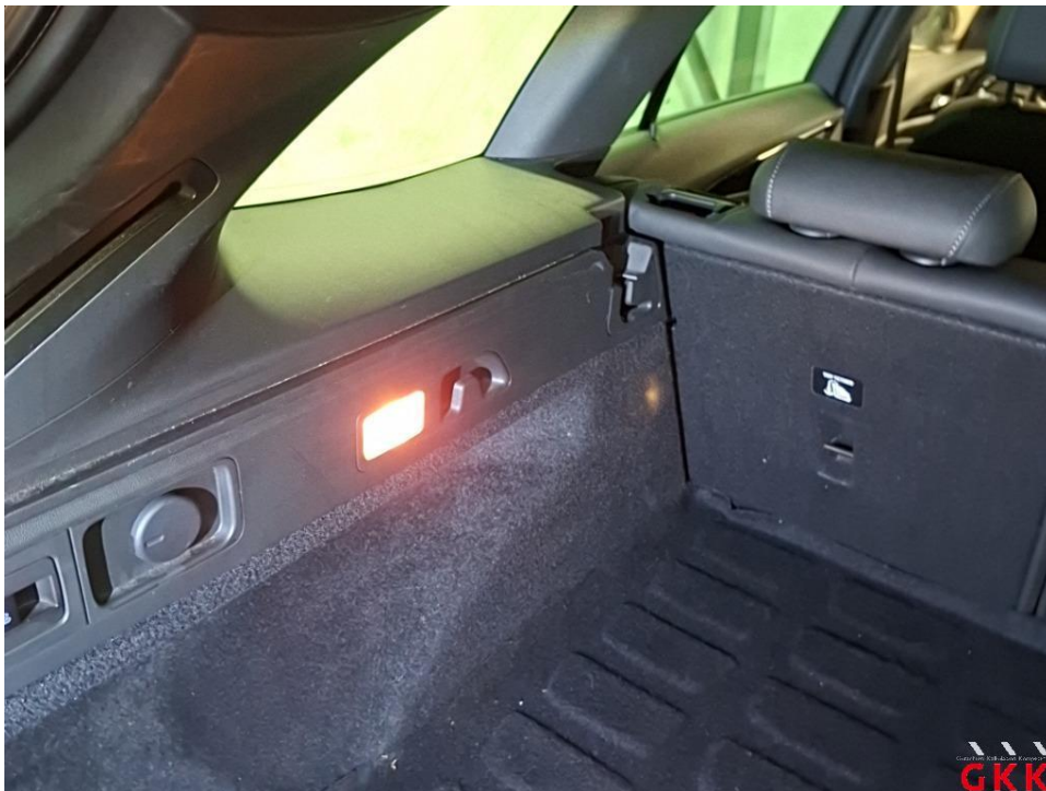
Bild 17 Laderaum, Abdeckung, fehlt, ersetzen
