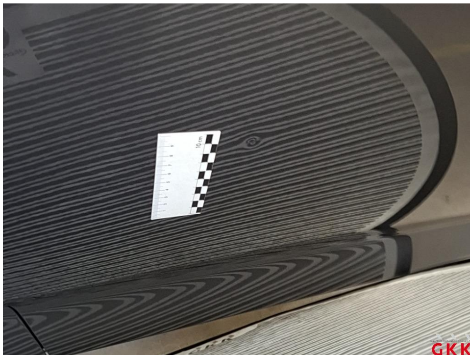
Bild 36 Tür vorne rechts, beschädigt, instand setzen - lackieren
