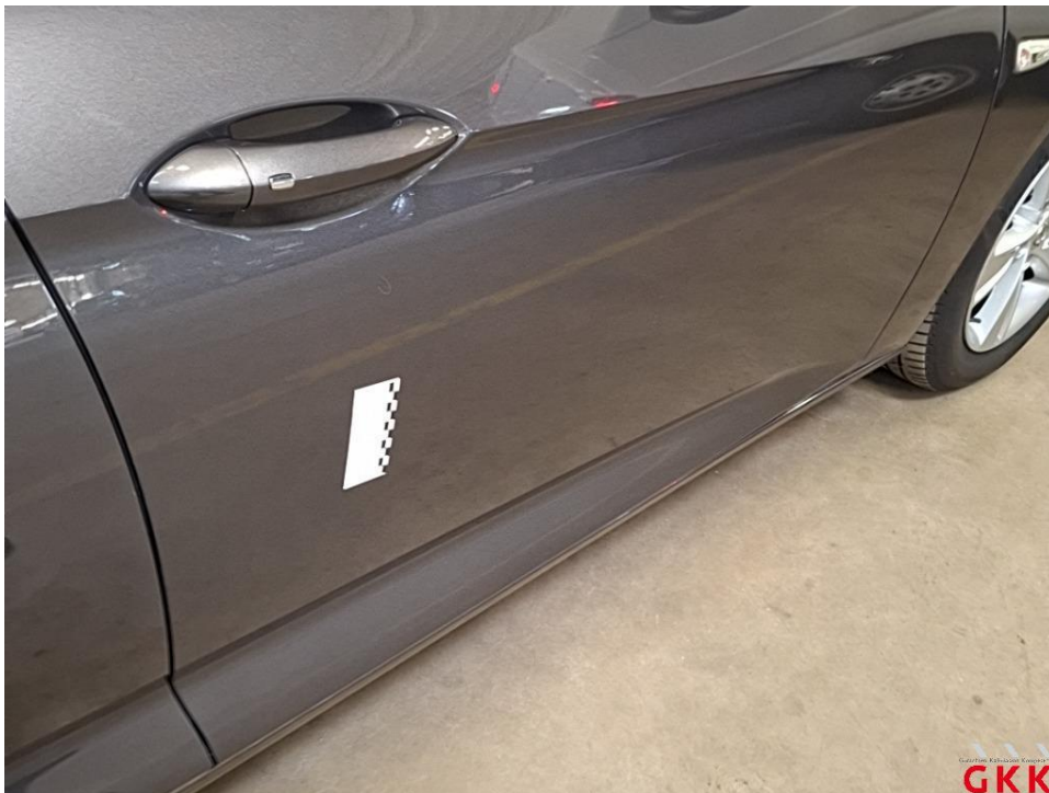
Bild 35 Tür vorne rechts, beschädigt, instand setzen - lackieren
