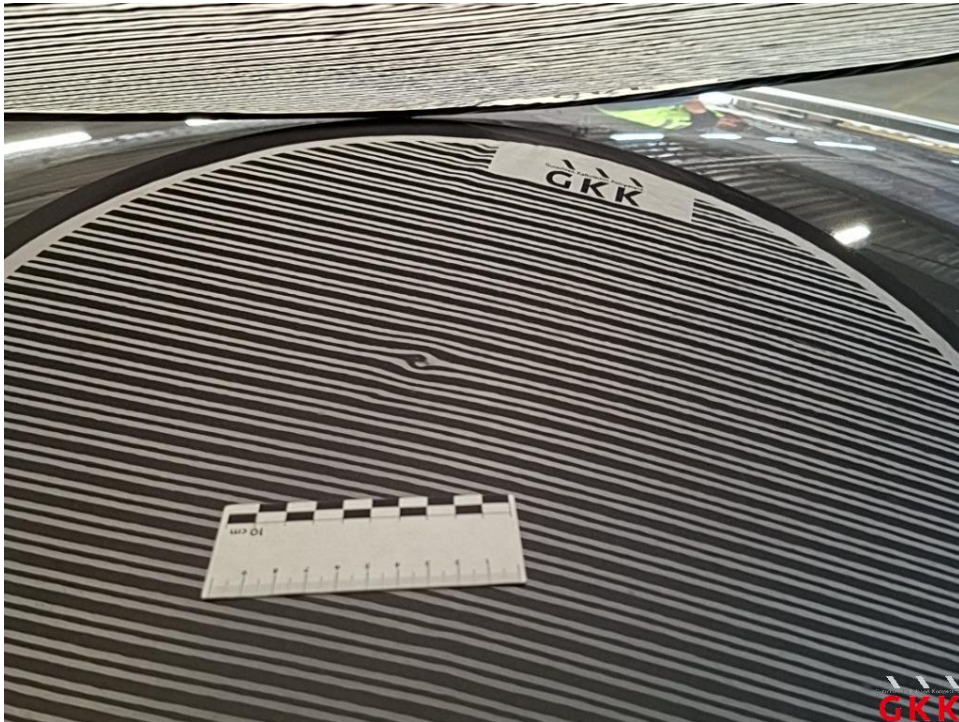
Bild 22 Fahrzeug, Hagelschaden, kalt drücken
