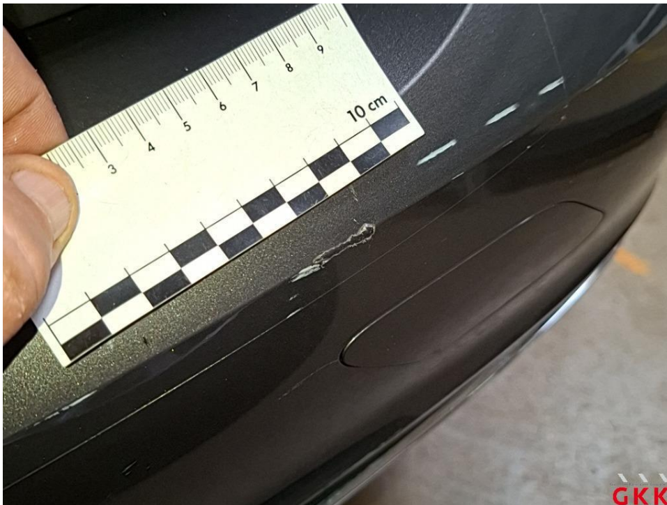
Bild 27 Stoßfänger hinten, Schutzfolie, beschädigt, ersetzen
