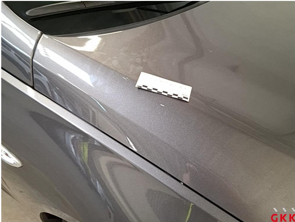
Bild 18 Motorhaube, Steinschlag und Kratzer, lackieren
