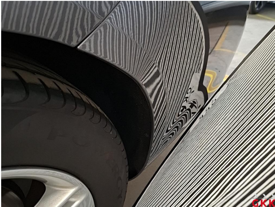
Bild 30 Stoßfänger hinten, Verkleidung -lackiert-, beschädigt, ersetzen
