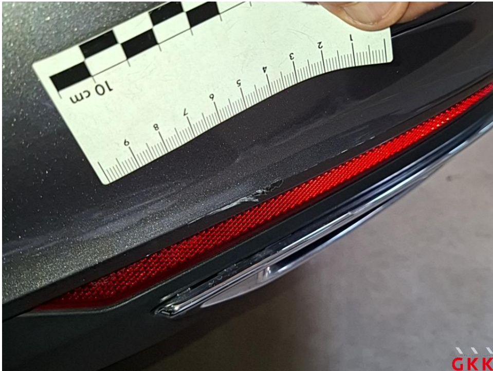
Bild 28 Stoßfänger hinten, Verkleidung -lackiert-, beschädigt, ersetzen
