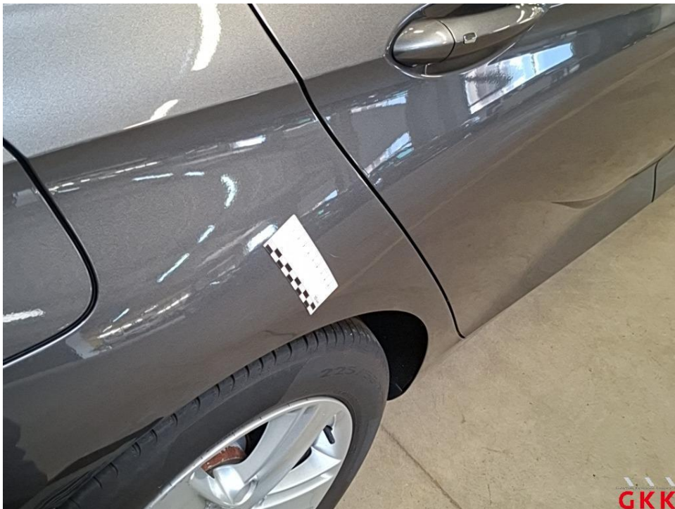
Bild 31 Seitenwand rechts, verkratzt, lackieren
