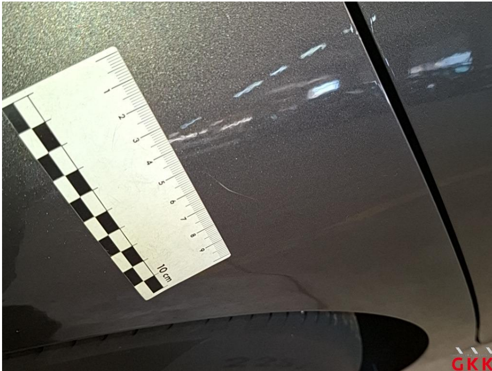
Bild 32 Seitenwand rechts, verkratzt, lackieren
