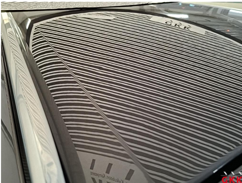
Bild 23 Fahrzeug, Hagelschaden, kalt drücken
