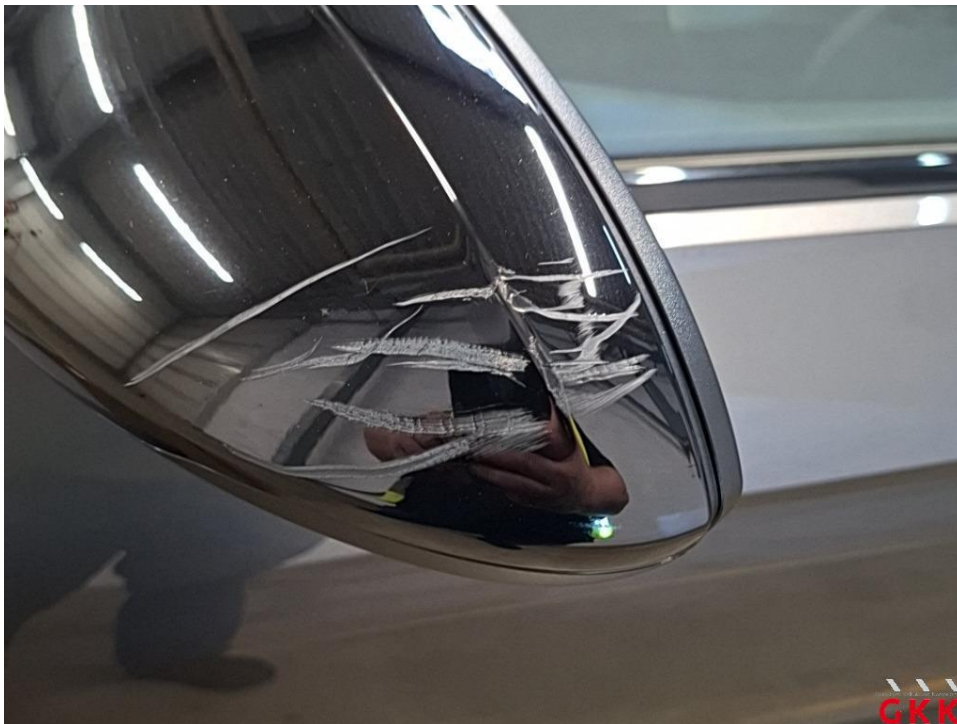
Bild 39 Spiegelgehäuse links, Kappe -lackiert-, beschädigt, ersetzen
