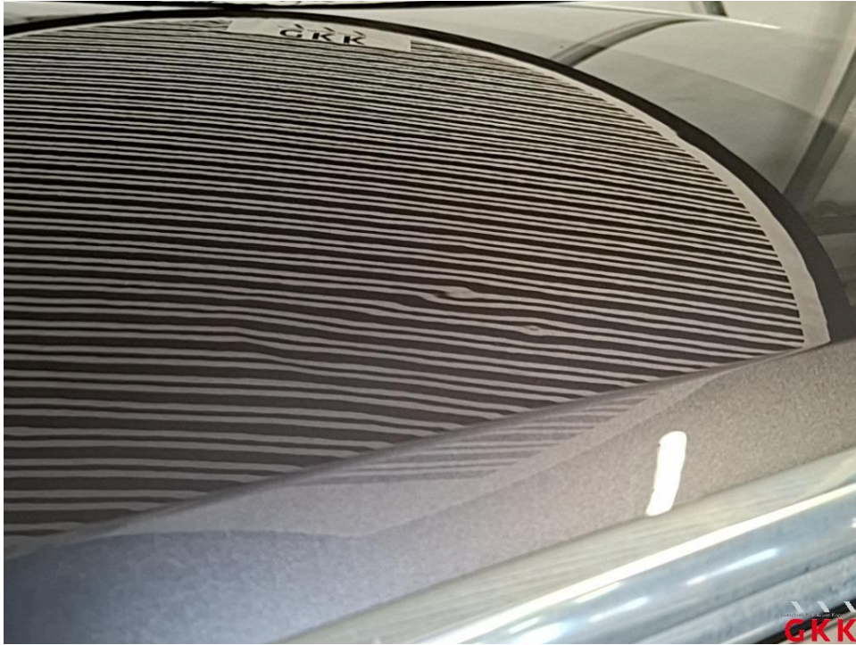
Bild 24 Fahrzeug, Hagelschaden, kalt drücken
