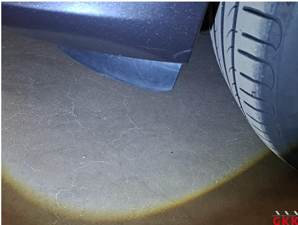
Bild 41 Stoßfänger vorne, Verkleidung unterhalb -lackiert-, verkratzt, Spotlackieren
