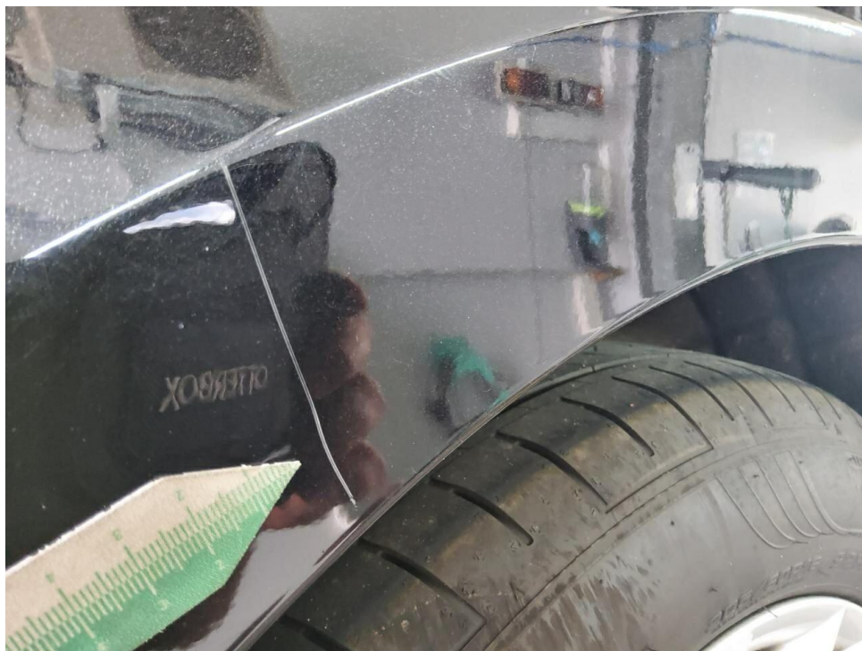
Bild 45 : Seitenwand links verschrammt
