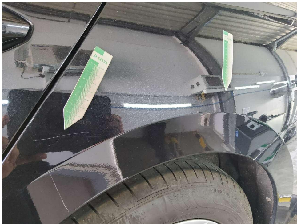
Bild 46 : Seitenwand links verschrammt
