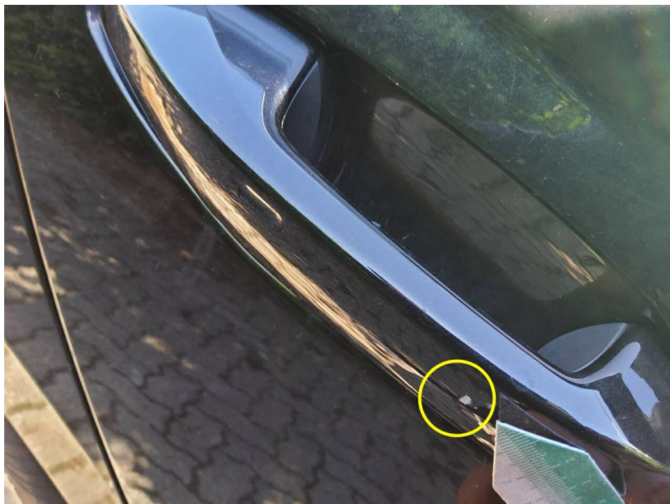
Bild 36 : Türgriff hinten rechts verschrammt
