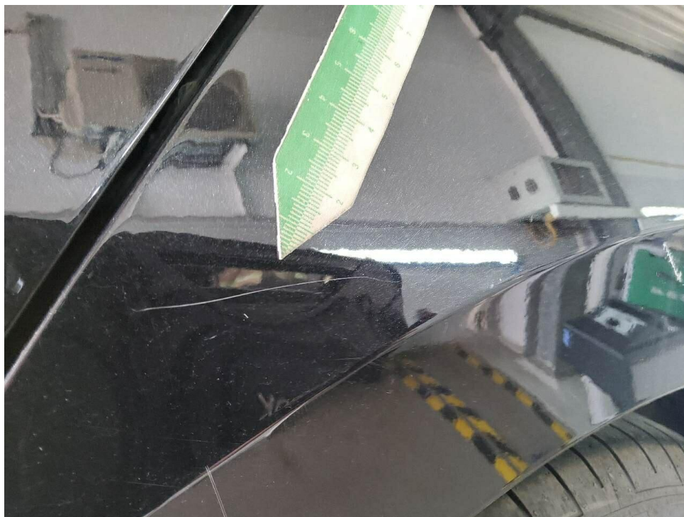
Bild 47 : Seitenwand links verschrammt
