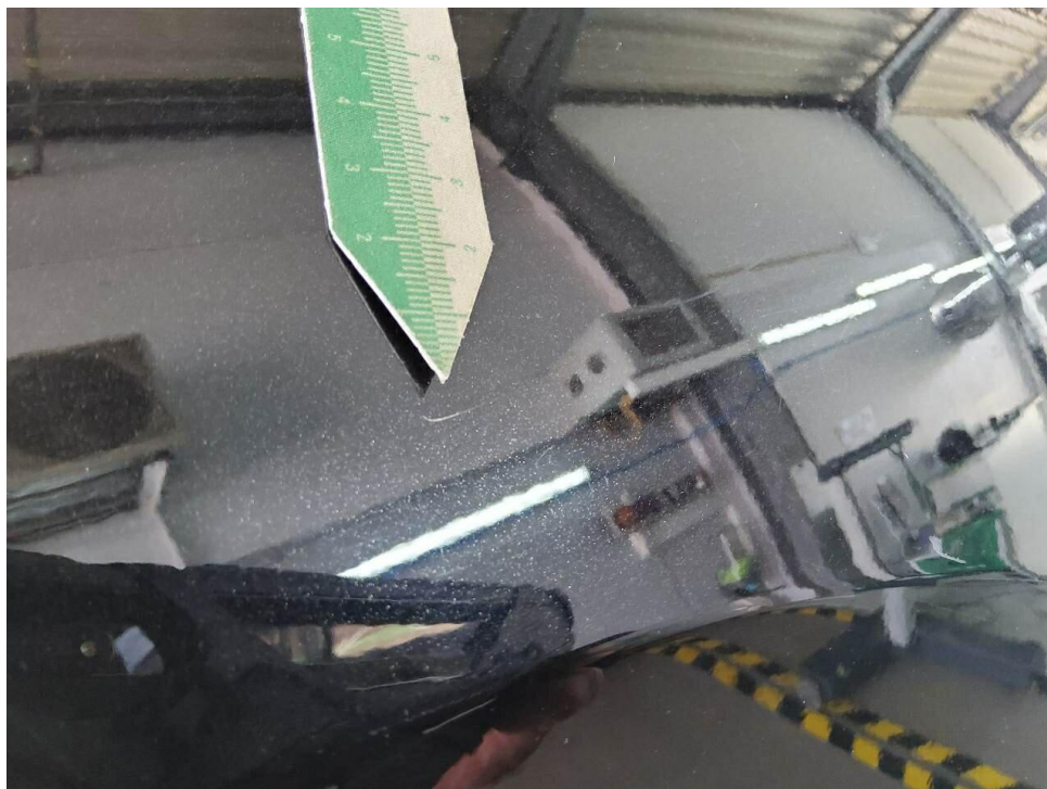
Bild 48 : Seitenwand links verschrammt
