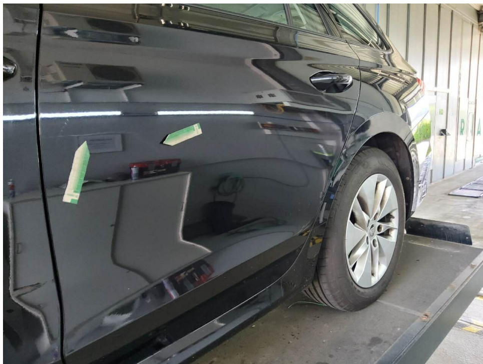
Bild 40 : Tür hinten links verschrammt
