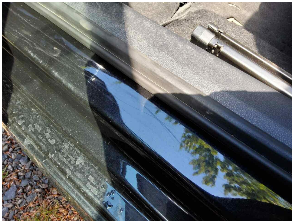
Bild 56 : Einstieg vorn links verschrammt
