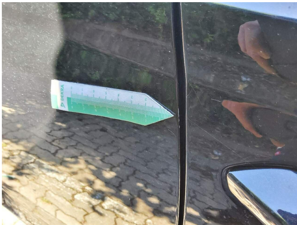
Bild 33 : Tür hinten rechts verschrammt
