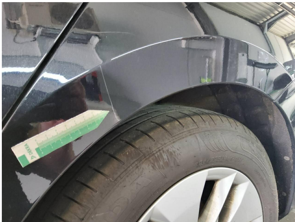
Bild 44 : Seitenwand links verschrammt
