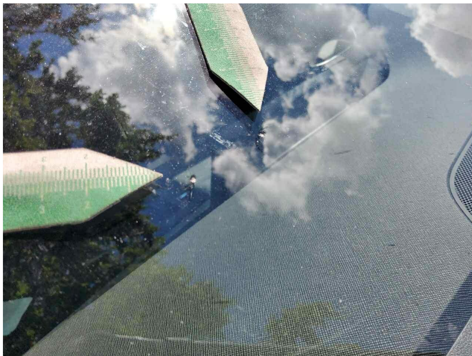
Bild 39 : Windschutzscheibe mehrere Steinschläge mit Rissbildung
