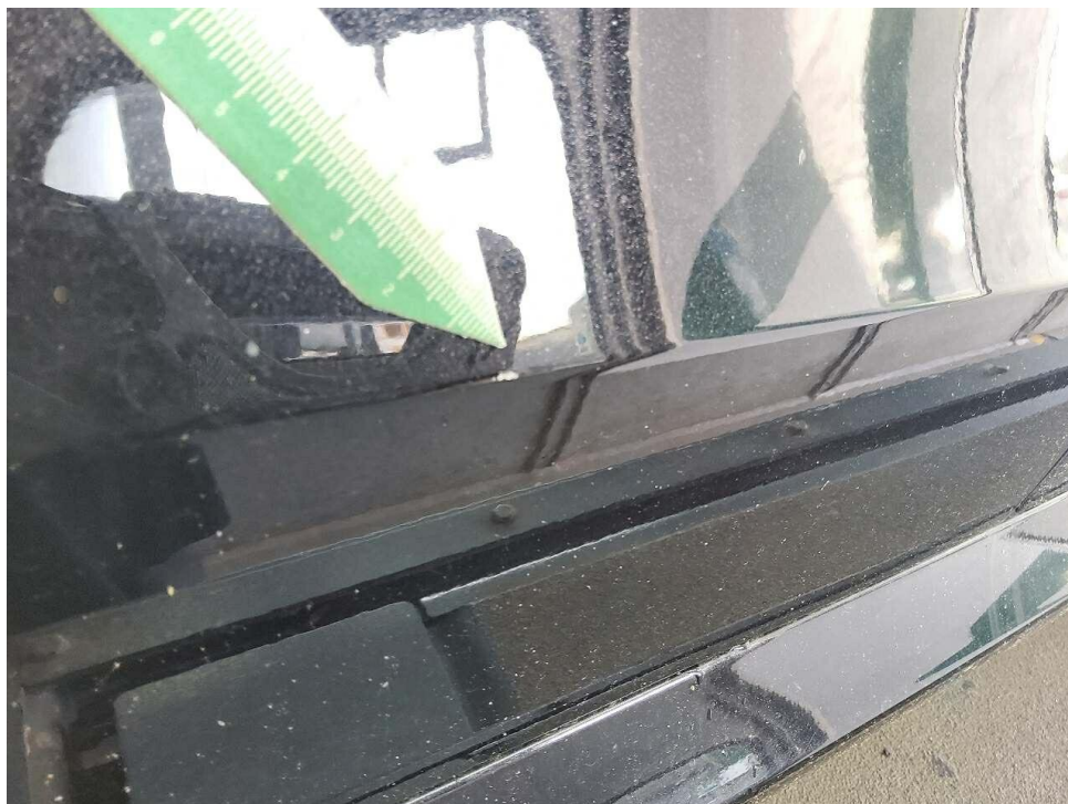
Bild 34 : Tür hinten rechts verschrammt
