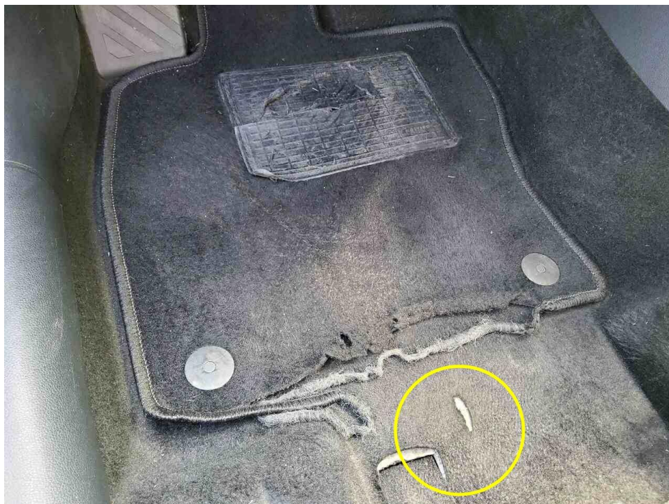
Bild 14 : Fußraumteppich vorn links aufgerissen
