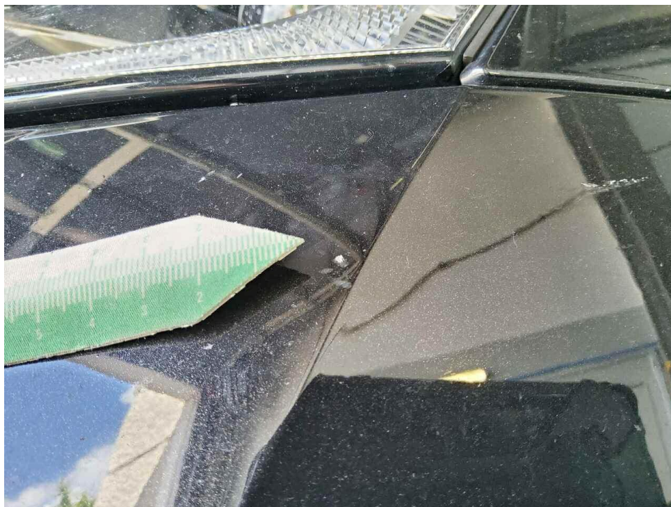
Bild 53 : Stoßfänger vorn Steinschläge
