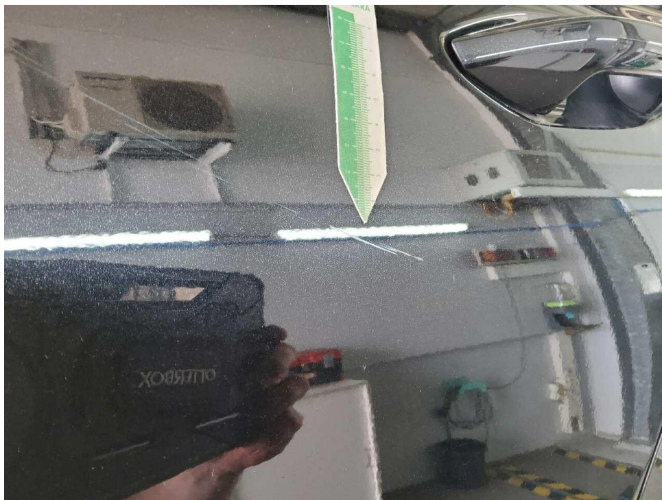
Bild 43 : Tür hinten links verschrammt
