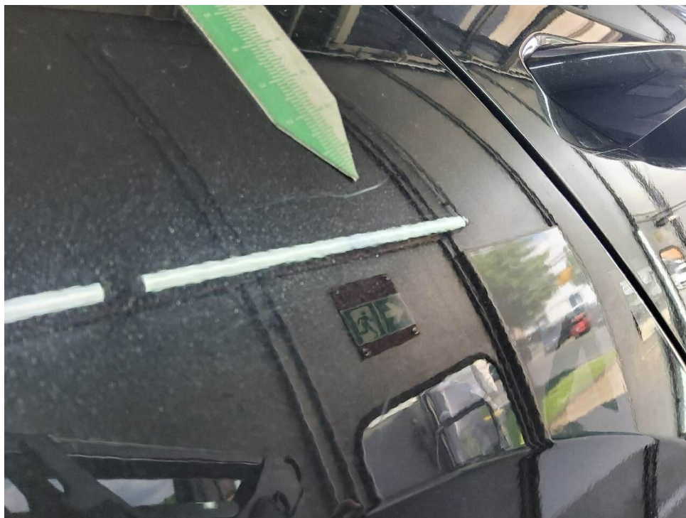
Bild 49 : Seitenwand rechts verschrammt
