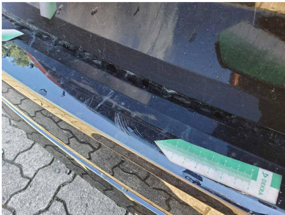
Bild 21 : Stoßfänger hinten mehrfach verschrammt und eingekerbt
