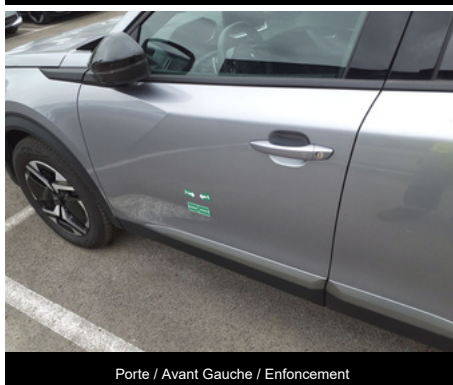
Porte / Avant Gauche / Enfoncement
