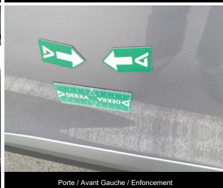
Porte / Avant Gauche / Enfoncement
