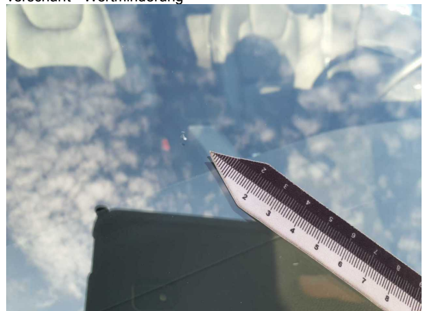
Beschädigung #2: Verglasung: Frontscheibe - Steinschlag - erneuern
