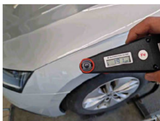
Lackstärke Kotflügel vorne links
