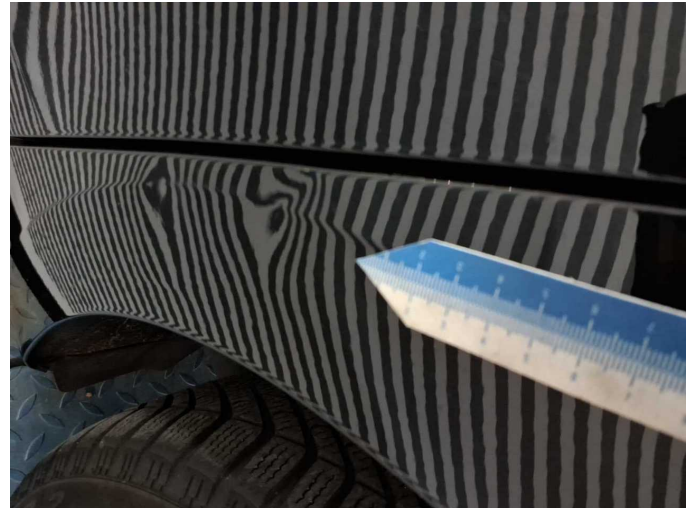
Damage 7: Side panel - rear left side: Elbow (Kante) - dent(s) - Paint
