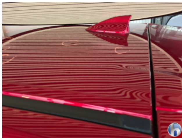
6. Dach Hagelschaden - Sanft Instandsetzen
