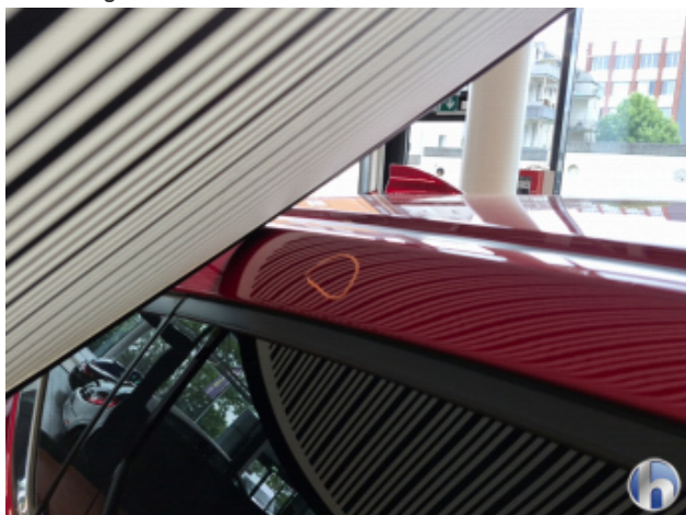
5. Dachrahmen - Rechts 1 Delle - Sanft Instandsetzen
