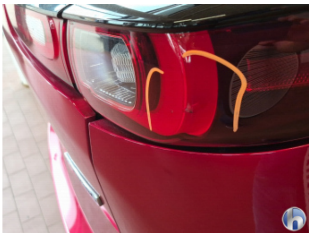
13. Rückleuchte Rechts Beschädigt - Erneuern
