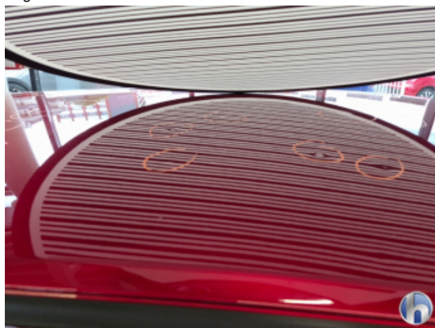
6. Dach Hagelschaden - Sanft Instandsetzen
