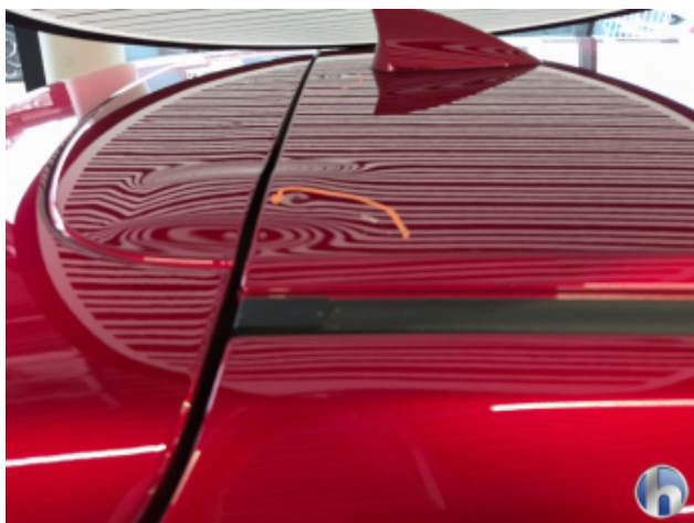
6. Dach Hagelschaden - Sanft Instandsetzen
