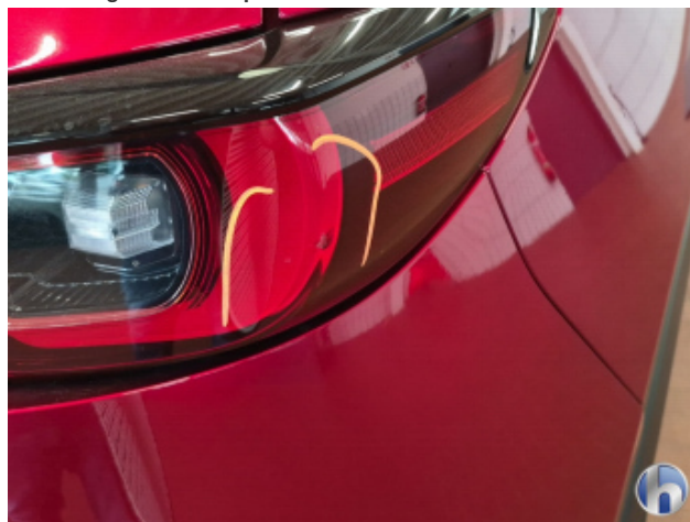
13. Rückleuchte Rechts Beschädigt - Erneuern
