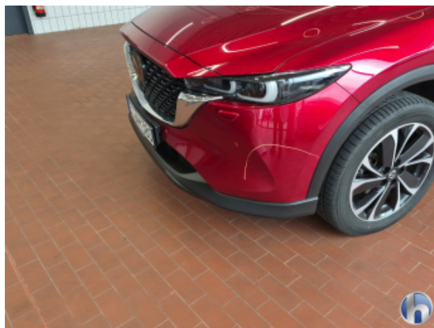
2. Stoßfänger Vorne Abschürfung - Smart Repair
