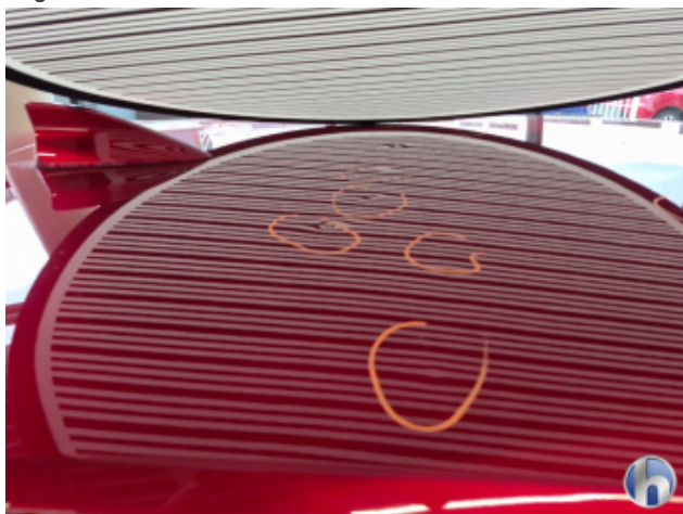
6. Dach Hagelschaden - Sanft Instandsetzen
