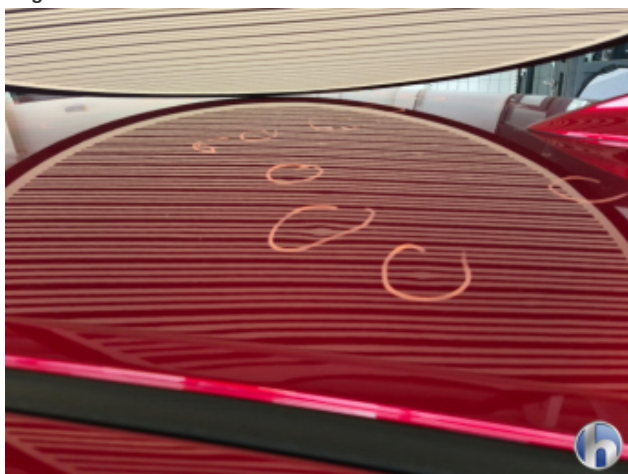
6. Dach Hagelschaden - Sanft Instandsetzen
