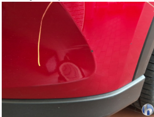
2. Stoßfänger Vorne Abschürfung - Smart Repair
