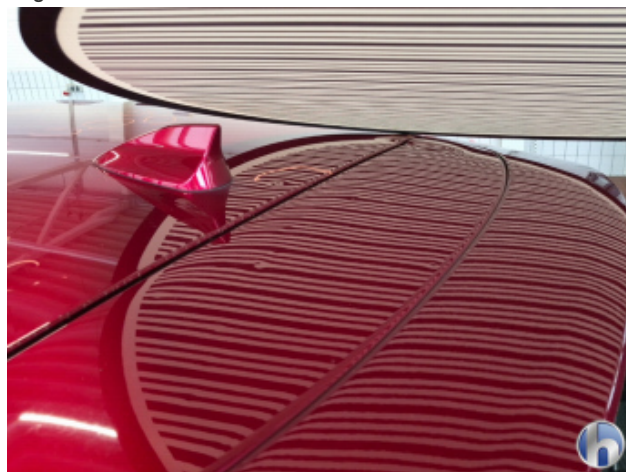
7. Heckklappe Hagelschaden - Sanft Instandsetzen
