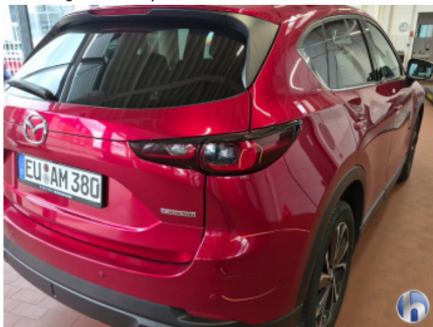
13. Rückleuchte Rechts Beschädigt - Erneuern
