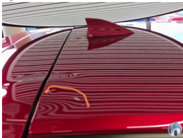
6. Dach Hagelschaden - Sanft Instandsetzen
