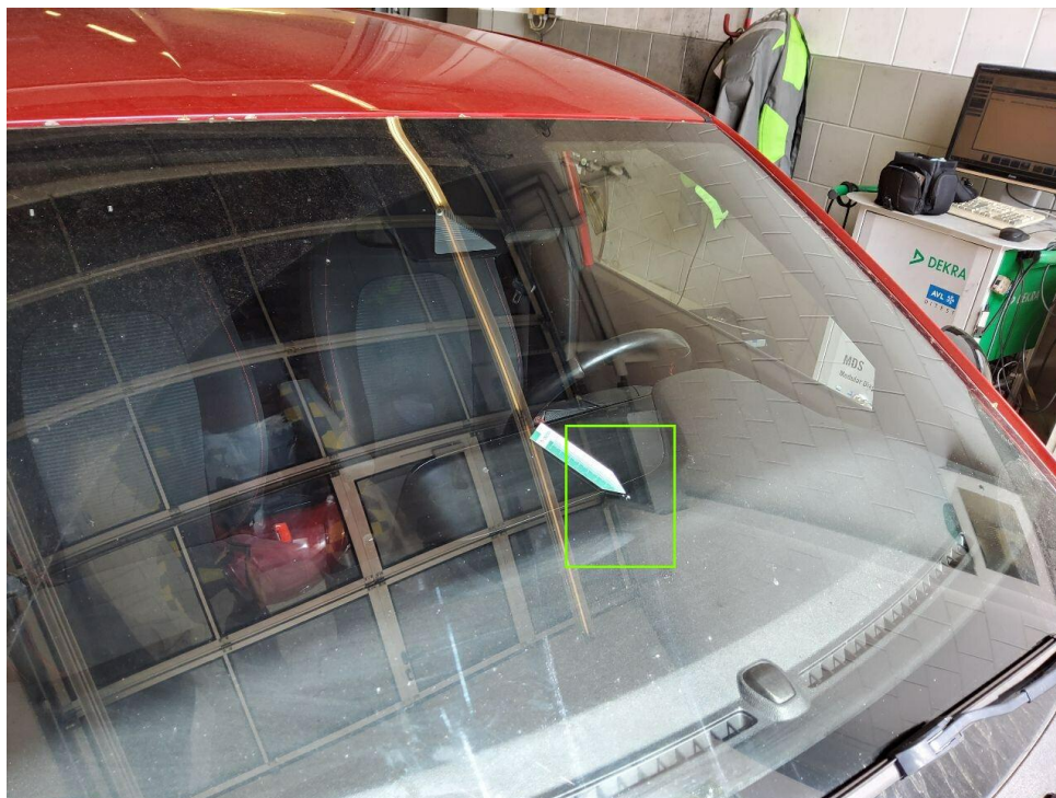
Bild 9 : Frontscheibe, Steinschlag mit Rissbildung
