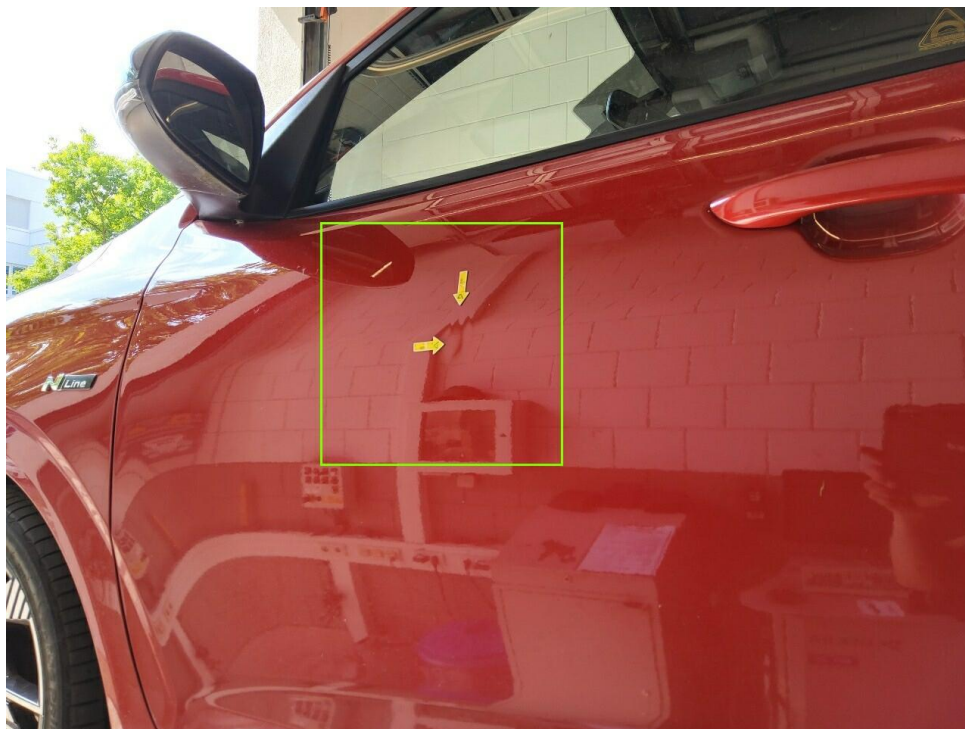
Bild 17 : Tür vorne links, mehrfach eingedellt, instandsetzen und lackieren mit Lackaufbau
