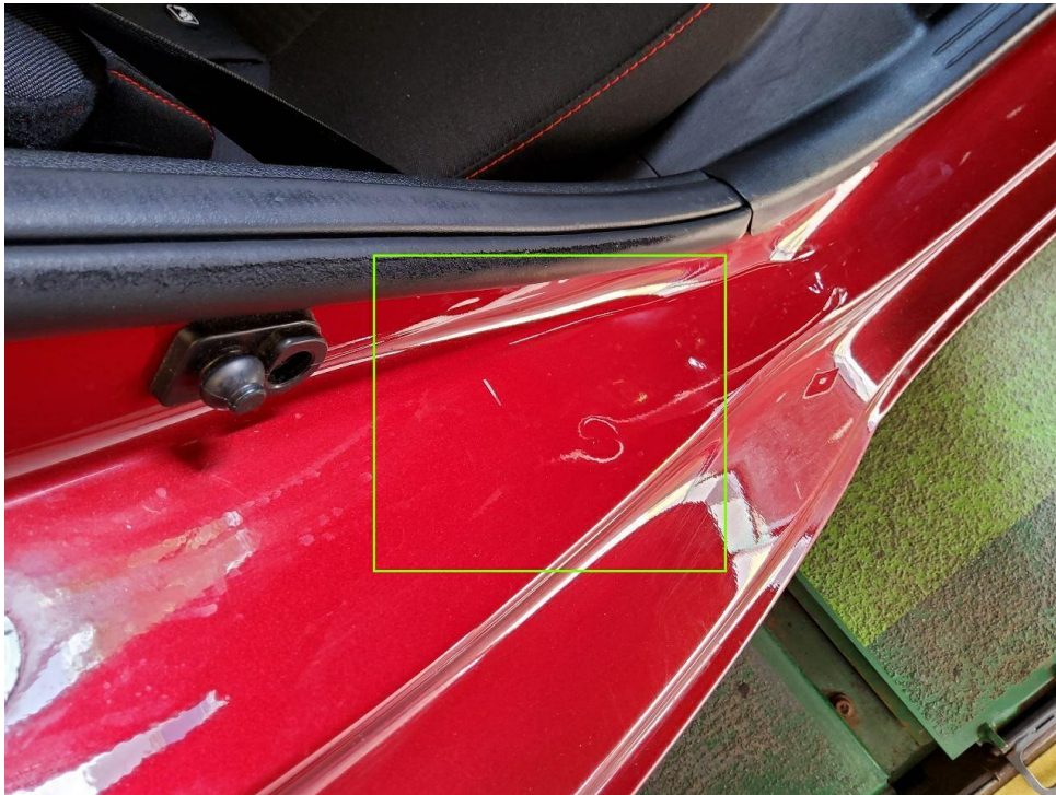
Bild 15 : Tür hinten rechts Einstieg, zerkratzt, smart repair
