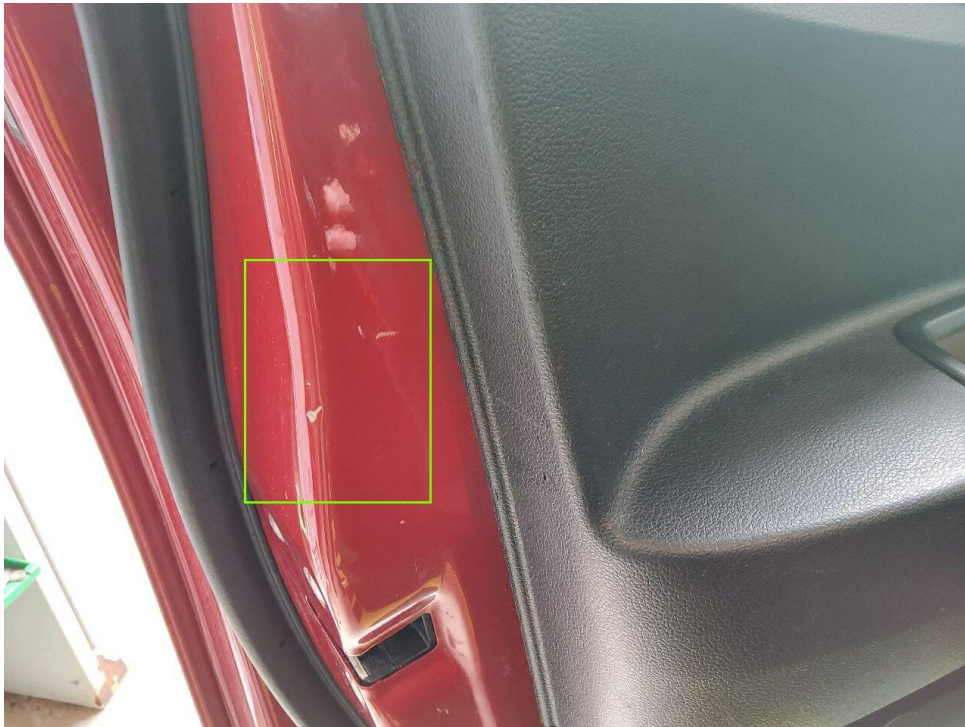
Bild 13 : Tür vorne links Türrahmen, zerkratzt, smart repair
