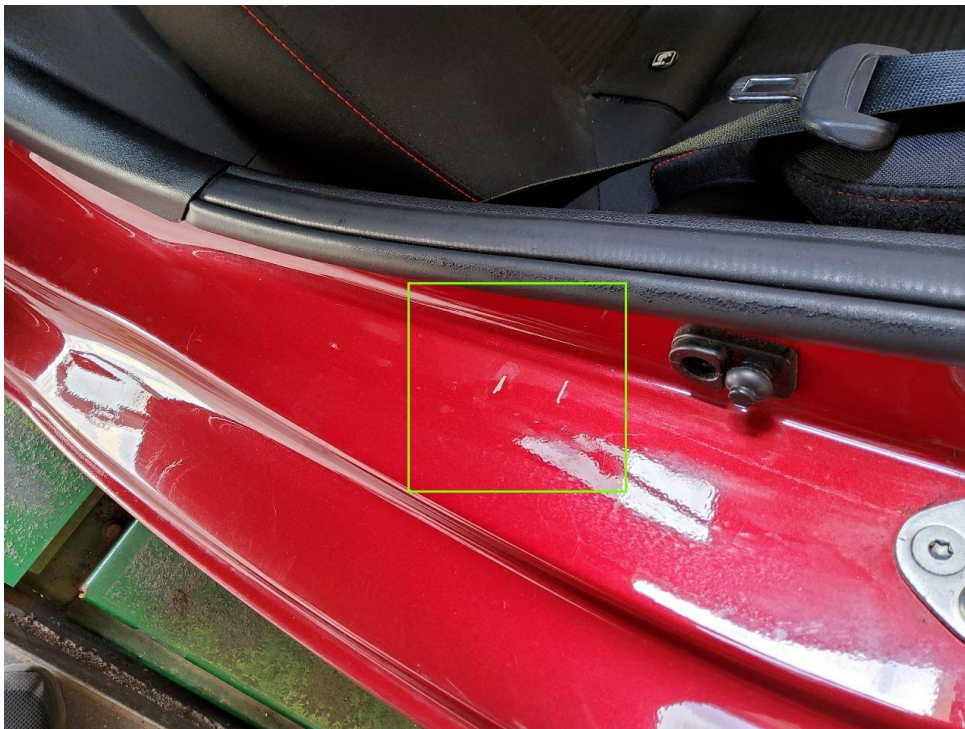
Bild 14 : Tür hinten links Einstieg, zerkratzt, smart repair
