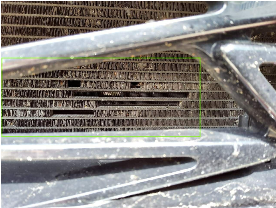
Bild 19 : Klimakondensator, Kühllamellen gebrochen
