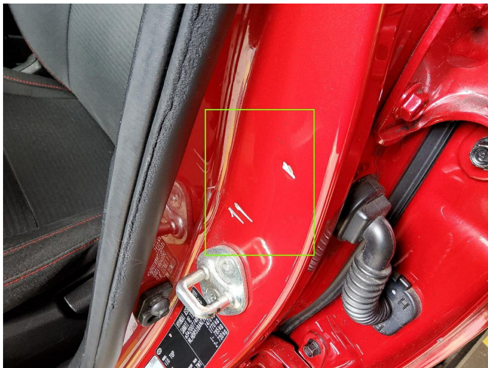
Bild 11 : Tür vorne links Einstieg, zerkratzt, smart repair
