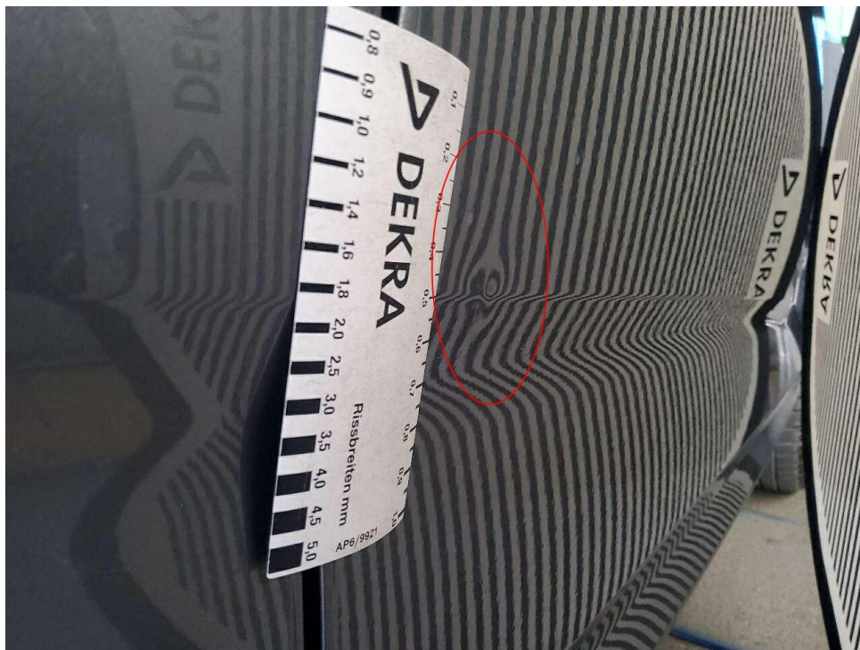
Bild 21 : Tür vorne rechts, eingedellt (Kante)
