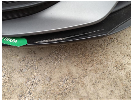
Paragolpes / Delantero / Abolladura
