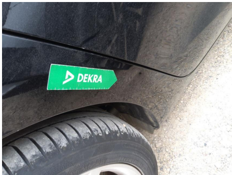
Aleta / Trasero Derecho / Abolladura
