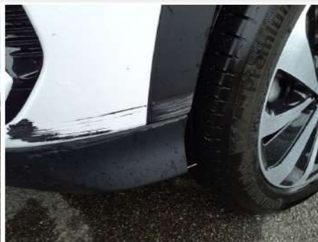
Modanatura parafrangente / Anteriore Sinistro / Riga
