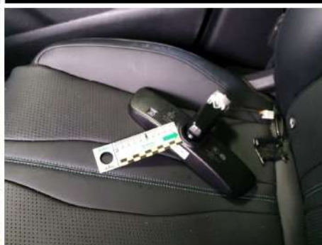
Specchio retrovisore frontale / Anteriore / Rotto
