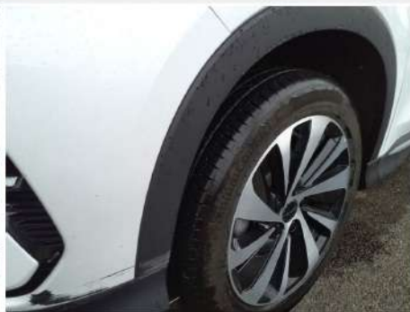
Modanatura parafrangente / Anteriore Sinistro / Riga
