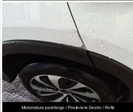
Parafrangente / Posteriore Destro / Rientranza
