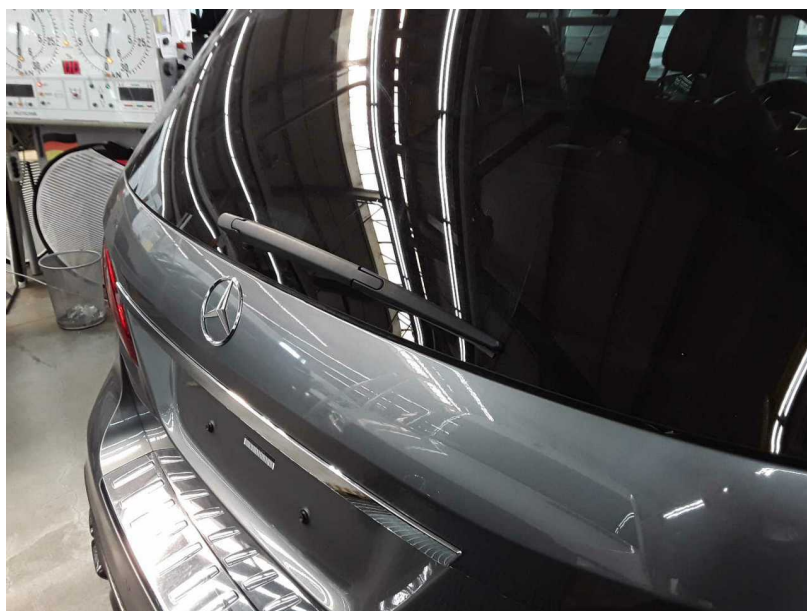
Beschädigung #1: Scheibenreinigung: Scheibenwischerblatt hinten - gebrochen / gerissen - erneuern
