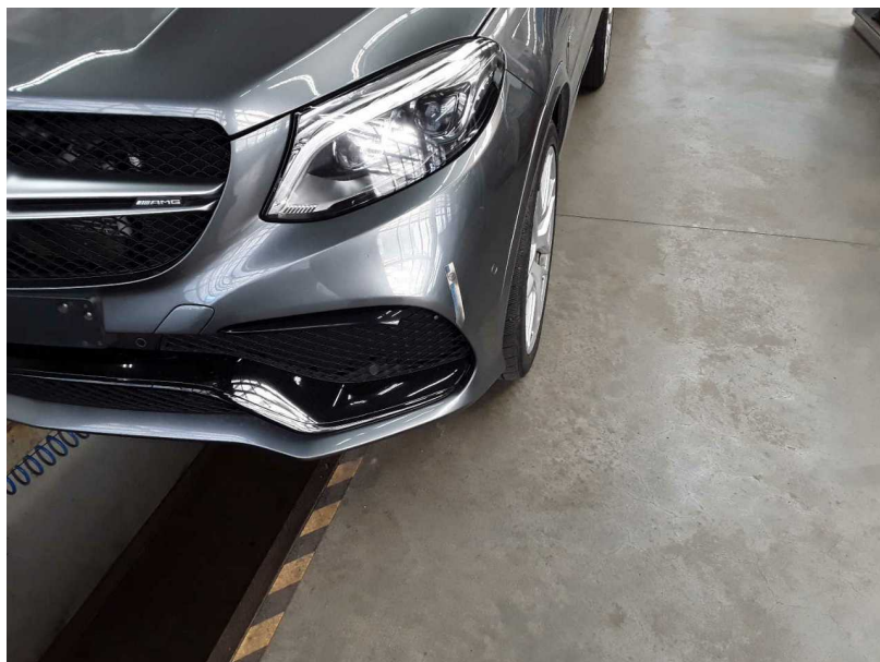
Beschädigung #3: Stossfänger vorn: Stossfänger mit Parktronic - Kratzer - Smart Repair
