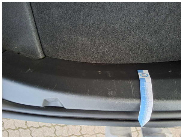
Beschädigung #1: Verkleidungen/Abdeckungen: Verkleidung Ladekante - verkratzt / verschürft - erneuern
