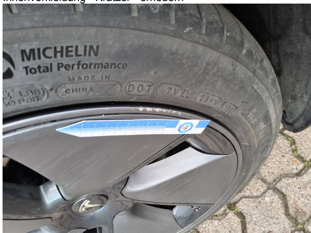
Beschädigung #3: Rad/Reifen: Leichtmetallfelge hinten rechts - Kratzer - Wertminderung
