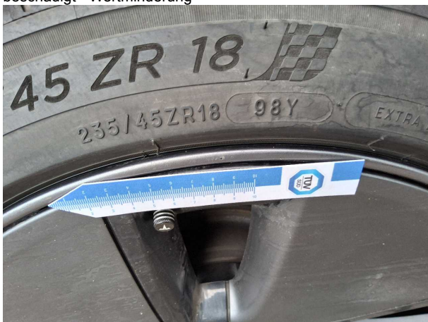
Beschädigung #5: Rad/Reifen: Leichtmetallfelge vorn rechts - Kratz... Wertminderung
