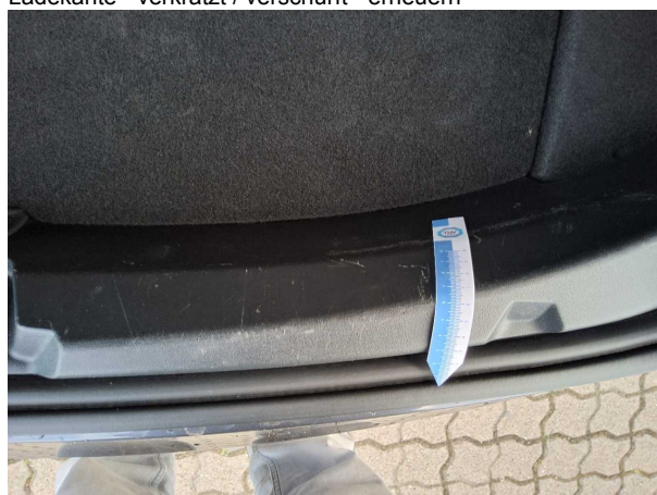
Beschädigung #1: Verkleidungen/Abdeckungen: Verkleidung Ladekante - verkratzt / verschürft - erneuern
