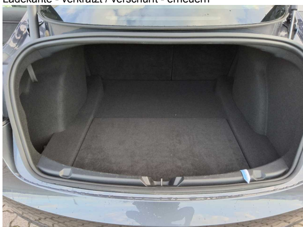
Beschädigung #1: Verkleidungen/Abdeckungen: Verkleidung Ladekante - verkratzt / verschürft - erneuern
