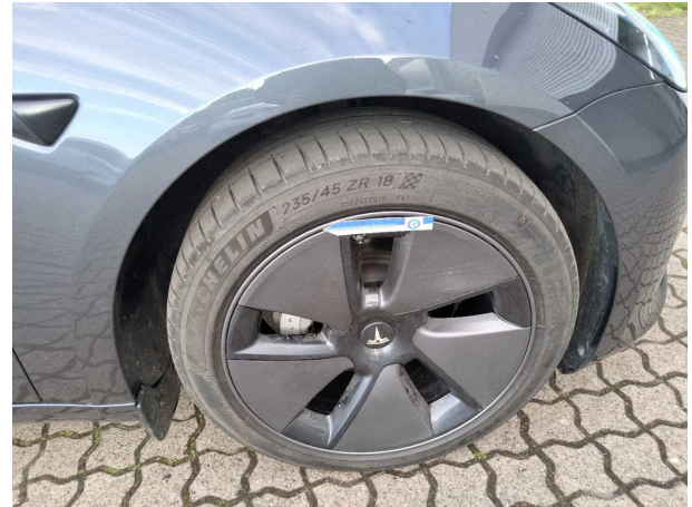
Beschädigung #5: Rad/Reifen: Leichtmetallfelge vorn rechts - Kratzer - Wertminderung
