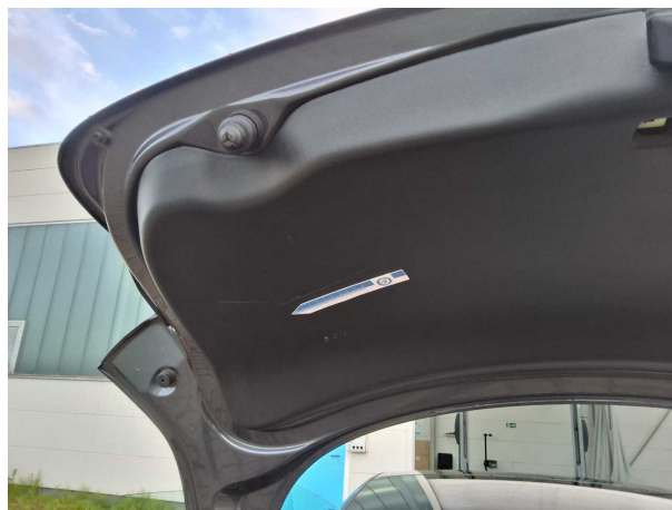
Beschädigung #2: Verkleidungen/Abdeckungen: Heckdeckel, Innenverkleidung - Kratzer - erneuern
