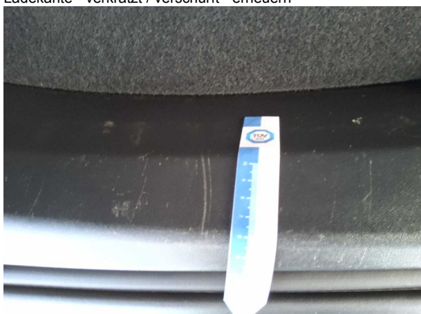
Beschädigung #1: Verkleidungen/Abdeckungen: Verkleidung Ladekante - verkratzt / verschürft - erneuern
