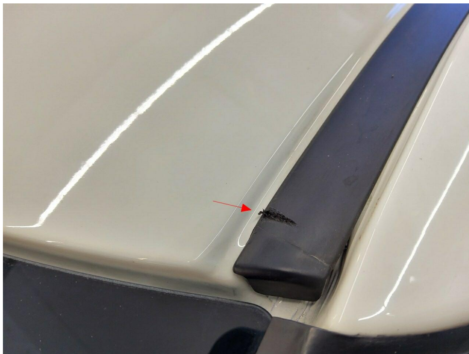
Bild 9 : Dachzierleiste links beschädigt
