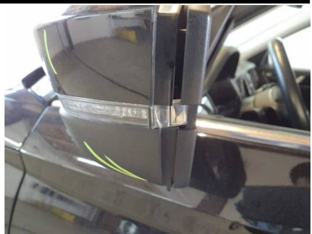
Beschädigung #11: Außenspiegel links: Spiegelgehäuse (+ Blinker) - beschädigt - erneuern
