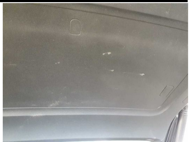
Beschädigung #6: Verkleidungen/Abdeckungen: Heckdeckel, Innenverkleidung - verkratzt / verschürft - erneuern
