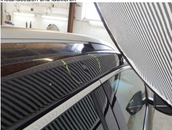
Beschädigung #12: Fahrzeugdach: Dachholm rechts - Delle(n) - instandsetzen und lackieren
