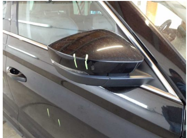
Beschädigung #7: Außenspiegel rechts: Abdeckkappe - verkratzt / verschürft - Smart Repair
