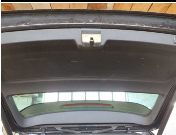
Beschädigung #6: Verkleidungen/Abdeckungen: Heckdeckel, Innenverkleidung - verkratzt / verschürft - erneuern
