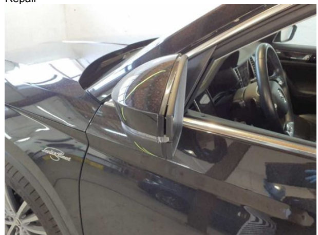
Beschädigung #11: Außenspiegel links: Spiegelgehäuse (+ Blinker) - beschädigt - erneuern
