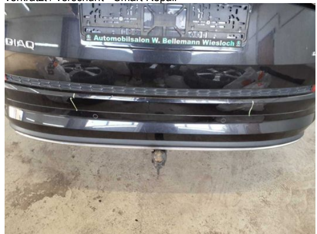
Beschädigung #8: Stoßfänger hinten: Stoßfänger hinten - verkratzt / verschürft - Smart Repair
