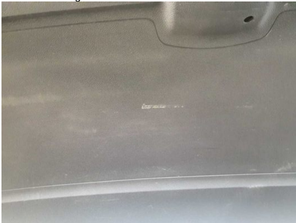
Beschädigung #6: Verkleidungen/Abdeckungen: Heckdeckel, Innenverkleidung - verkratzt / verschürft - erneuern
