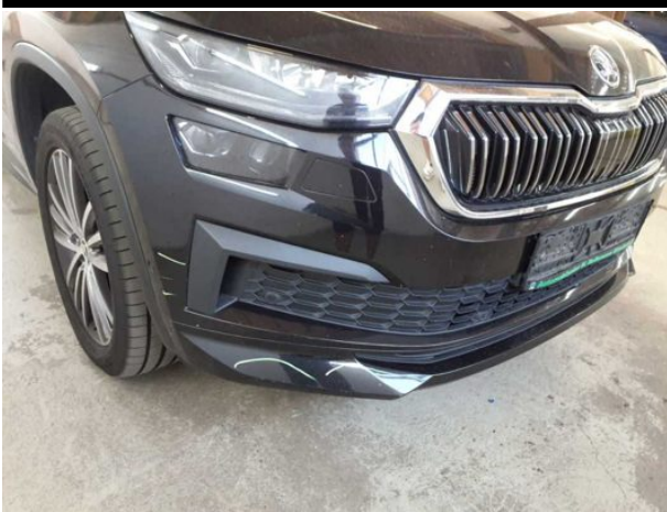
Beschädigung #13: Stossfänger vorn: Stossfänger vorn - verkratzt / verschürft - instandsetzen und lackieren
