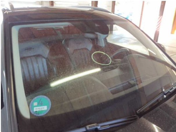
Beschädigung #15: Verglasung: Frontscheibe mit Regensensor (Mit Rissbildung) - Steinschlag - erneuern
