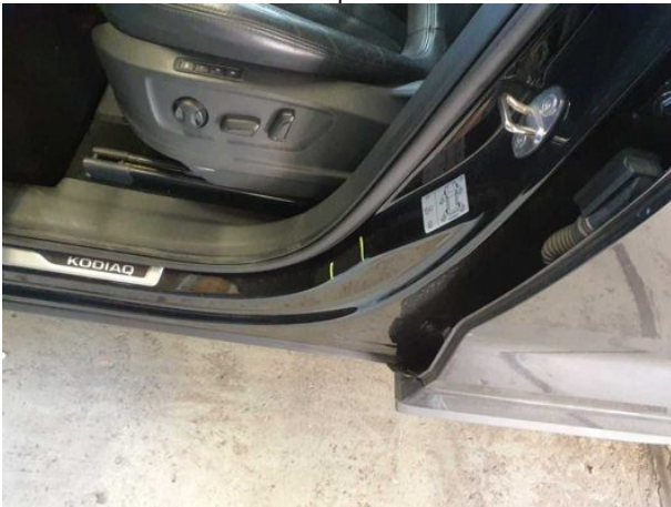
Beschädigung #9: Schweller links: Einstieg - Delle(n) - Smart Repair
