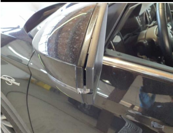
Beschädigung #11: Außenspiegel links: Spiegelgehäuse (+ Blinker) - beschädigt - erneuern
