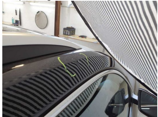
Beschädigung #12: Fahrzeugdach: Dachholm rechts - Delle... - instandsetzen und lackieren
