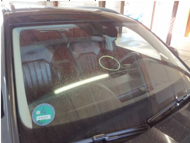
Damage #15: Vehicle glazing: Windscreen with rain sensor (Mit Rissbildung) - Stone chips - Replace
