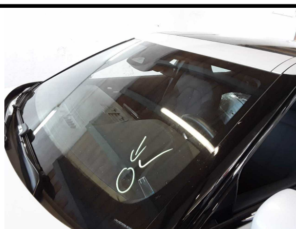
Beschädigung #9: Verglasung: Frontscheibe (Rissbildung) - Steinschlag - erneuern
