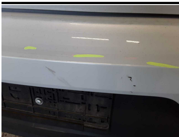
Beschädigung #5: Stossfänger hinten: Stossfänger hinten - Kratzer - auslegen / polieren
