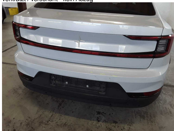
Beschädigung #5: Stossfänger hinten: Stossfänger hinten - Kratzer - auslegen / polieren
