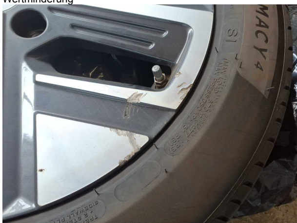
Beschädigung #3: 2.Radsatz: 1 Leichtmetallfelge - verkratzt / verschürft - Wertminderung
