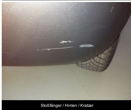
Stoßfänger / Hinten / Kratzer
