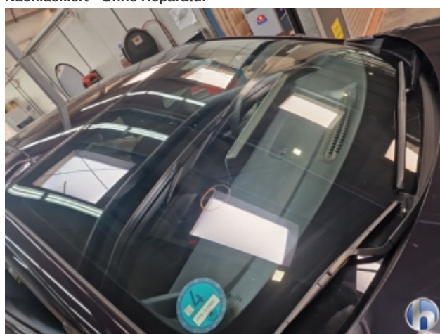
3. Windschutzscheibe Steinschlag - Smart Repair
