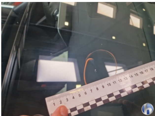
3. Windschutzscheibe Steinschlag - Smart Repair
