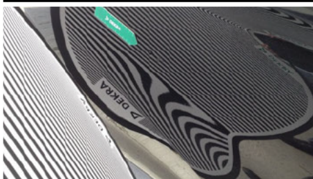
Tür / Hinten Rechts / Delle
