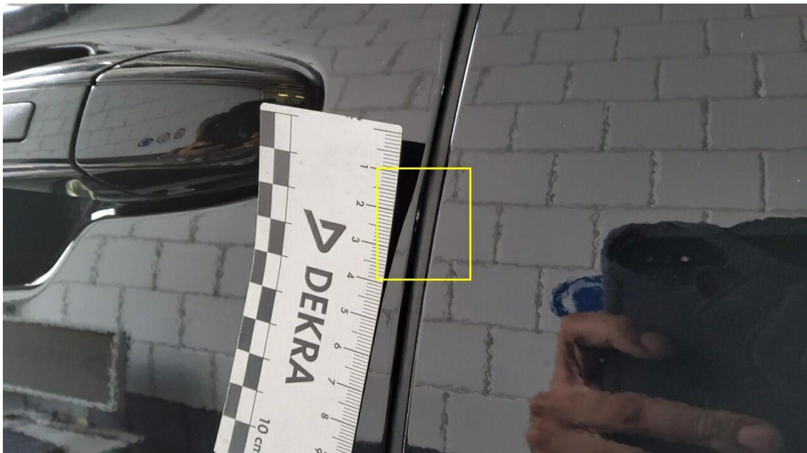
Bild 10 : Tür vorne links Türkante, zerkratzt, Gebrauchsspur
