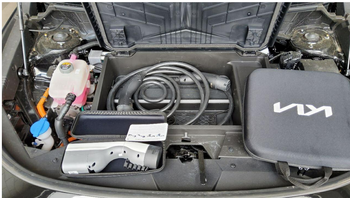
Bild 7 : Ladekabel beim E-Fahrzeug
