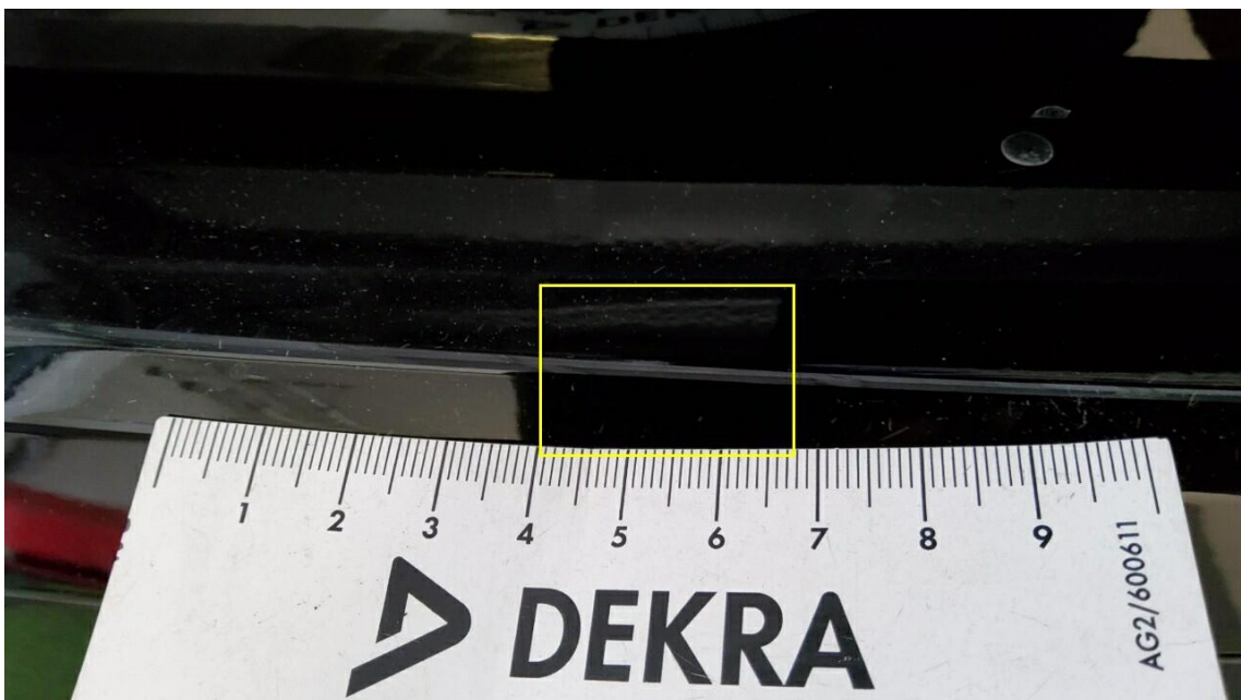
Bild 12 : Stoßfänger hinten Lackierung, verschrammt, Gebrauchsspur
