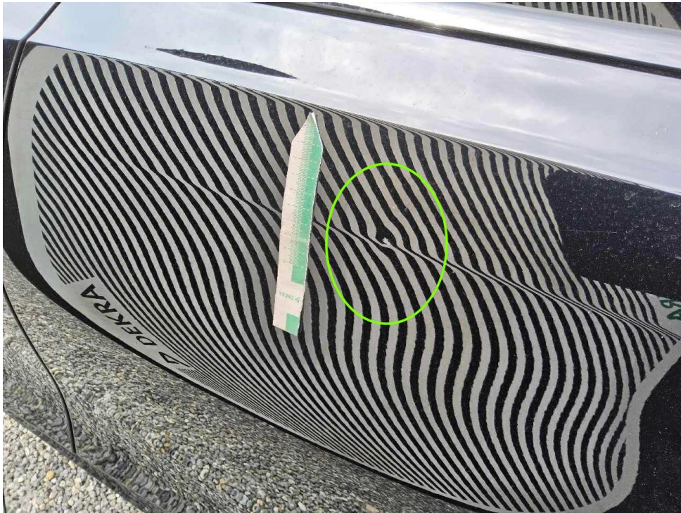
Bild 11 : Tür hinten links, eingedellt
