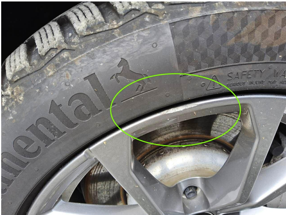
Bild 12 : Alufelge vorne links, verschrammt
