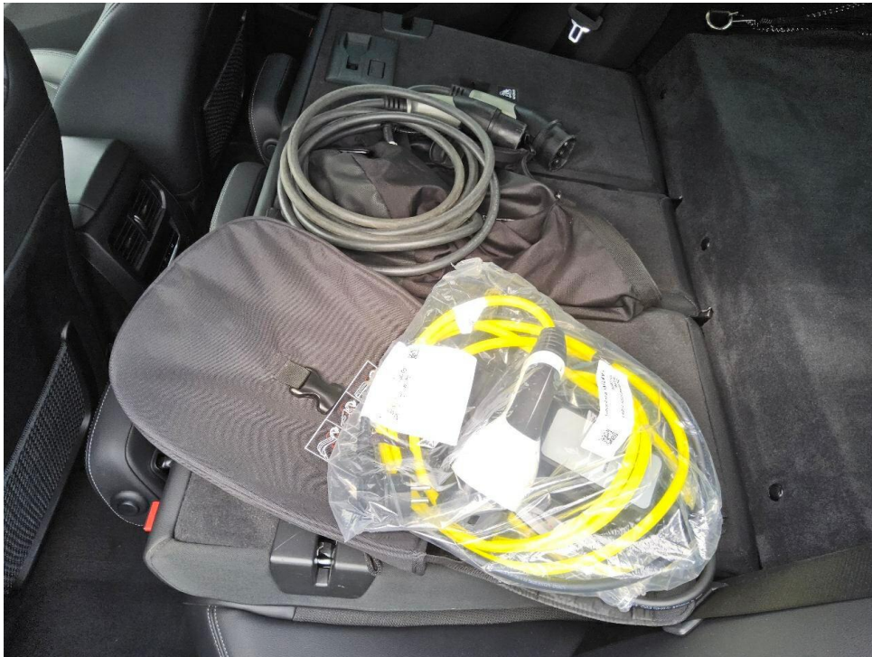
Bild 7 : Ladekabel beim E-Fahrzeug
