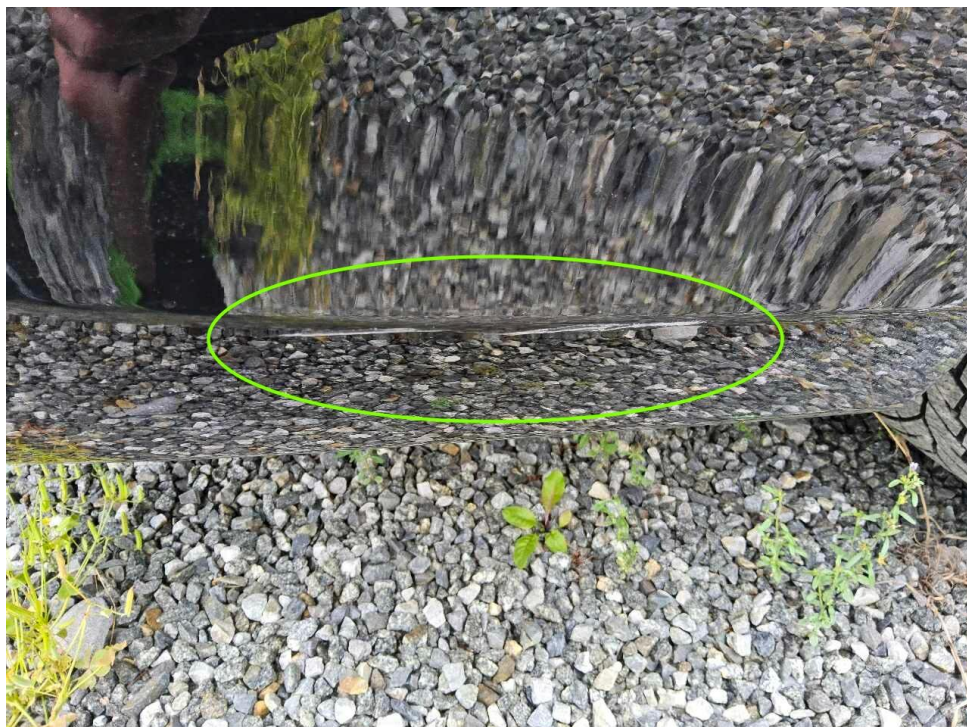
Bild 14 : Stoßfänger hinten, zerkratzt
