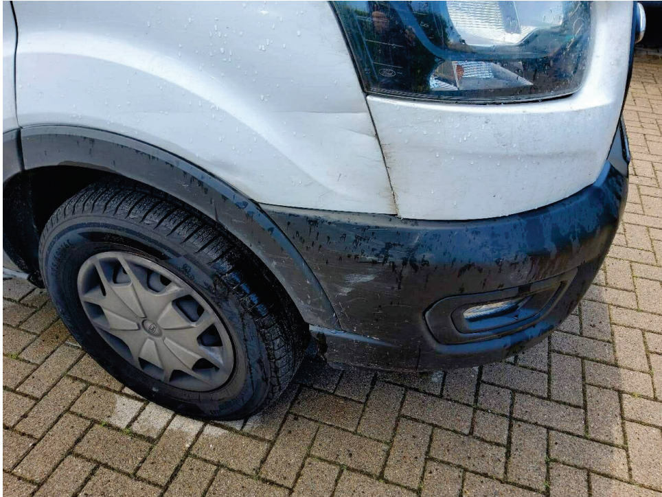
Bild 7 : Unfallschaden vorne rechts (Kotflügel, Stoßfänger, Blende Scheinwerfer)
