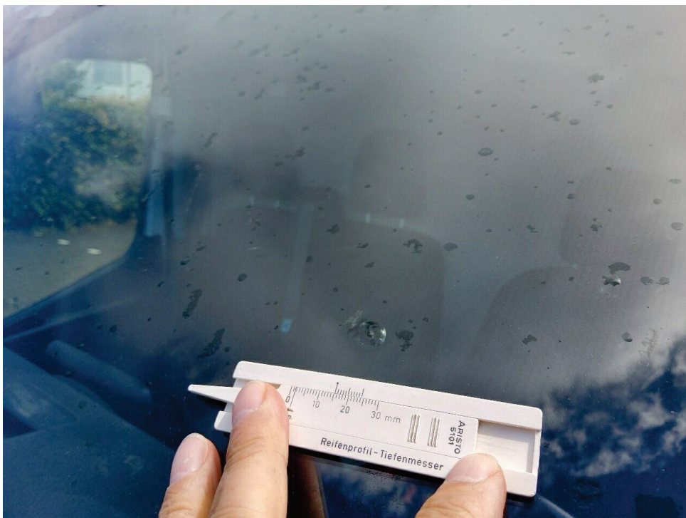
Bild 6 : Frontscheibe, Steinschlag mit Rissbildung
