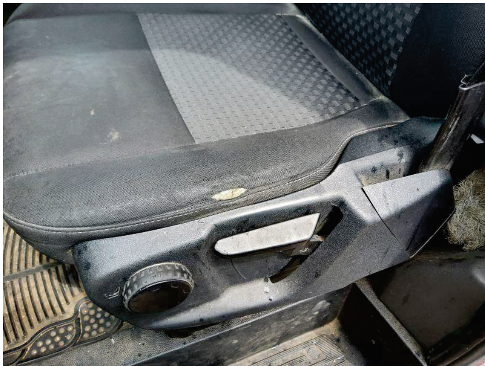
Bild 17 : Innenraum, Sitzbezug Fahrersitz eingerissen Innenraum, Hebel für Sitzhöhenverstellung gebrochen
