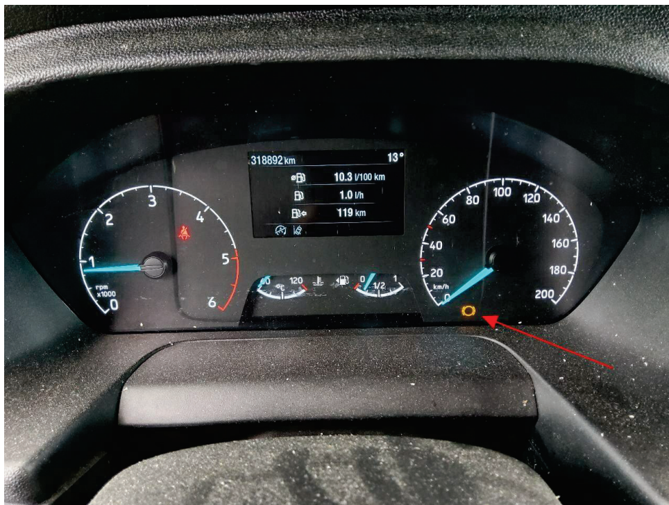
Bild 4 : Kombiinstrument mit Laufleistungsanzeige bei laufendem Motor Bremsanlage, Bremse vorne abgefahren (Verschleißanzeige leuchtet)
