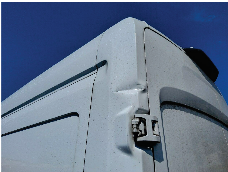
Bild 12 : Eckbeplankung links, eingedrückt/verformt
