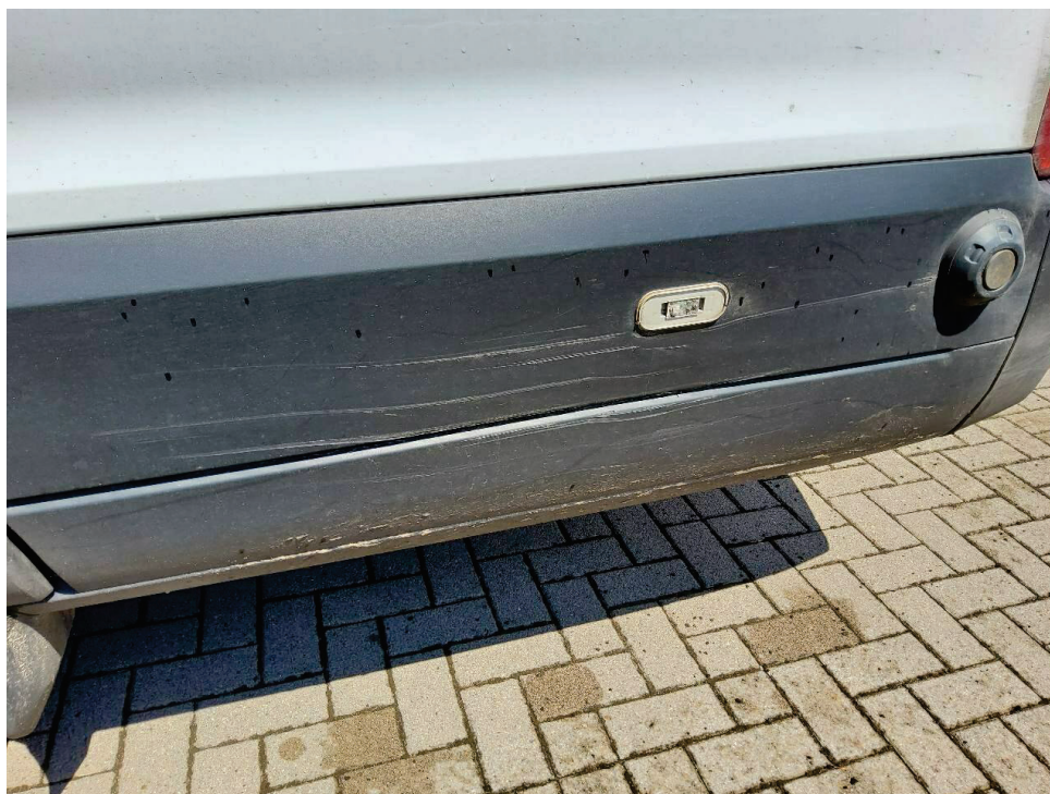
Bild 13 : Seitenwand links, hintere Schutzleiste zerkratzt
